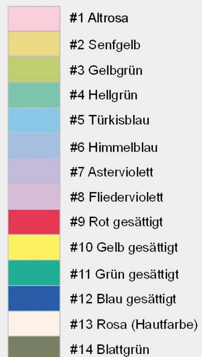
Bild 13: Für jede dieser 14 Normfarben lässt sich ein Farbwiedergabeindex berechnen. Aus den ersten 8 Farben ergibt sich der allgemeine Farbwiedergabeindex als Mittelwert aus den Einzelwerten.
