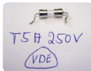
Bild 16: Beim zweiten Versuch entsprach auch die Beschriftung der Sicherung den Forderungen.
