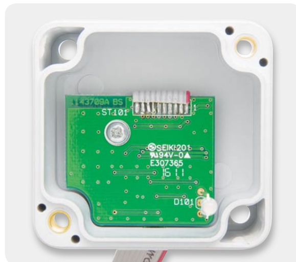
Bild 9: Die im Gehäuse verschraubte Platine
