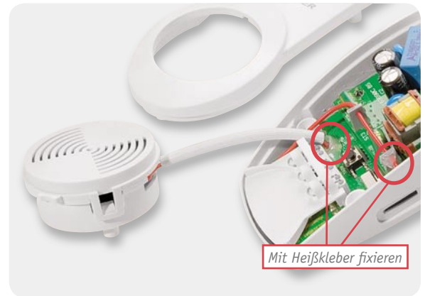
Bild 18: Die mit Gewebeschlauch ummantelten Lautsprecherleitungen und die mit Heißkleber auf der Basisplatte fixierten Leitungen. Links der Lautsprecher in seinem Gehäuse.
