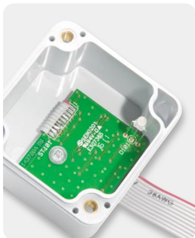
Bild 7: Die eingelegte, hier schon verlötete und nach außen geführte Leitung zum Basisgerät
