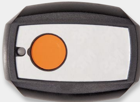
Bild 19: Nachdem die Senderplatine in die vordere Gehäusehälfte geschraubt wurde, kann die doppelseitig klebende Folie so eingeklebt werden, dass Lichtleiter und Tastknopf frei bleiben.
