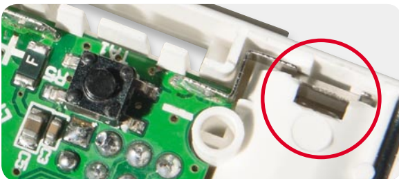
Bild 12: Auch die Batteriekontakte müssen unter den zugehörigen Gehäusenasen einrasten.
