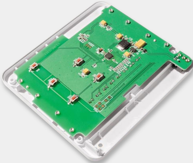
Bild 11: Montage der Leiterplatte im Frontrahmen
