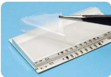
Bild 3: Die Schutzfolie an der Oberseite der Hinterleuchtungsplatine ist abziehen.
