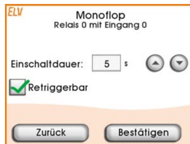
Bild 13: Die Oberflächenseite iomonoflop.xml des retriggerbaren Monoflops
