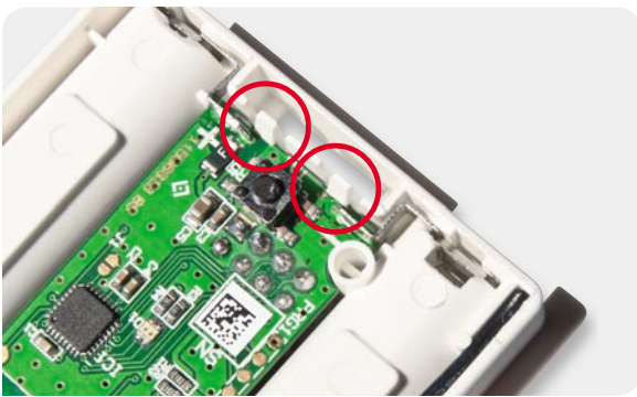
Bild 11: Die Platinenhalterungen müssen einrasten, so dass die Platine fest sitzt.
