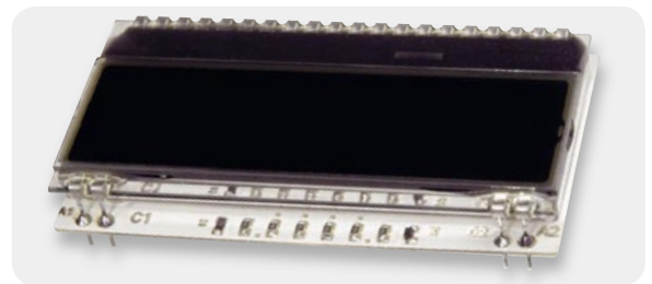
Bild 5: Das Display mit fertig montierter Hinterleuchtungsplatte
