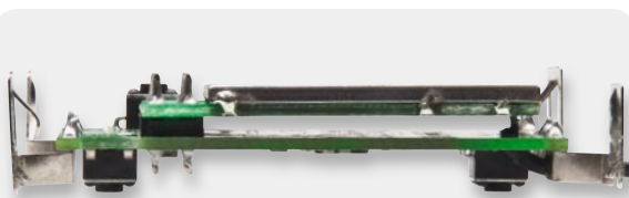
Bild 7: Das Transceiver-Modul liegt auf der ganzen Länge genau parallel zur Platine.
