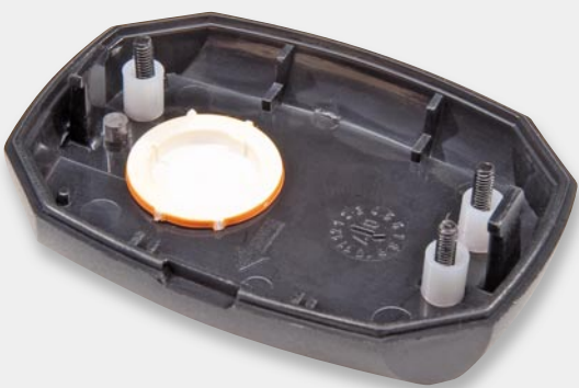
Bild 17: Das Oberteil des Sendergehäuses mit den drei Schrauben, drei Abstandsröllchen und der Tastkappe
