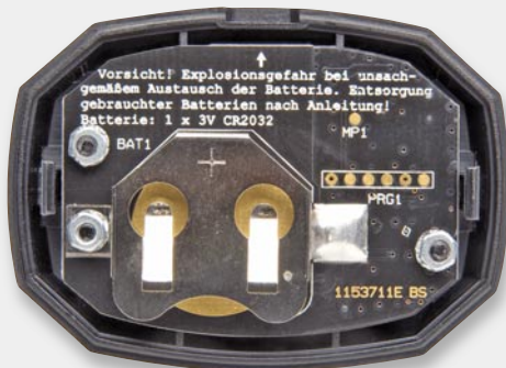
Bild 18: Die fertig montierte Senderplatine
