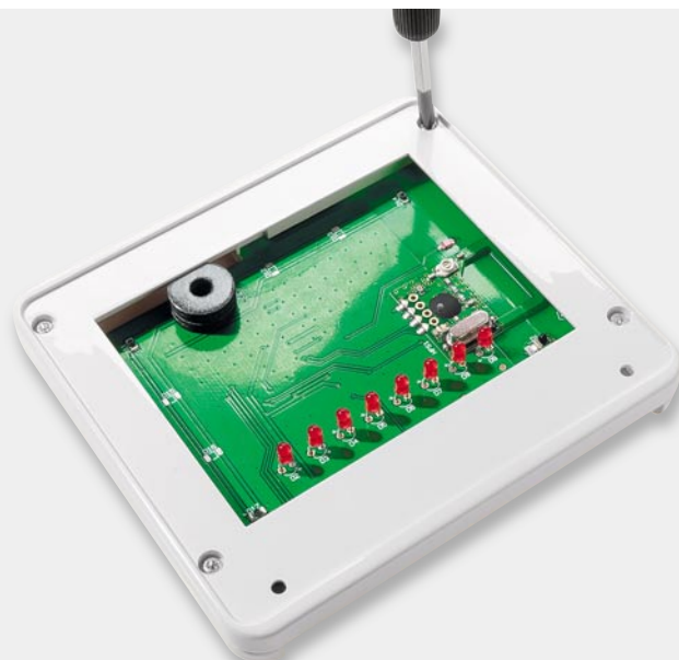
Bild 13: Verschrauben der Gehäuserückwand
