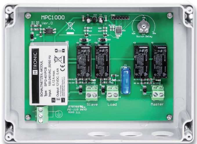
Bild 1: Das Innenleben des MPC1000. Man erkennt deutlich die Funktionsgruppen internes Netzteil (links), Prozessorsteuerung (oben) und die Umschaltrelais für N und L.
