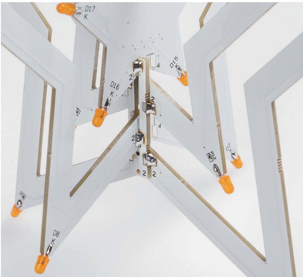
Bild 12: So befinden sich die Sternplatinen in der richtigen Position.
