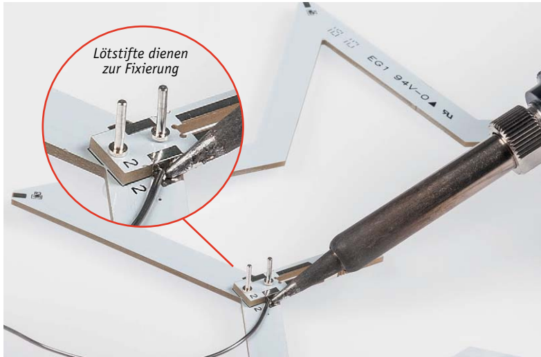
Bild 6: Das Verlöten der unteren Stegplatte Nr. 2 mit dem äußeren Stern
