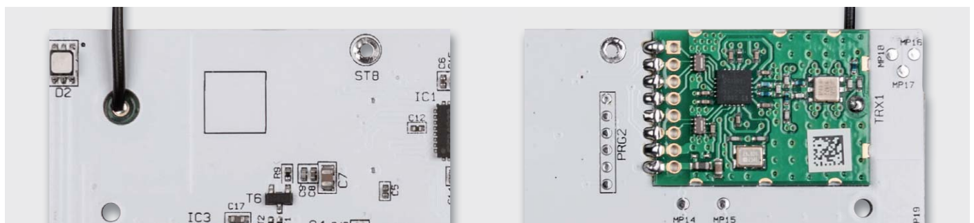
Bild 8: So erfolgt die Bestückung des Funkmoduls, nachdem die Antenne durch das zugehörige Loch in der Basisplatine (links) geführt wurde.
