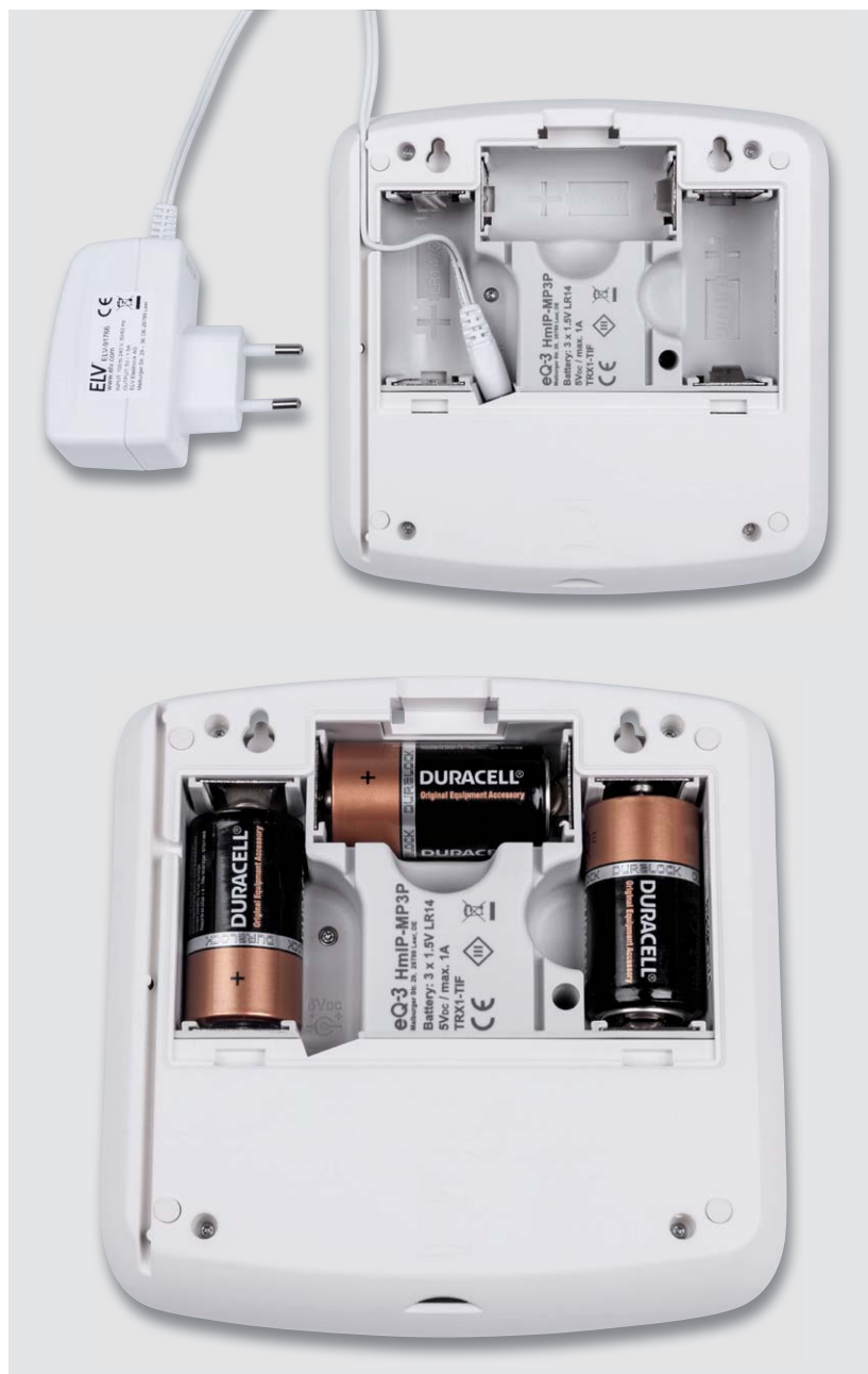
Bild 20: Hier sind die Lage des Steckers und der Zuleitung des Netzteils sowie ein richtig eingelegter Batteriesatz zu sehen.
