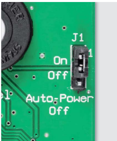
Bild 8: So wird der Auto-Power-off-Jumper J1 bestückt und gesetzt.
