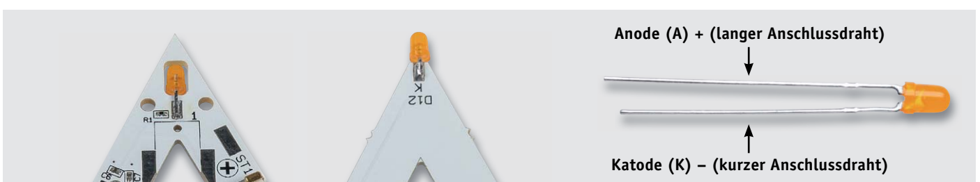
Bild 5: Die Polarität der LEDs ist durch unterschiedliche Anschlussdrähte erkennbar.
