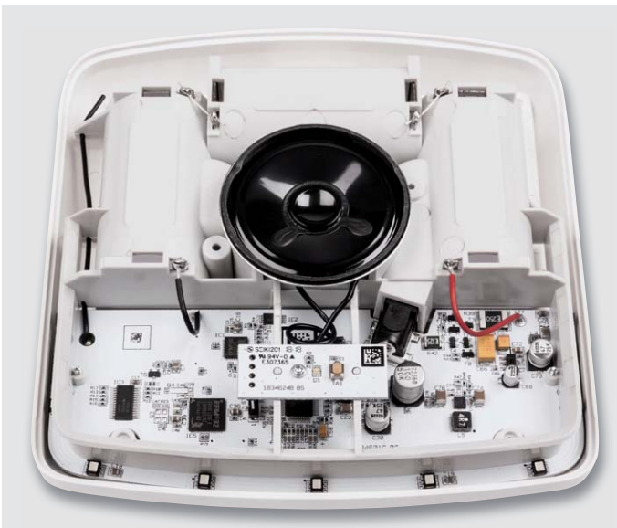
Bild 16: Die Platinenmontage wird mit dem Aufstecken der Tasterplatine komplettiert.
