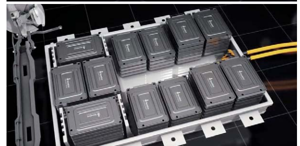
Bild 15: Die Flashbattery von StoreDot basiert auf organischen Halbleitern, kombiniert mit Nanomaterialien. Darunter der erste Fahrzeugakku, der laut StoreDot in fünf Minuten vollgeladen werden kann. Bild: StoreDot
