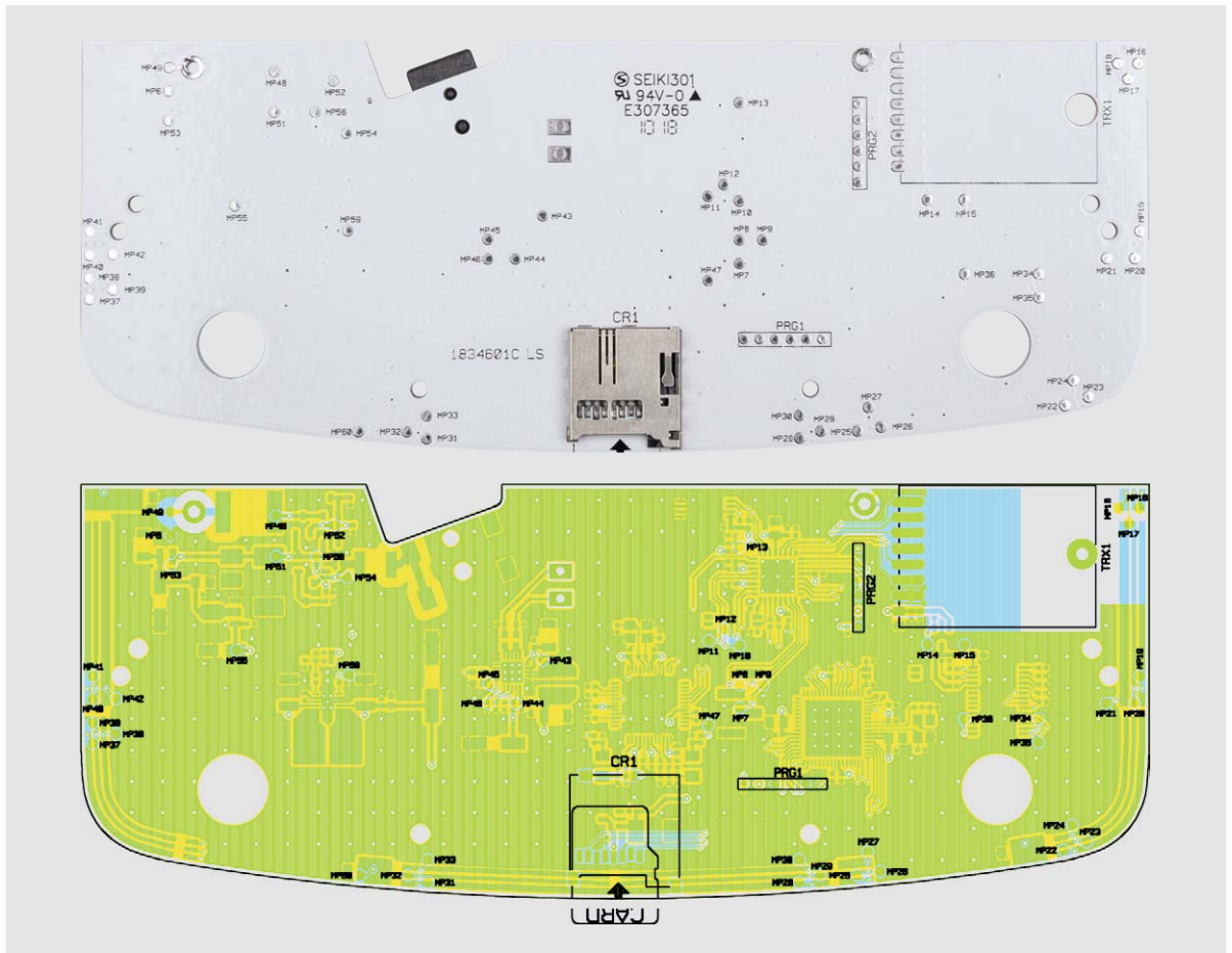
Bild 6b: Platinenfoto der Lötseite der Basisplatine mit zugehörigem Bestückungsplan
