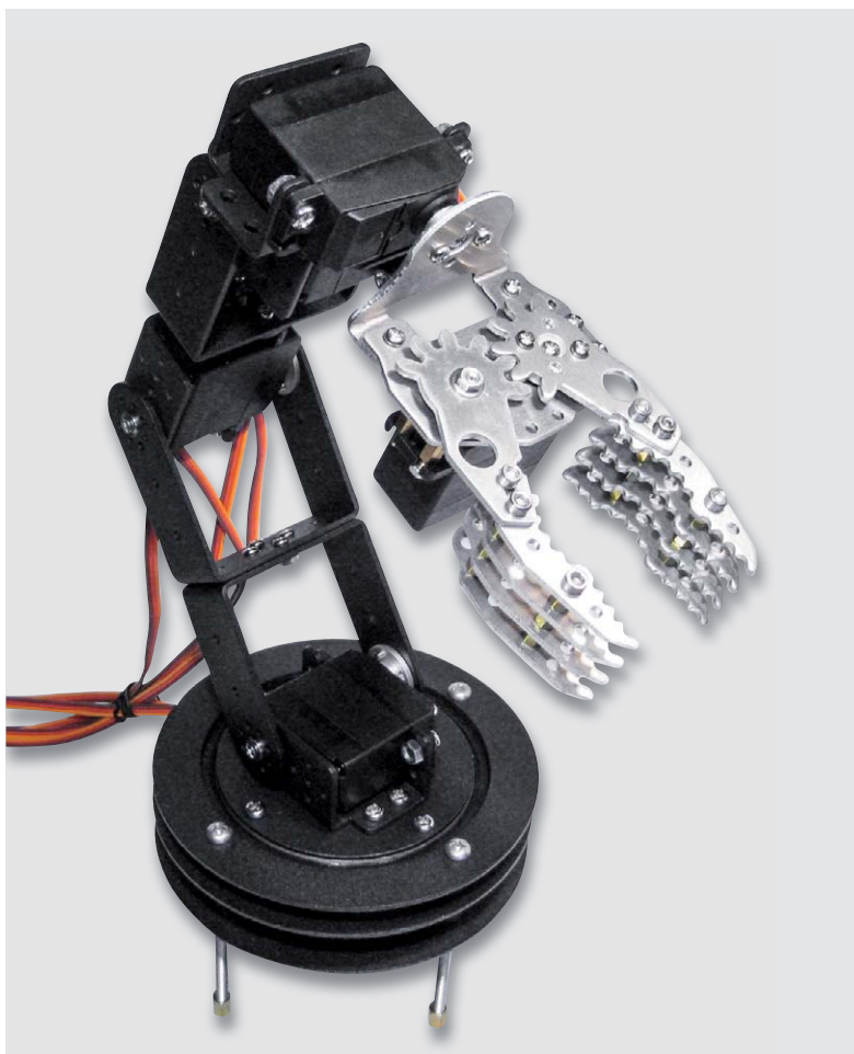
Bild 10: Über sechs Servos gesteuerter Roboterarm
