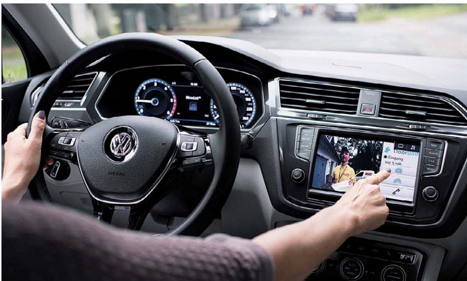
Bild 15: Total vernetzt - die DoorBird-Türsprechanlage D101S kann mit dem VW-Infotainmentsystem (MirrorLink) per VW Connect-App verbunden werden, sodass man hierüber direkt mit Besuchern sprechen kann. Bilder: VW/DoorBird
