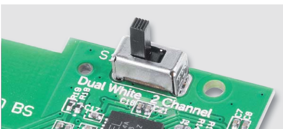
Bild 13: Die Montage des Schalters S1 erfolgt so, wie der Aktor später verwendet werden soll.
