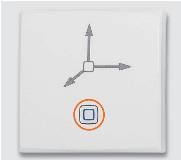
Bild 11: Der Lichtleiter ist bereits fertig an die Gehäuseoberseite montiert.
