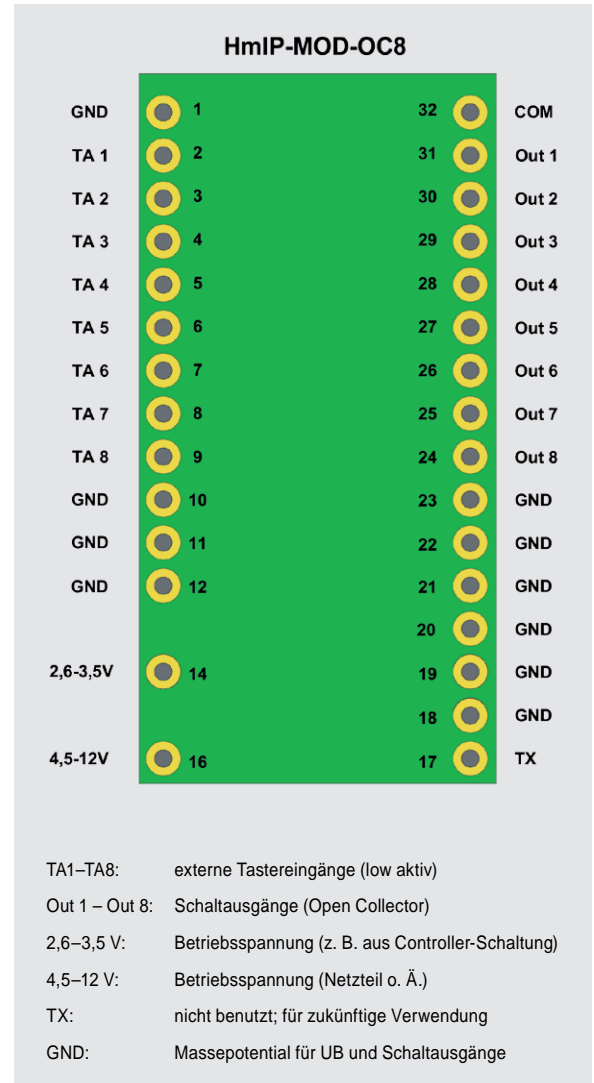
Bild 12: Anschlussbelegung der Stiftleisten
