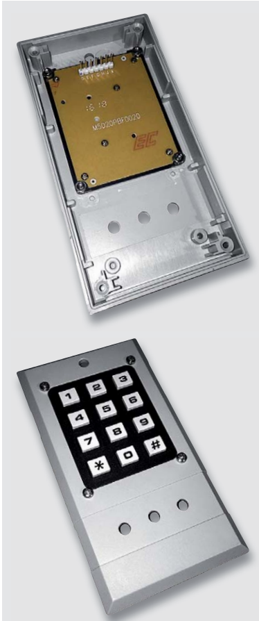
Bild 7: Die Tastaturmatrix wird mit dem bearbeiteten Gehäuse verschraubt.
