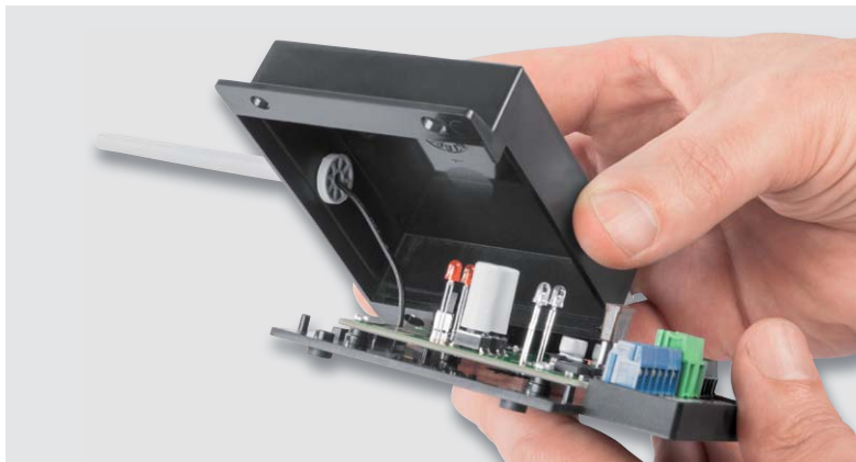
Bild 23: ... der Antennendraht eingeführt wird. Gleichzeitig wird die Gehäuseoberseite aufgesetzt.
