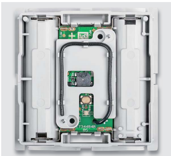
Bild 12: Das Gehäuseunterteil wird auf die Rückseite gelegt und die Platine wie hier gezeigt in das Gehäuseunterteil eingelegt und eingerastet.
