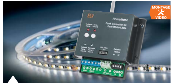
56 Homematic Funk-Controller für Dual-White-LEDs, Teil 2 Komfortabel Lichtfarbe und Helligkeit von Dual-White-LED-Anordnungen steuern
