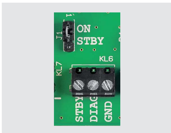
Bild 10: Jumper J1 und die externe Klemme KL6
