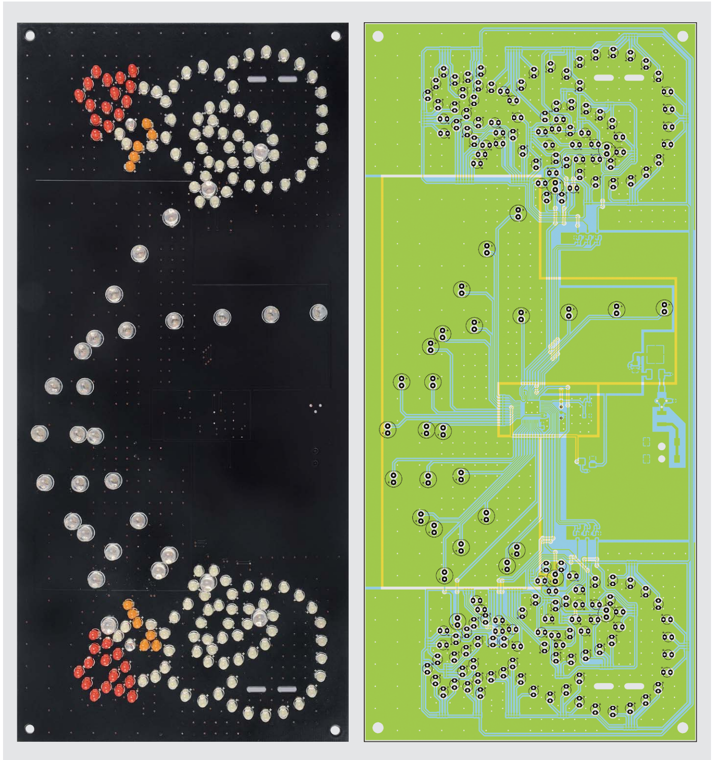
Bild 2a: Platinfoto der fertig bestückten Platine mit zugehörigem Bestückungsplan, hier die Bestückungsseite (Darstellung 72 % der Originalgröße)
