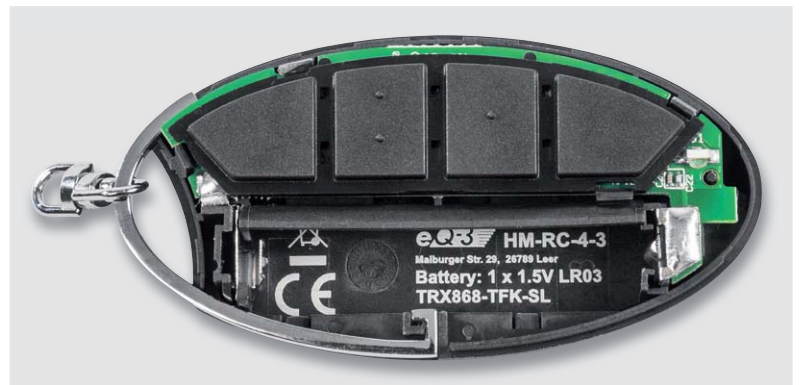
Bild 14: Die exakt eingelegte Tastaturmatte liegt ringsum bündig auf der Platine auf.
