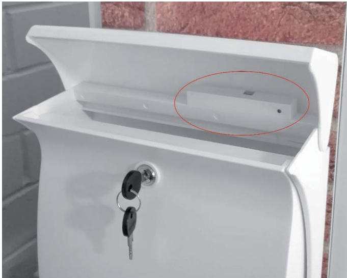
Bild 1: Anbringung des optischen Homematic Funk-Tür-/Fensterkontakts im Briefkasten
