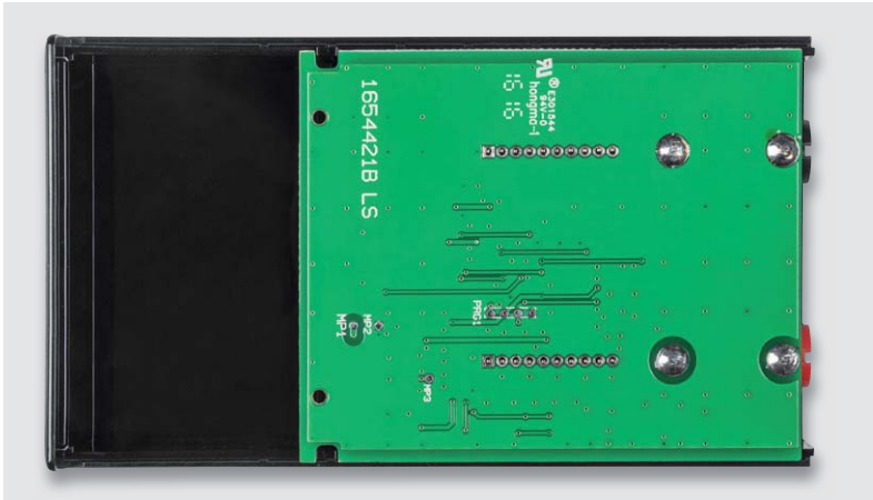
Bild 13: Nach dem Einlegen der Basisplatine mit aufgesteckter Displayplatine müssen die Anschlüsse der Stiftleiste gleichmäßig in der Basisplatine stehen.
