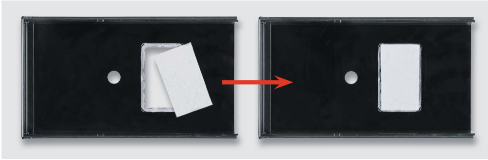
Bild 12: Ein kleines Stück Pappe (siehe Text) hilft, den richtigen Abstand des Displays zum Displayfenster einzuhalten.
