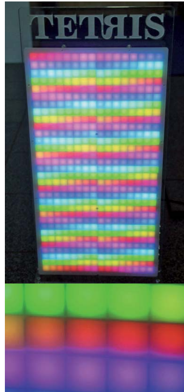
Bild 9: Das Testprogramm läuft – hier kann man die Wirkung des Wabengitters und der Streuscheibe bereits gut erkennen.
