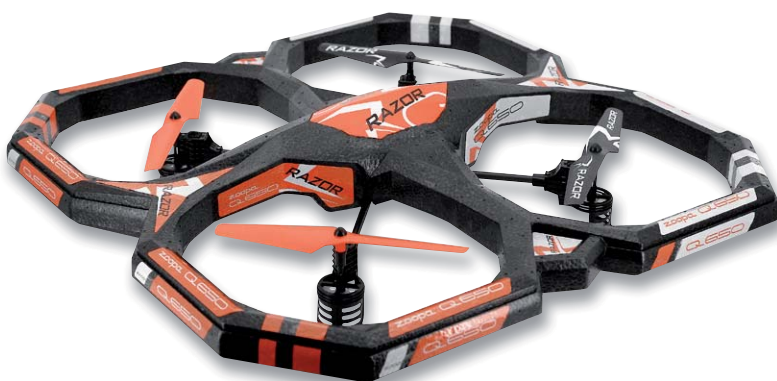
Bild 7: Sicher geschützt – die Tragschrauben des ACME zoopa Q650 Razor sind crashsicher geschützt und können so auch selbst bei einer Kollision keinen Schaden anrichten. Bild: ACME
