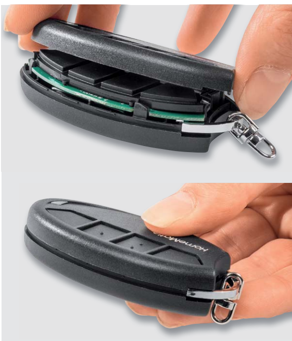
Bild 15: Zum Zusammensetzen der Gehäusenhälften ist zunächst die Gehäuseoberschale von der Batterieseite her seitlich einzusetzen (oben), danach drückt man beide Gehäuseshalen bis zum Einrasten zusammen.
