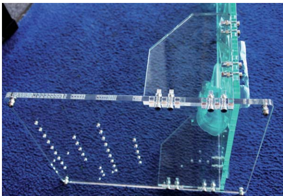
Bild 3: So werden Displayplatte und Standfuß stabil miteinander verbunden.
