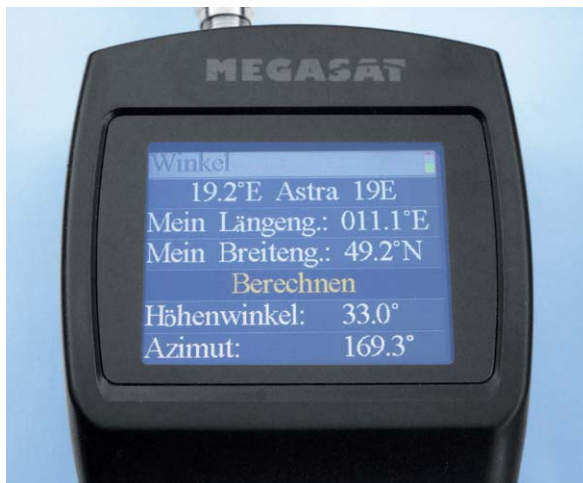
Bild 2: Winkelberechnung des Satelliten aus Orbitalposition und eigenem Standort
