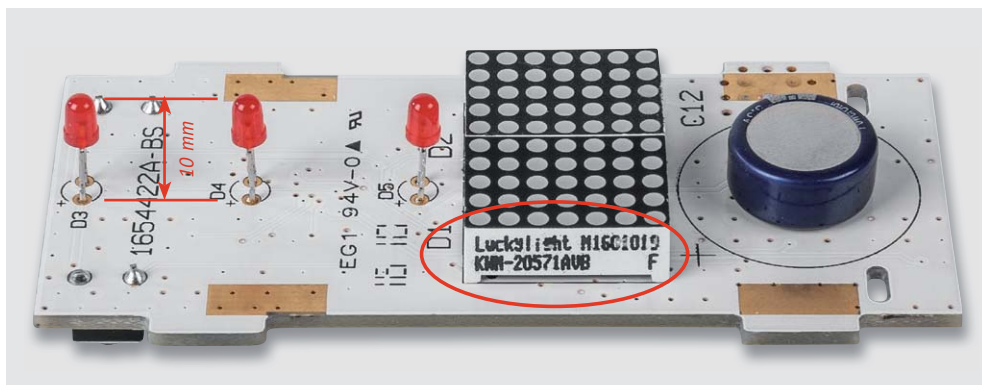
Bild 6: Hier erkennt man die Einbauhöhe der LEDs, deren Spitzen 10 mm über der Platine liegen müssen, und der LED-Matrix-Anzeigen, die man anhand des seitlichen Aufdrucks wie hier gezeigt einsetzt.
