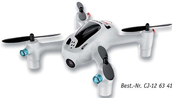
Bild 18: 80 x 80 mm, ganze 57 g leicht, aber sogar ein HD-Kamera-system mit Videolink integriert – der ELV FPV X4 Plus
