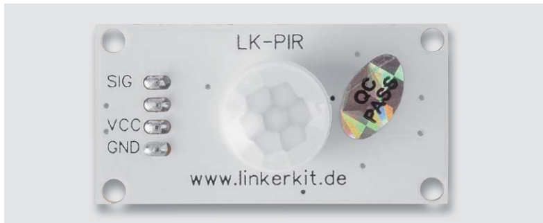
Bild 11: Sehr praktisch: Die 5-V-, Out- und GND-Anschlüsse können direkt an der Pin-Leiste des Raspberry Pi oder über ein Linker-Kit-Baseboard (CJ-12 21 37) angeschlossen werden.
