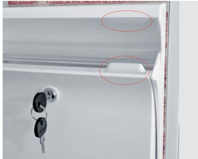
Bild 2: Anbringung eines Reed-Kontakts und des auslösenden Magneten im Briefkasten
