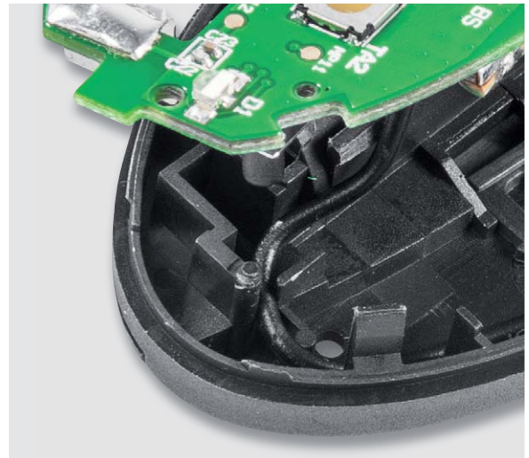
Bild 10: ... folgt das Einlegen der Platine, wobei nochmals auf die korrekte Antennenführung im Tasterbereich zu achten ist ...
