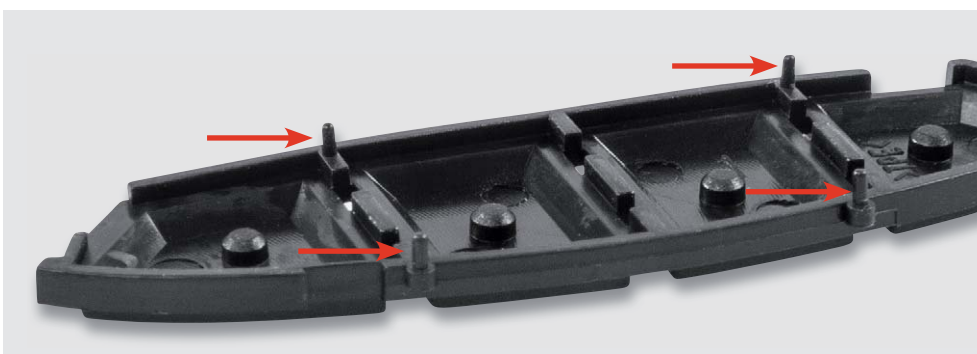
Bild 12: Hier sind die Führungsstifte der Tastenmatte gut zu sehen.
