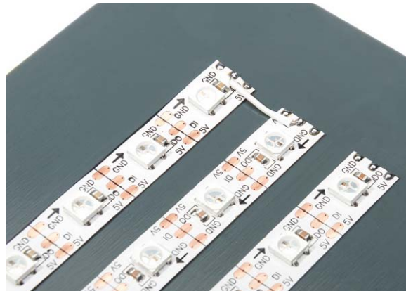
Bild 11: Die Verbindung der Datenleitungen
