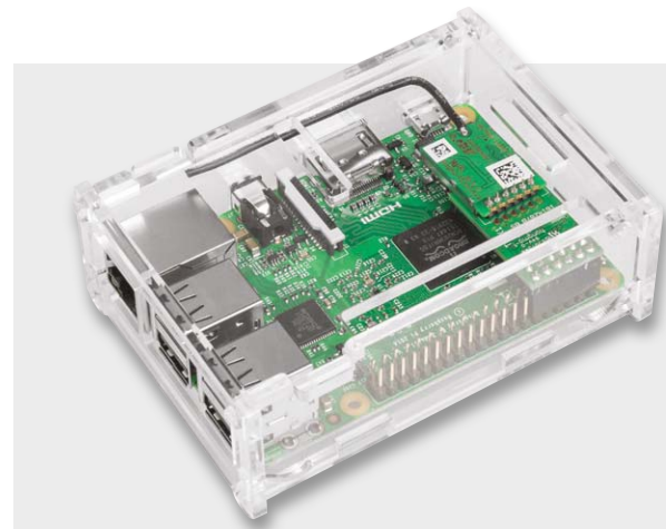
Bild 9: Die fertige Kombination aus Raspberry Pi und Funkmodul sollte in ein passendes Gehäuse eingebaut werden.
