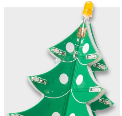
Bild 13: So wird die Top-LED auf der Spitze des Weihnachtsbaums angelötet. Wichtig! Beide Platinen müssen so zusammengefügt werden, dass K-K und A-A aneinander liegen!
