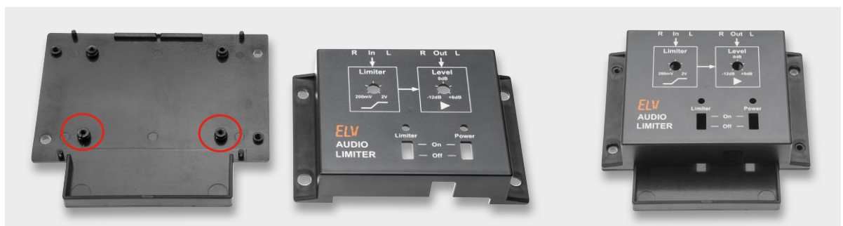
Bild 6: Das zweiteilige Gehäuse des Audio-Limiters. Links sind die Schraubdomen für die Platinenbefestigung markiert.
