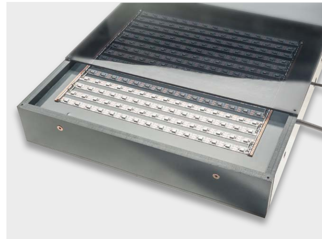
Bild 14: LED-Matrix mit erkennbarer Frontplatte
