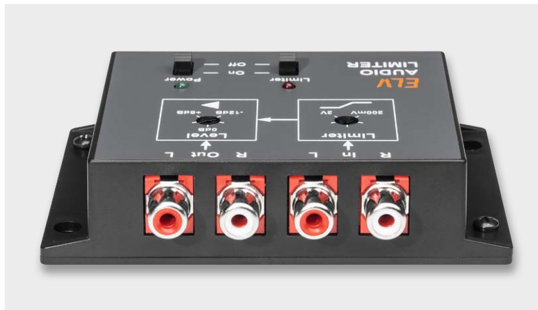
Bild 7: Der komplett montierte Audio-Limiter, hier der Blick auf die Anschlussbuchsen
