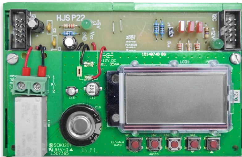
Bild 5: Das fertig aufgebaute WTMA1-Modul mit bestückter Wochenzeitschaltuhr
