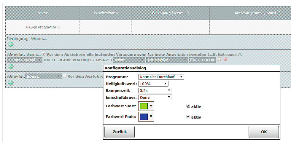
Bild 2: Der Zentralenbefehl für den Automatikkanal
