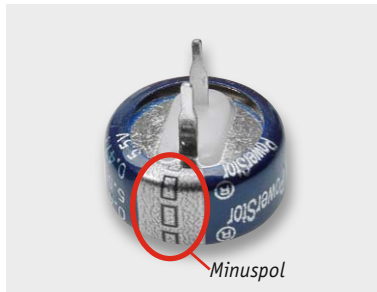
Bild 7: Am Gold-Cap ist der Minuspol gekennzeichnet.
