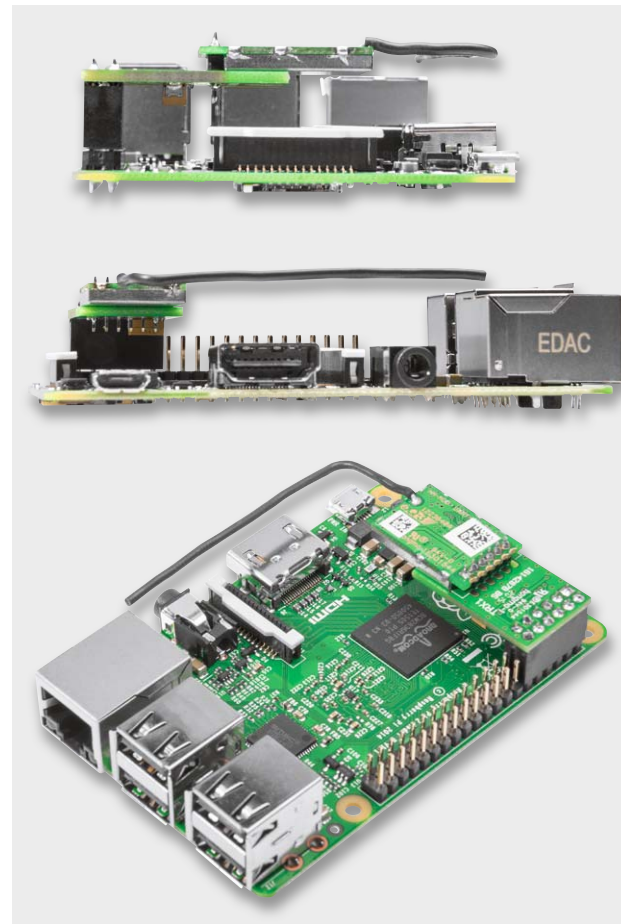
Bild 8: Verlegung der Antenne
