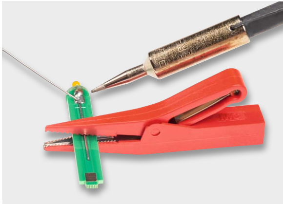
Bild 9: Ein nützlicher Helfer ist eine kleine Krokodilklemme, mit der die Platinen fixiert werden können.
