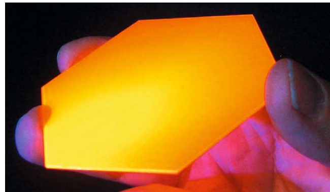
Bild 9: Quantenpunkte in einer Glasplatte beginnen bei Bestrahlung mit UV-Licht gelb zu fluoreszieren. (Quelle: QD-Vision)
