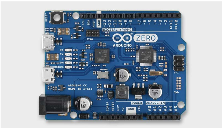
Bild 7: Erstes 32-Bit-Arduino-Original, der Arduino Zero. Bild: arduino.cc
