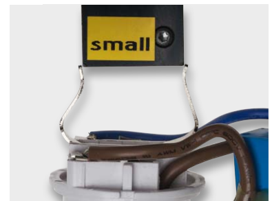
Bild 14: Abstand unter der Norm – die PE-Kontakte liegen zu dicht zusammen und sind leicht einseitig verbogen.
