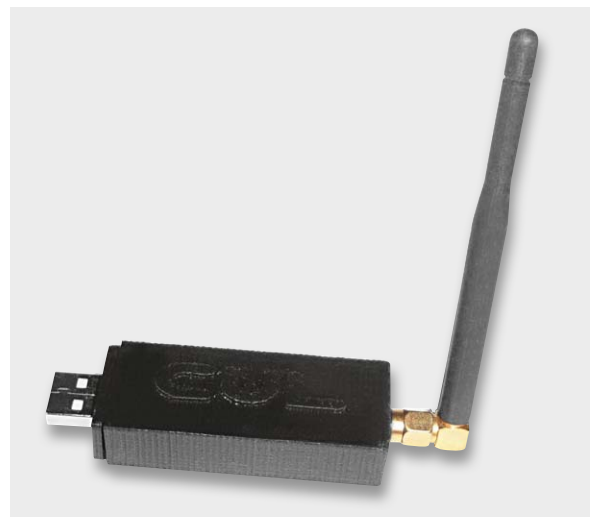
Bild 14: Der Datenempfang für CUX-Daemon erfolgt über einen speziell konfigurierbaren USB-Stick, hier im selbst gedruckten Gehäuse.
