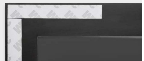
Bild 23: Die Klebestreifen zur Befestigung der Frontplatte
