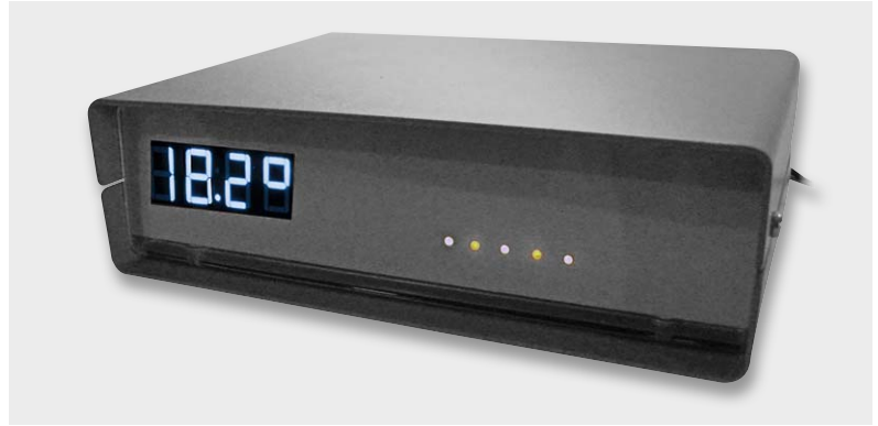
Bild 5: Im Eigenbau erstelltes µC-basiertes Computer-Thermometer mit Übertemperaturalarm und 5 Alarmausgängen zur Überwachung von Serverräumen
