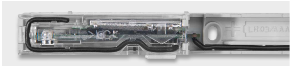
Bild 6: Die Funkantenne ist in die hierfür vorgesehene Aussparung zu legen.
