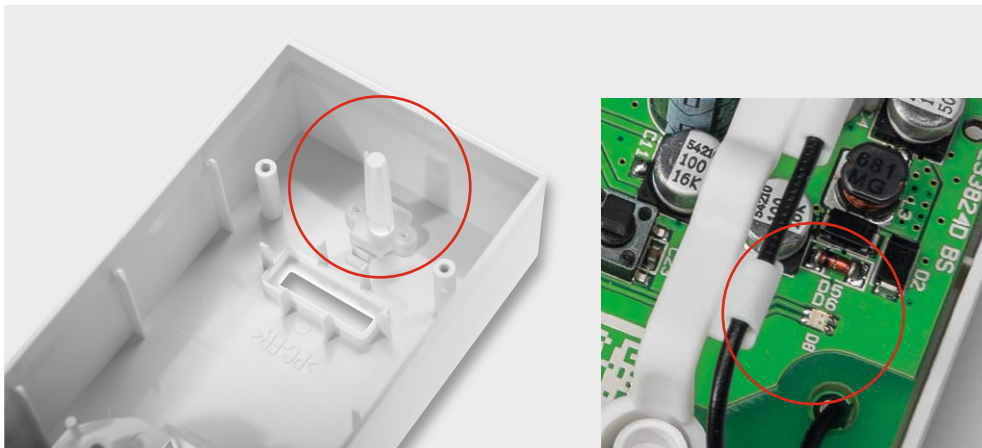
Bild 2: Sicherer Abstand – die LED sitzt direkt auf der Platine, das Licht wird über einen genügend langen Lichtleiter herausgeführt: Konstruktion eines ELV-Geräts
