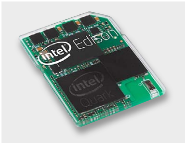
Bild 20: Intel-Linux-Winzling im SD-Kartenformat – der Edison. Bild: Intel
