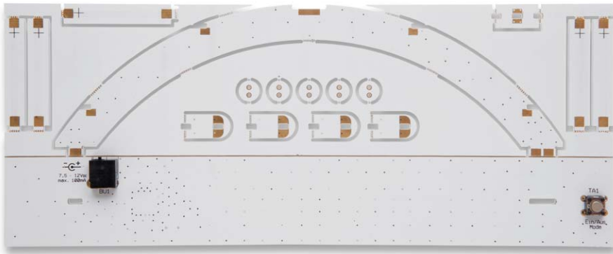
Bild 2: Die (herausbrechbaren) Platinen werden auf einem „Nutzen“ geliefert.
