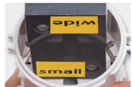
Bild 18: Nicht nachgebessert: PE-Kontakte immer noch nicht auf Normabstand, aber nicht mehr verbogen
