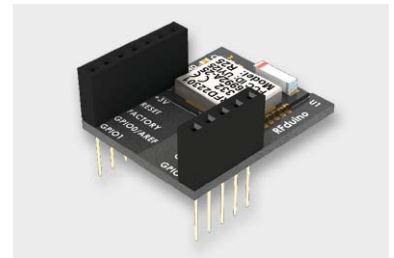
Bild 2: Nur fingernagelgroß – ein abgespeckter Arduino mit Bluetooth on Board – das RFduino-System ist eines der kleinsten Arduino-kompatiblen Systeme. Bild: RFduino
