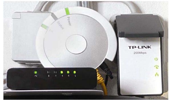
Bild 4: Raus aus dem Funkloch – der LAN-Konfigurationsadapter dient hier als Funk-Gateway für die Schaltaktoren, er ist per dLAN mit der CCU verbunden.
