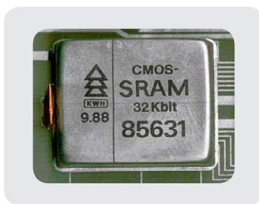
Bild 20: Auch auf dem Gebiet der Speicherschaltkreise war das KWH aktiv, hier ein 32-Kbit-CMOS-SRAM.
