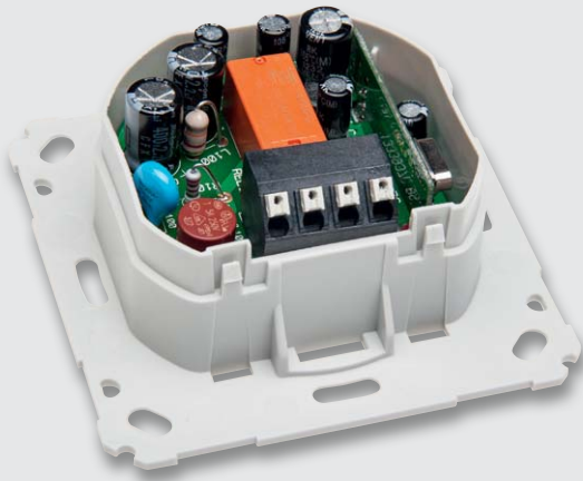
Bild 23: Einsetzen der Netzteilplatine auf die Isolierplatte
