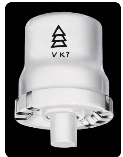
Bild 14: Technologische Sensation 1939 – die vollkeramische Empfängerröhre
