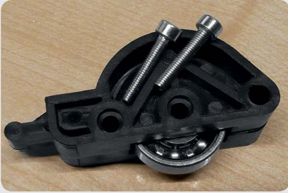
Bild 7: Filament-Führung – zu kurze Schrauben
