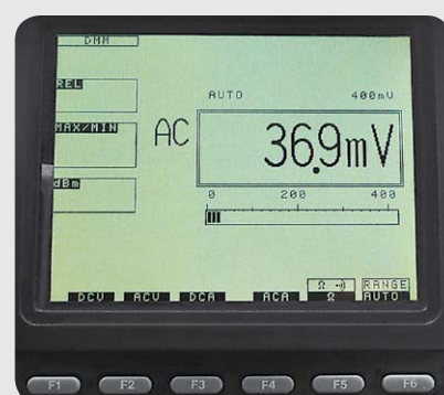
Bild 1: Restwelligkeit bei voller Ausgangsleistung, ein guter Wert
