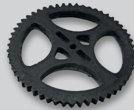
Bild 19: Das Zahnrad weist beim ersten Versuch noch größere Strukturen auf. Hier der Blick auf die Unterseite. Ein kleiner Grat ist im ersten Layer bei größeren Objekten nicht zu vermeiden und kann anschließend nachbearbeitet werden.
