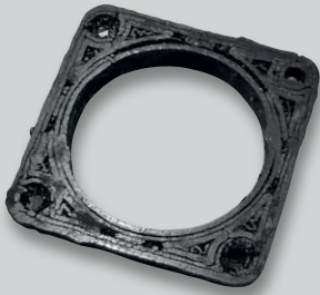
Bild 17: Hier fehlt Substanz – unregelmäßiger Auftrag durch fehlenden ersten Layer.
