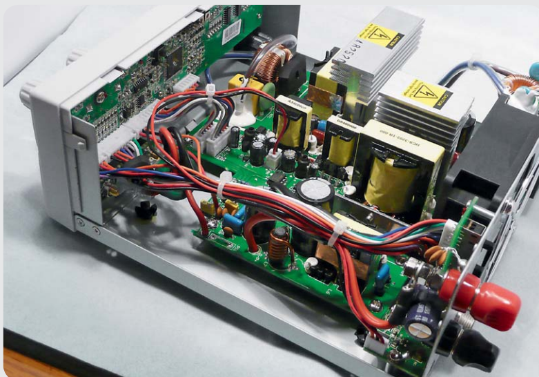
Bild 4: Sauberer Aufbau auf 5 Platinen, mit Steckverbindern verkabelt
