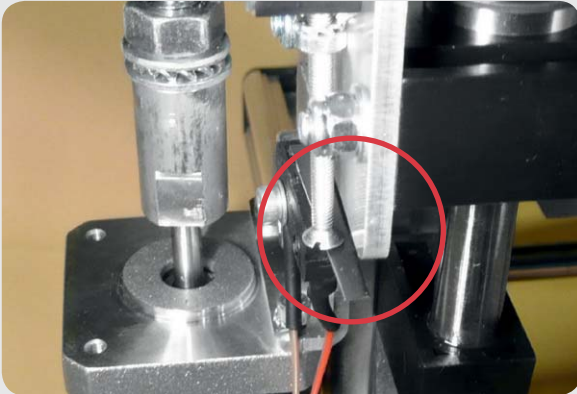
Bild 9: Zu enge Montage des Endschalters der Z-Achse kann zu Fehlfunktionen führen.
