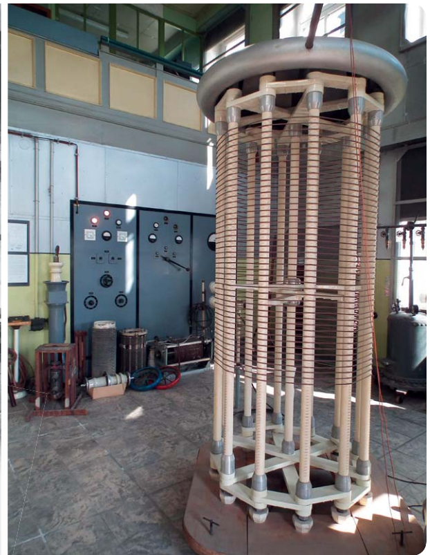
Bild 10: 40-kW-Großmesssender, gemeinsam mit Rohde & Schwarz erbaut, links 1941, rechts heutiger Zustand in den Räumen der Technischen Sammlungen Hermsdorf
