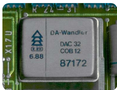
Bild 19: Spezialschaltkreise wie der Hybrid-DA-Wandler DAC32 waren eine Stärke der Mikroelektroniksparte.
