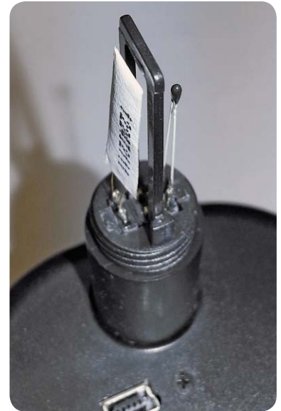
Bild 22: Im Fühlergehäuse des CP11 sind ein kapazitiver Polymer-Feuchtesensor (links) und ein Thermistor (rechts) zur Temperaturmessung untergebracht.
