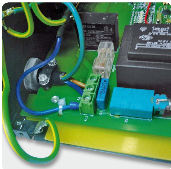
Bild 20: Anschluss und Befestigung des Netzkabels. Hier sind auch der Anschluss und die Fixierung des zu den Kaltgerätebuchsen führenden N-Leiters zu sehen.
