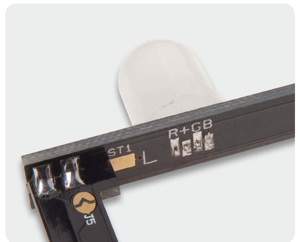
Bild 17: Die zu verlötenden Kontaktpunkte, zusätzlich kann man die mit „L“ gekennzeichnete Ende der LED-Trägerplatine sehen. ST1 wird für das Anlöten der Anodenplatine verwendet.
