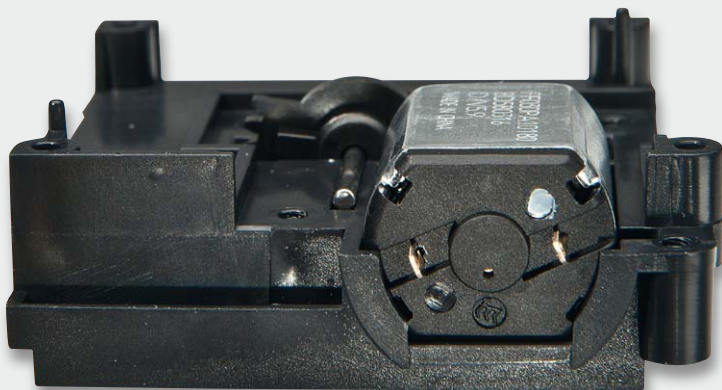
Bild 3: So erfolgt das Einlegen von Motor samt Achse und Zahnrad in den Trägerrahmen.
