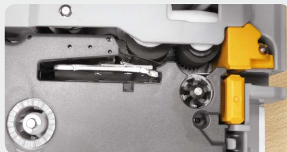
Bild 4: Die Anordnung des Druckkopfs für den Hinterband-Druck
