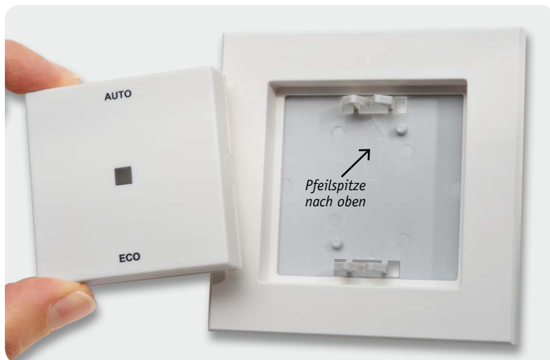
Bild 8: Zusammenbau von Eco-Taster, Rahmen und Montageplatte
