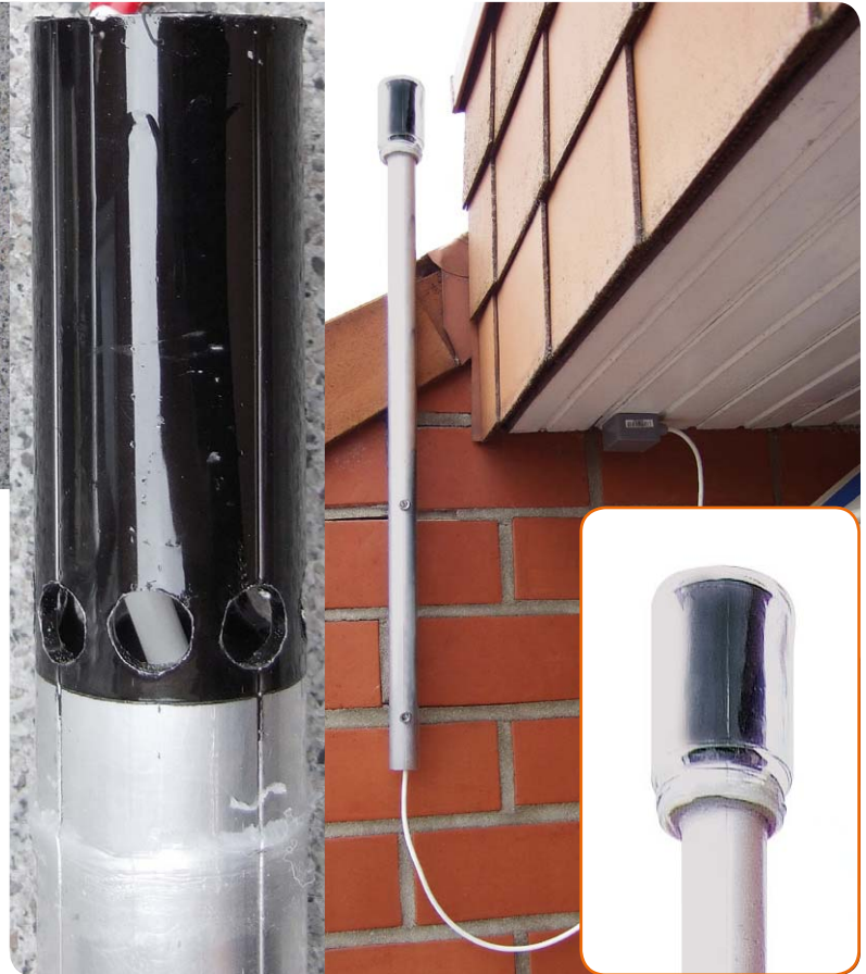
Bild 7: Der selbst gebaute Sonnensensor, links mit allen benötigten Teilen inkl. HomeMatic-Funk-Tempersensor HM-WDS30-T-0, in der Mitte Details zur Gehäuseausführung, rechts in Betrieb mit aufgesetztem Glasbehälter
