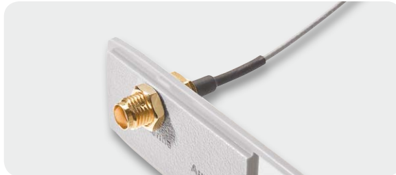
Bild 11: Montage von Antennenbuchse und Antennenkabel am Gehäuse-Seitenteil
