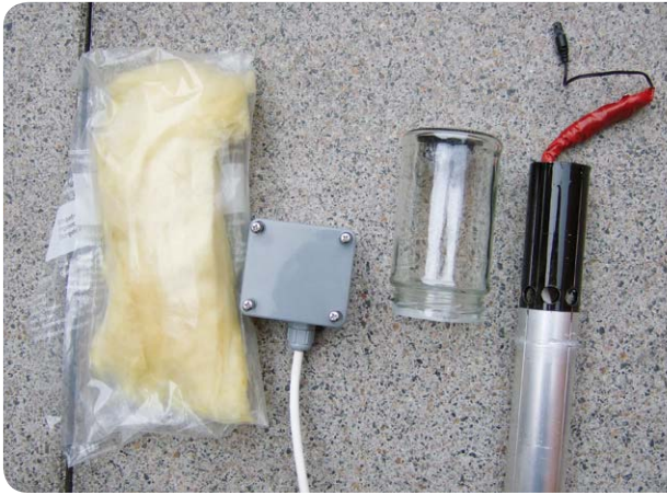
Bild 7: Der selbst gebaute Sonnensensor, links mit allen benötigten Teilen inkl. HomeMatic-Funk-Tempersensor HM-WDS30-T-0, in der Mitte Details zur Gehäuseausführung, rechts in Betrieb mit aufgesetztem Glasbehälter
