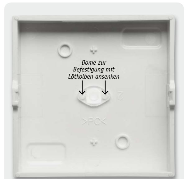
Bild 6: Befestigung des Lichtleiters
