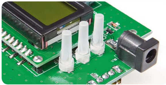
Bild 9: Die 3 mit Klebstoff fixierten Lichtleiter
