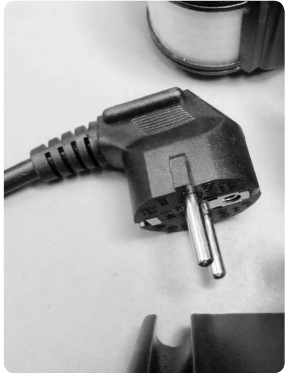
Bild 2: Statt regulärer Anschlussbox ist ein Netzkabel angebracht.
