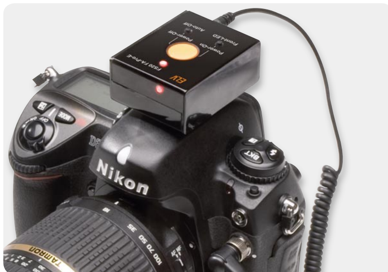
Bild 4: Optische Rückmeldung am Empfänger über die oben angeordnete zweifarbige Statusanzeige und die zuschaltbare sehr helle rote Frontanzeige
