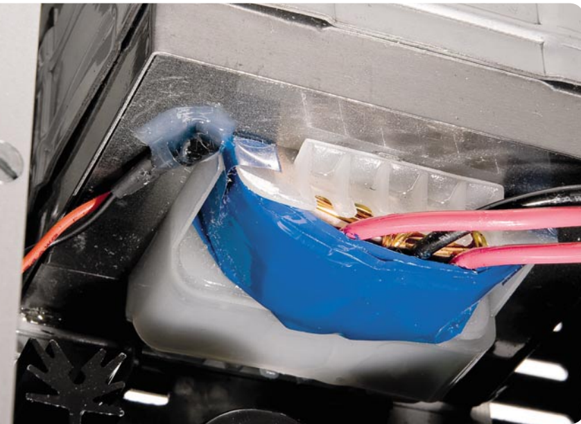
Bild 20: Montage des Temperatursensors am Netztrafo
