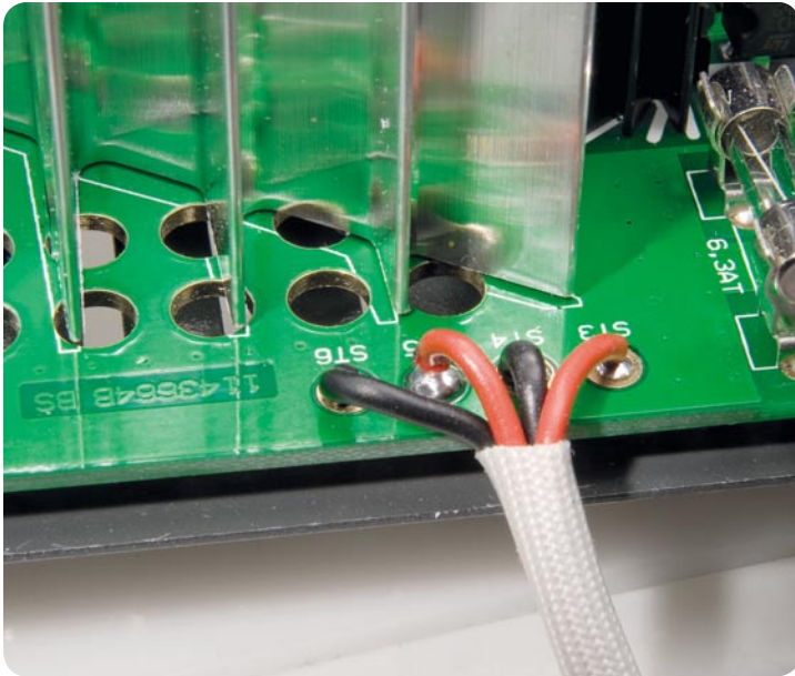
Bild 21: Anschluss der Lautsprecher-Ausgangsleitungen an die Platine
