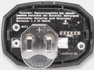
Bild 6: Einlegen der Batterien beim Empfänger (oben) und beim Sender (unten)
