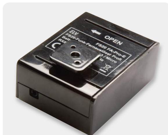
Bild 8: Der Gehäusefuß des Empfängers erlaubt dessen Montage direkt auf den Zubehörschuh einer Kamera oder an einem Befestigungsarm am Stativ.
