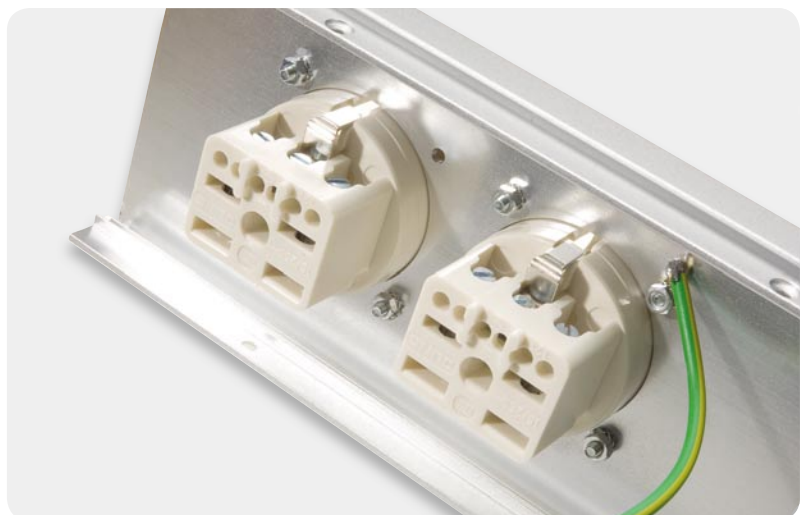
Bild 10: Montage der PE-Leitung und der beiden Steckdosen am Frontprofil
