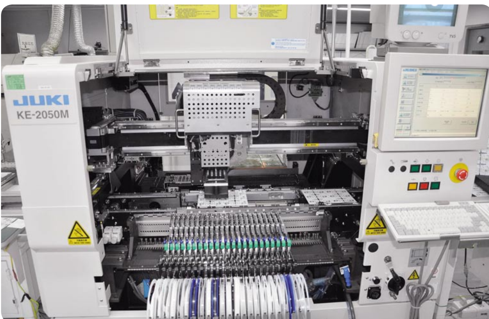
Bild 6: Automatische Leiterplattenbestückung mit Standardbauelementen
