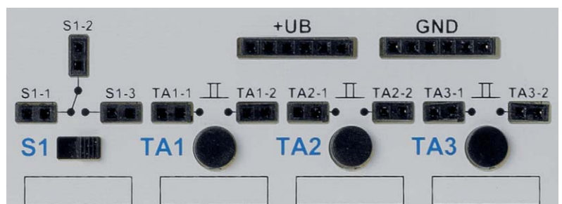
Bild 10: Die verfügbaren Schalter und Taster mit Anschlussbelegung
