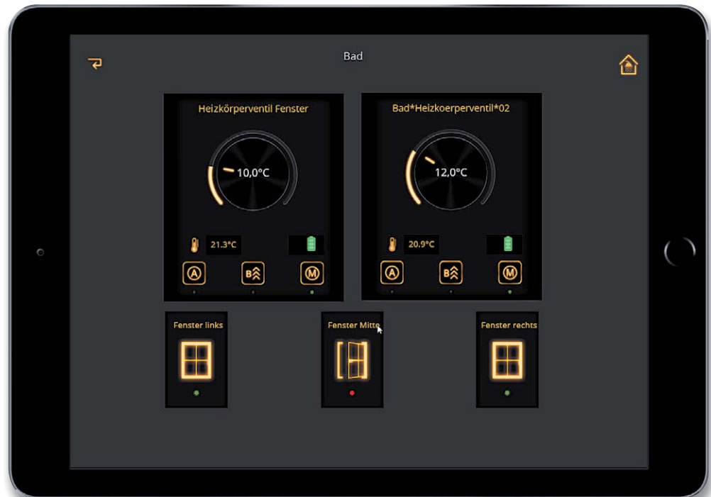
Bild 11: Beispielseite für zwei Heizkörperventile und drei Fenster
