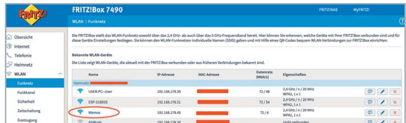
Bild 10: Wenn man dem ESP8266 nicht schon im ESP Easy Flasher eine feste IP zugeordnet hat, findet man die IP z. B. in der WLAN-Verwaltung des Routers.
