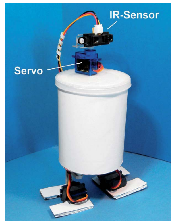
Bild 8: Walkbot mit zusätzlichem IR-Abstandssensor
