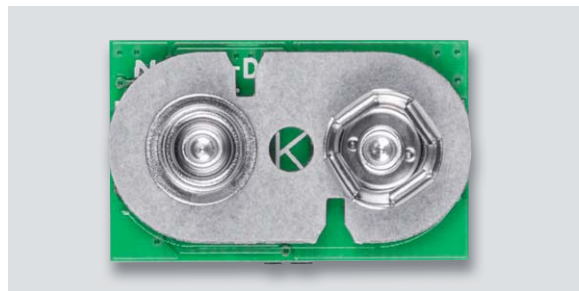
Bild 14: Von der Platinenunterseite eingesetzter Druckknopf-Anschluss. Die Verlötung erfolgt auf der Platinenoberseite.
