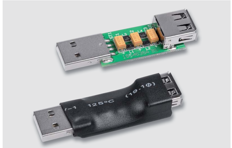
Bild 4: Das USB-EF1 vor und nach dem Einschrumpfen
