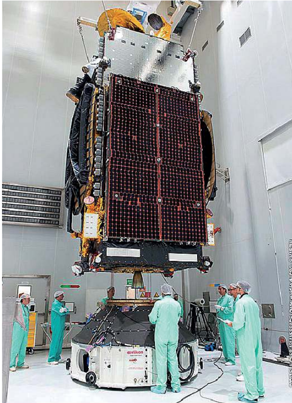
Bild 2: Der S-Band EAN/Hellas Sat 3 kurz vor der Fertigstellung. Deutlich sind die zusammengefalteten Solarpanels zu erkennen, die im Betrieb mit 37 m Spannweite knapp 13 kW elektrische Leistung erzeugen.
