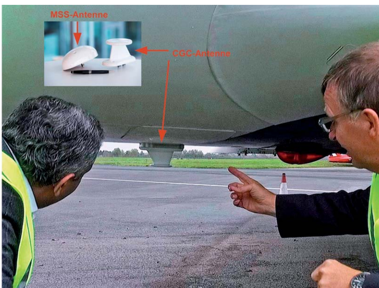
Bild 14: Kompaktheit und ein kleiner Strömungswiderstand zeichnen die EAN-Antennen am Flugzeugrumpf aus.
