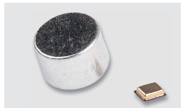
Bild 5: Direkter Vergleich zwischen einem Elektret- (links) und einem MEMS-Mikrofon (rechts)
