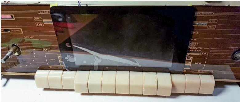
Bild 6: Das Skalenglas wurde unten mit einem passenden U-Profil aus Messing fixiert und zwischen Glas und Blech zusätzlich etwas Schaumstoff eingebracht, damit es sicher und fest sitzt.
