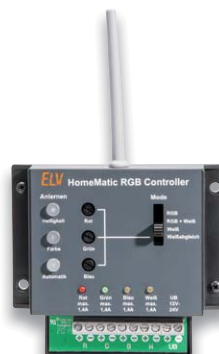
Bild 10: Mit dem Homematic Funk-Controller für Dual-White-LEDs lässt sich ganz einfach der Tageslichtlauf in einem Terrarium simulieren.
