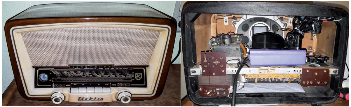
Bild 33: Das zweite Radio wurde ebenfalls mit einem Raspberry Pi und einem ELV-Verstärkermodul bestückt.
