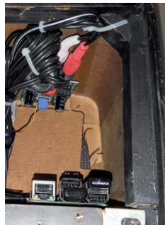
Bild 34: Der Cinch-Adapter am Raspberry Pi
