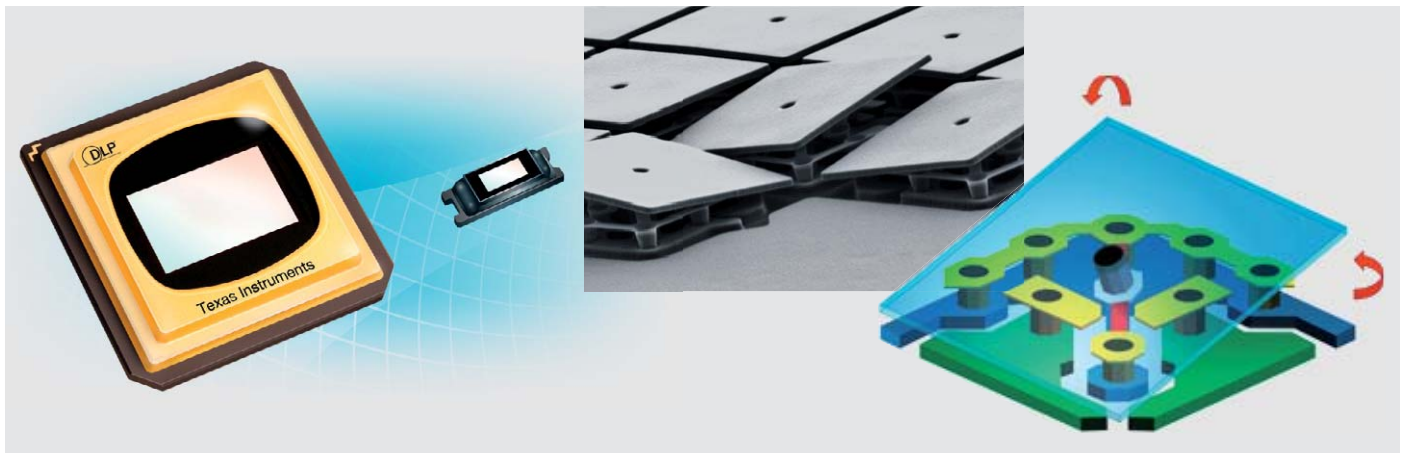
Bild 2: DLP-Chip von Texas Instruments für die Verwendung in Projektoren. In der Mitte sieht man die vergrößerte Mikromechanik der Spiegelfacetten, rechts die Funktionsweise. (Bilder: Texas Instruments)
