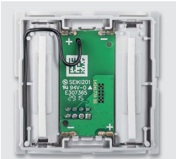
Bild 10: Der Antennendraht ist, wie hier zu sehen, zu verlegen und zu fixieren.
