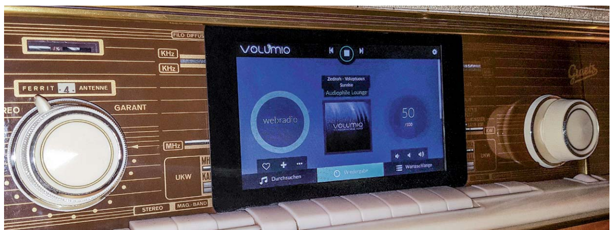
Bild 4: Das 7"-Touch-Display passt genau in die durch das Herausschneiden entstandene Lücke.
