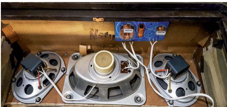
Bild 9: Der Breitband-Lautsprecher und einer der Hochtöner sind über eine Frequenzweiche angeschlossen.
