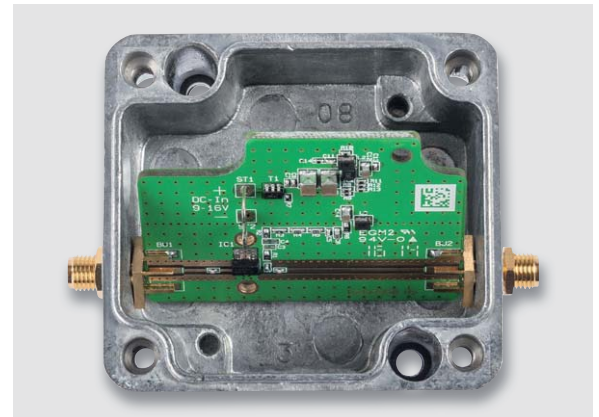
Bild 7: Leiterplatte senkrecht in die SMA-Buchsen eingeschoben
