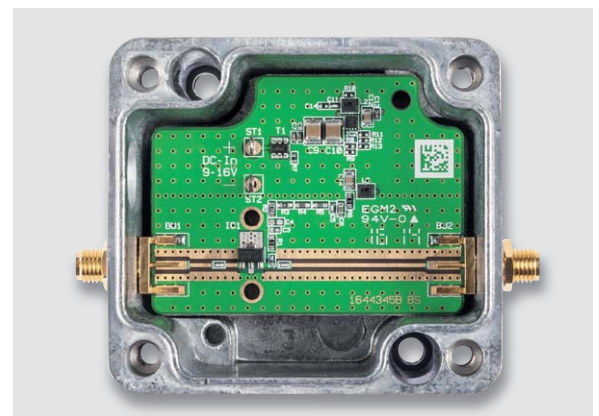
Bild 8: SMA-Buchsen positioniert und auf der Oberseite angeheftet
