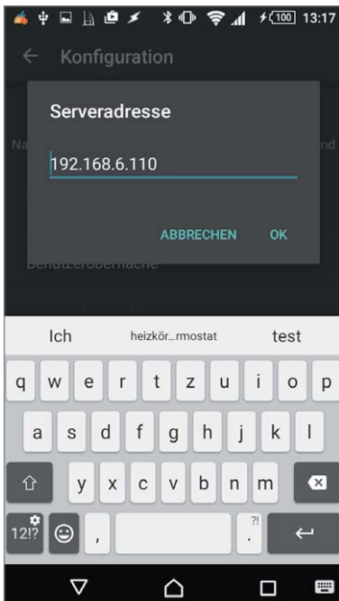
Bild 31: Unter Konfiguration ist bei „Serveradresse“ die IP-Adresse der CCU einzutragen und anschließend auf „VOLLSTÄNDIGE SYNCHRONISIERUNG“ zu tippen. Sollte die CCU-IP-Adresse noch nicht bekannt sein, ist unser Experten-Tipp zu berücksichtigen.
