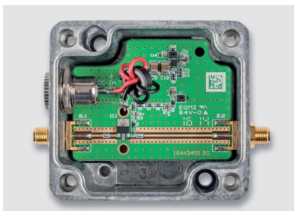
Bild 10: Innenansicht des RFA 404
