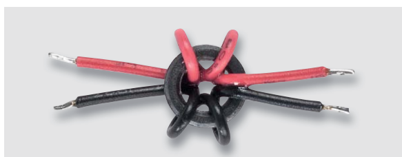
Bild 11: Fertig gewickelte stromkompensierte Ringkerndrossel
