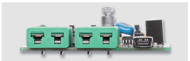
Bild 12: Die K-Type-Buchsen müssen plan auf der Platine liegen.
