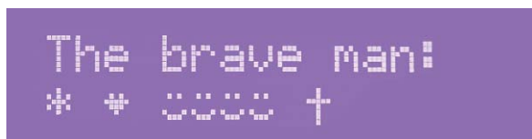
Bild 3: LCD-Anzeige mit selbst definierten Sonderzeichen
