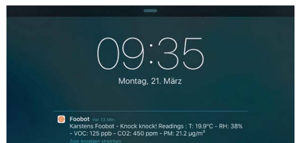
Bild 25: Klopft man an den Foobot, sendet er sofort die aktuellen Messwerte an das Smartphone.
