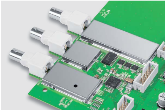
Bild 20: Die drei montierten Abschirmbleche
