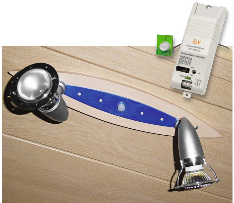
Bild 1: Eine typische Applikation des PIR13 im Beleuchtungsbereich. Der PIR13 steuert hier den hinter dem Lampensockel verbauten Ausschalttimer AT 230 ZD (Best.-Nr. J10-06 68 26) an, der über die Haussteuerung nur ab einbrechender Dämmerung Strom erhält.
