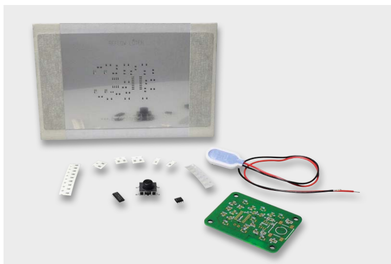
Bild 5: Zum Reflow-Kit wird ein kleiner Elektronikbausatz samt Stencil für den schnellen Einstieg mitgeliefert.
