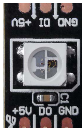
Bild 2: In der Nahansicht erkennt man deutlich die LED-Chips und den Controller auf dem Substrat.
