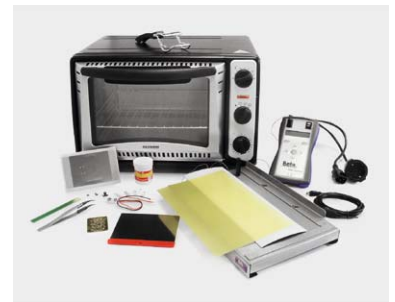
Bild 1: Das komplette Reflow-Kit enthält alles, was man zur Verarbeitung einer SMD-Platine benötigt. Auch ein kleiner Bausatz ist für den Einstieg dabei. Best.-Nr. CA-12 09 47, € 479,-
