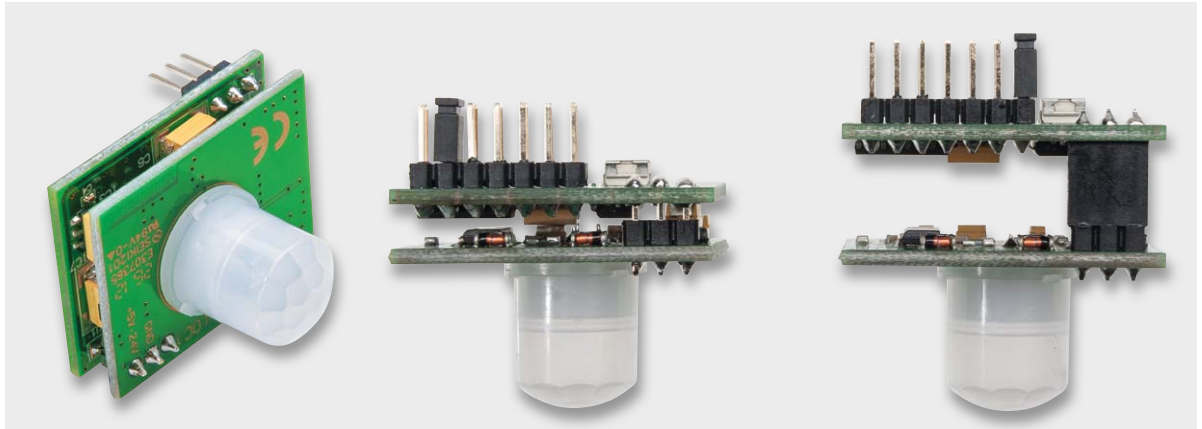
Bild 5: Vergleich zwischen direkt und über die Steckverbindung per Buchsenleiste verbundenen PIR13 und Timermodulen. Die direkt verbundene Version baut dabei sehr kompakt, wie die Bilder links deutlich zeigen.
