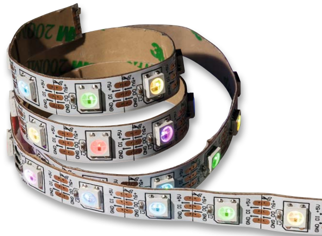
Bild 9: Leicht zu verarbeiten, nach jeder LED teilbar: ein WS2812B-LED-Streifen
