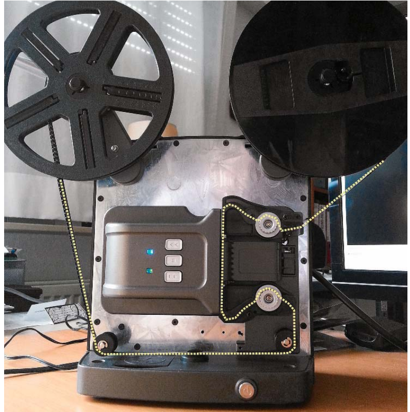
Bild 3: Nachdem der S8-Scanner den Film in die Abtastmechanik eingezogen hat, nimmt der Film im Inneren des Scanners den gelb gepunkteten Verlauf.
