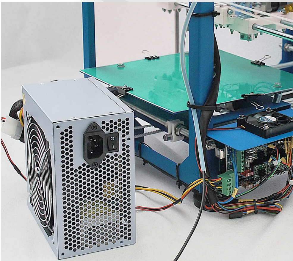
Bild 21: Das recht leise laufende Netzteil wirkt wie ein Fremdkörper neben dem Drucker – es wird später über eine längere 12-V-Zuleitung angeschlossen.
