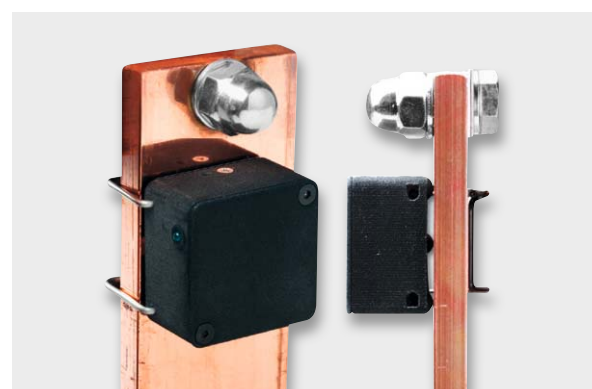
Bild 31: Dieser mNode-Funk-Sensor von Micropelt bezieht seine Energie aus dem Magnetfeld einer Stromschiene und überwacht ständig deren Temperatur, um Unregelmäßigkeiten im Betrieb aufdecken zu können. Quelle: Micropelt
