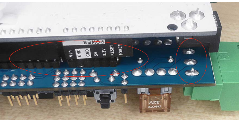
Bild 17: Die am 12-V-Steckverbinder der RAMPS-Platine zu weit herausstehenden Anschlüsse müssen gekürzt werden, um die Platine plan auf die Arduino-Platine aufsetzen zu können.
