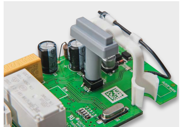
Bild 21: Das Aufsetzen der Tasterkappe muss vorsichtig und exakt im Winkel erfolgen.
