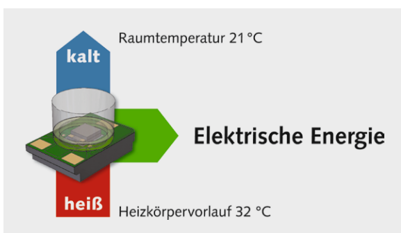
Bild 22: Ein TEG zur Gewinnung der Stellenergie eines autarken Heizkörperthermostaten
