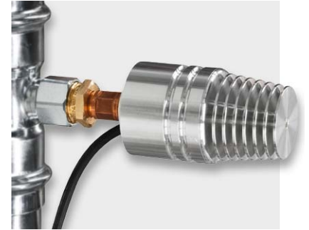
Bild 20: Ein Nahfeld-Harvester-Demonstrator nutzt die Temperaturdifferenz zwischen einem Warmwasserrohr und der Umgebung. Quelle: Micropelt
