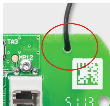
Bild 6: Hier ist die Antenne des Transceivermoduls hindurchzuführen.
