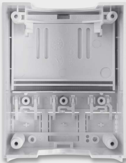
Bild 9: Beim Einsetzen des Halterahmens darf die Reflektor-Folie nicht verrutschen.
