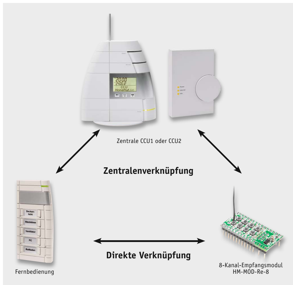
Bild 2: Unterschied zwischen direkter Verknüpfung und Zentralenverknüpfung
