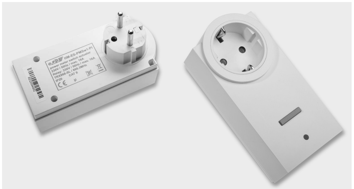
Bild 26: So erfolgt das Zusammensetzen von Gehäuseunterteil und Oberteil, die Tasterkappe muss sauber in ihrer Aussparung stehen und beweglich sein.
