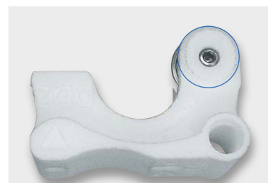
Bild 14: So haben wir die in der Wellenkupplung nicht fixierbaren Gewindestangen befestigt: links mit Gewindekleber, rechts mit einigen Lagen Kaptonband als Verstärkung.
