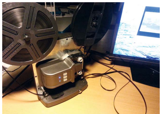
Bild 15: Mit der vollen großen Aufwickelspule war der Aufwickelmotor überfordert. Mit kleineren Spulen gibt es dagegen keinen Bandsalat.
