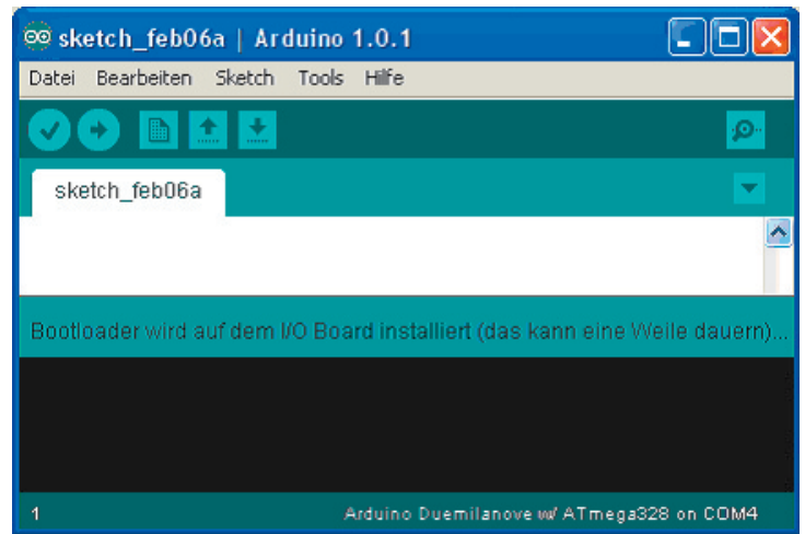
Bild 7: Die Anzeige in der IDE während der Bootloader-Installation
