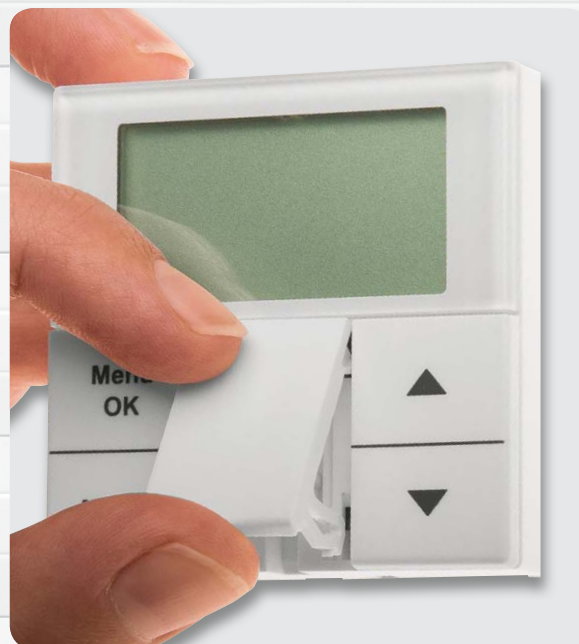
Bild 18: Das Einsetzen der Sensoranschluss-Abdeckung
