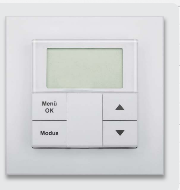
Bild 29: Der auf der Unterputzeinheit platzierte Rahmen
