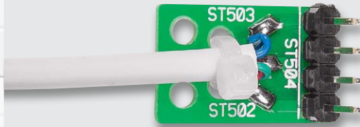
Bild 41: Die an der Steckerplatine fixierte und verlötete Sensorleitung
