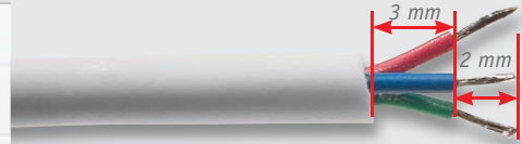
Bild 40: So erfolgt das Abisolieren der Sensorleitung auf der Geräteseite.
