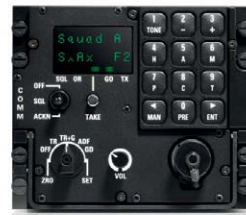
Bild 18: Stecken im A400 wie im Tornado, Eurofighter, F16, NH90 oder Tiger – die softwaredefinierte Flugfunkgeräte-Reihe MR6000A erfüllt als weltweit erste Flugfunkgeräte-Reihe militärische und zivile Avionik-Vorgaben.
