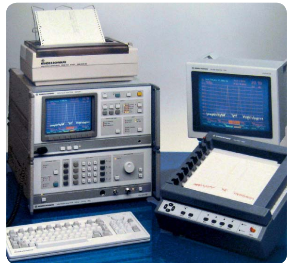
Bild 10: Der Einstieg von R&S in die Spektralanalyse – heute eine wesentliche Sparte der Messtechnik – erfolgte mit dem FSA.
