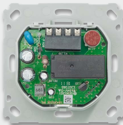
Bild 16: Die eingelegte und aufgesteckte Leistungsplatine, hier des Schaltaktors
