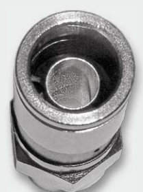
Bild 6: Sowohl bei Crimp- als auch Kompressionssteckern schieben sich die Innenhülsen über den Folienschirm (so vorhanden) des Koaxialkabels. So ist das weiche Schaumdielektrikum vor mechanischer Verformung geschützt. Das zurückgeschlagene Schirmgeflecht wird von der Außenhülse kontaktiert.
