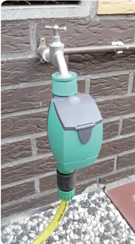
Bild 8: Der fertige Funkschalter wird direkt an der Zapfstelle des Hauswasserwerks platziert.
