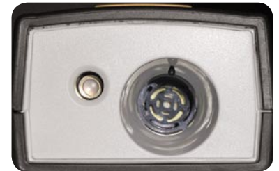
Bild 4: Aus der Öffnung neben dem großen Schalltrichter wird eine kreisförmige Laserlichtmarkierung gestrahlt, die auf der Reflexionsfläche des Schalls vollständig sichtbar sein muss.
