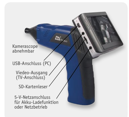
Bild 6: Der integrierte Videorecorder zeichnet auf eine SD-Speicherkarte auf. Bei Bedarf sind die Daten über einen USB-Port an einen PC und einen Videoausgang an einen weiteren Monitor auslegbar.
