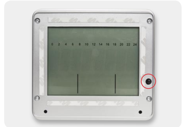
Bild 10: Beim Aufkleben des doppelseitigen Klebebandes ist darauf zu achten, dass die Öffnung für die IR-Diode nicht abgedeckt wird.
