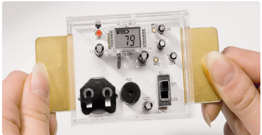
Bild 4: So sind die Elektroden des Pulsmessers zu erfassen.
