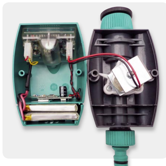
Bild 12: Der fertige Funkschalter vor der Montage, links unten ist das getrennte Batteriefach zu sehen, in das zwei Lithium-Akkus gerade hineinpassen.
