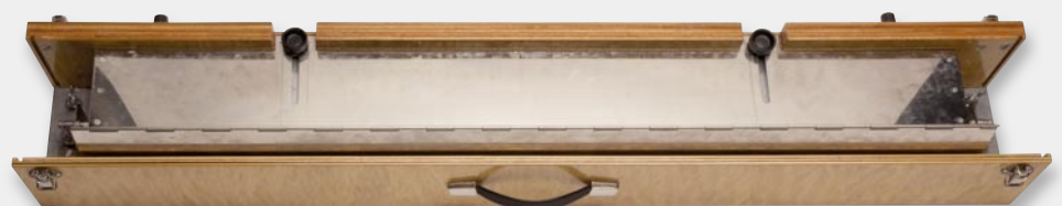
Bild 6: Eine Koppelzange für das Einkoppeln der Störpulse und ihr Aufbau
