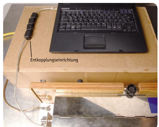
Bild 8: Ungenügende Entkopplungseinrichtung – die Folge war ein Ausfall der Verbindung zum Prüfling.
