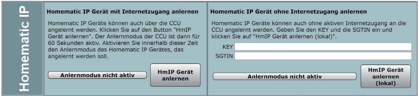
Bild 4: Über den Anlernmodus der WebUI kann die HmIP-MIO16-PCB an die CCUx angelehrt werden.
