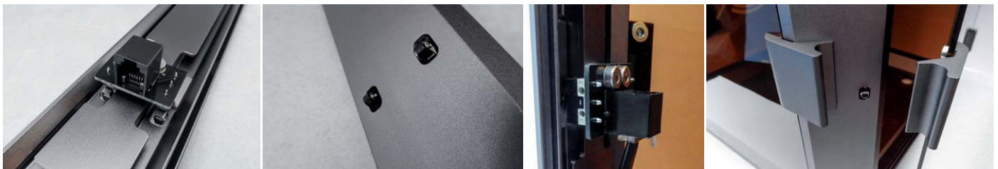
Bild 6: Die mitgelieferten und über ein Kabel an einen freien Port der Steuerelektronik angeschlossenen Türkontakte sorgen für ein sofortiges Abschalten des Lasers beim Öffnen einer der beiden Türen.
