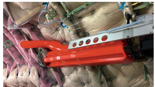
Bild 13: 3D-gedruckte Teile finden sich heute überall im modernen Flugzeugbau, hier an einem Airbus A330. Foto: Airbus
