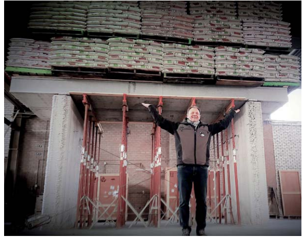
Bild 9: Hält 50 Tonnen Belastung stand – die 3D-gedruckte Gebäudewand von CyBe Construction. Foto: CyBe Construction
