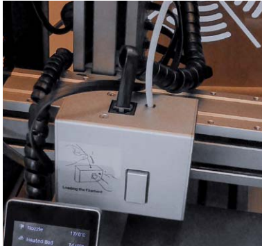
Bild 8: Die Filamentführung wird direkt in den Extruder eingesetzt.
