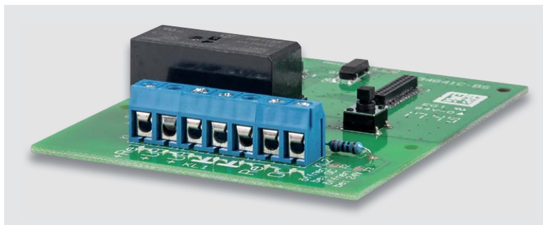
Bild 11: Einlöten der Schraubklemmen
