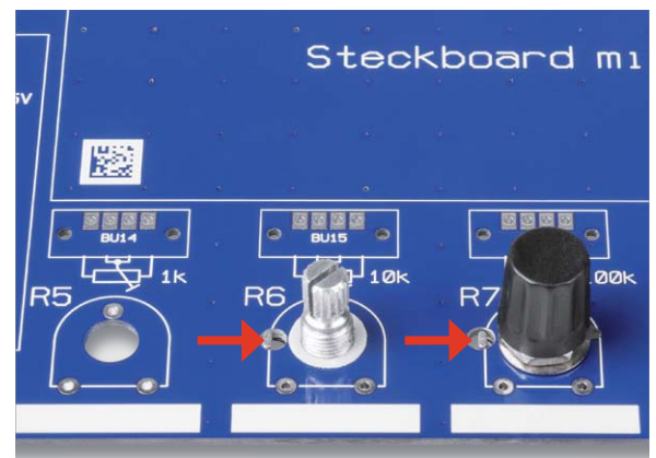
Bild 17: Für die Montage eines Potis muss an der markierten Stelle eine 3-mm-Bohrung eingebracht werden. Zur Vermeidung eines Kurzschlusses zwischen Potigehäuse und Platine sind jeweils Isolierscheiben einzusetzen.
