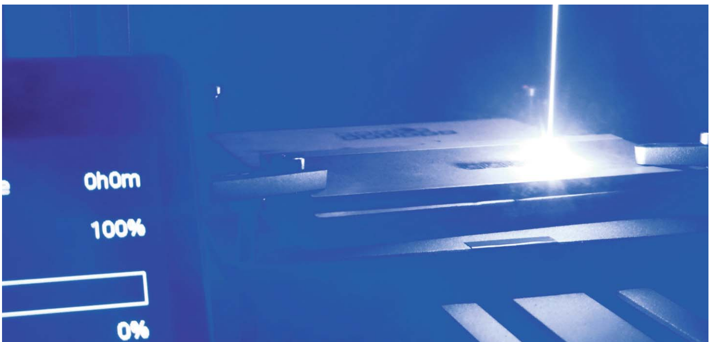
Bild 10: Das 1600-mW-Lasermodul mit einer Wellenlänge von 445 nm in Aktion.
