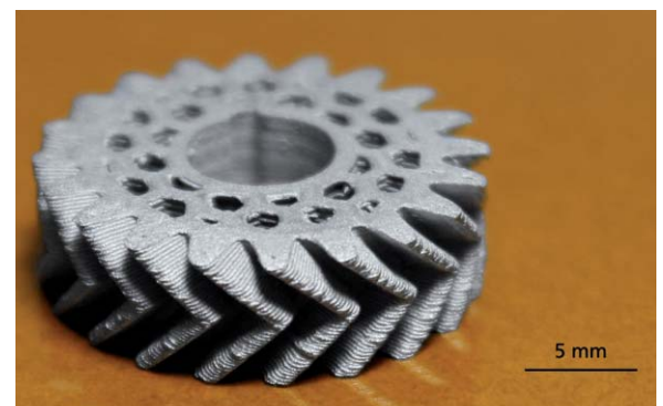
Bild 2: Ein im Sinterverfahren aus metallpulverhaltigem Filament hergestelltes Getrieberad. Foto: Fraunhofer IFAM Dresden
