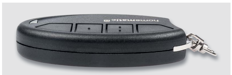
Bild 18: Zum Abschluss erfolgt eine Rundum-Kontrolle auf ein gleichmäßiges Spaltmaß zwischen den Gehäuseshälften.
