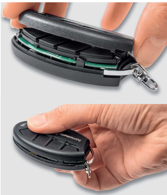
Bild 16: Zum Zusammensetzen der Gehäusenhälften ist zunächst die Gehäuseoberschale von der Batterieseite her seitlich einzusetzen (oben), danach drückt man beide Gehäuseshälften bis zum Einrasten zusammen.
