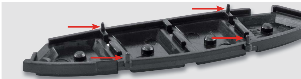
Bild 13: Hier sind die Führungsstifte der Tastenmatte gut zu sehen.
