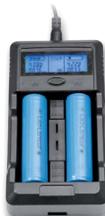
Bild 8: Typischer Einzelzellenlader für Akkus in Lithium-Technik
