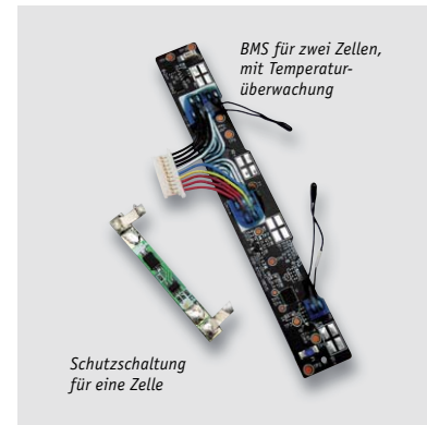
Bild 5: Lithium-Akkus sind fast immer ab Werk mit Batteriemangement- oder wenigstens Schutzsystemen gegen Tiefentladung und Überladung versehen.
