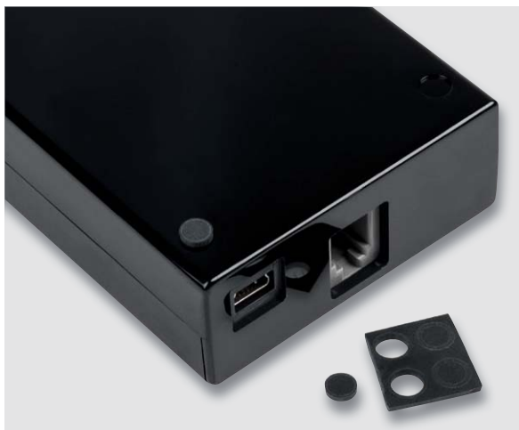
Bild 29: Ankleben der 4 Gehäusefüße an der Gehäuseunterseite
