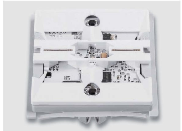
Bild 14: Der Lichtleiter muss plan auf der Controllerplatine und dem Gehäuseteil aufliegen.
