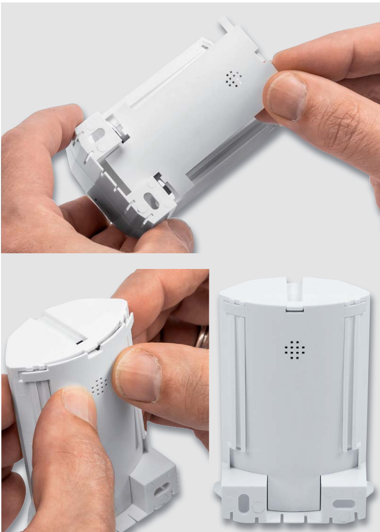
Bild 18: Mit Einsetzen des Batteriefachdeckels ist die Montage zunächst abgeschlossen.
