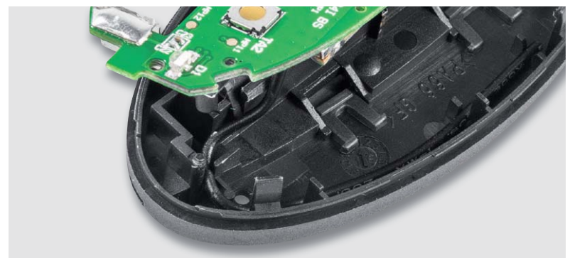
Bild 11: ... folgt das Einlegen der Platine, wobei nochmals auf die korrekte Antennenführung im Tasterbereich zu achten ist ...
