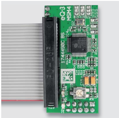
Bild 11: Sämtliche Anschlüsse des MP3-Soundmoduls können über einen Flachbandkabel-Steckverbinder hergestellt werden.
