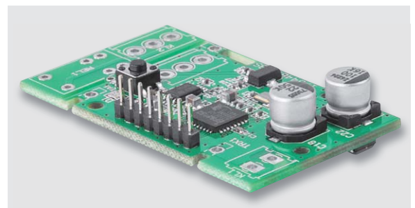
Bild 6: Die Bestückung der Stiftleiste erfolgt wie hier gezeigt, indem die langen Stifte nach oben stehen.
