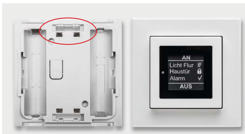
Bild 19: Beim Aufsetzen des Anzeigegegeräts ist ebenfalls darauf zu achten, dass die eingepprägten Pfeile nach oben weisen. Rechts das fertig montierte Gerät.
