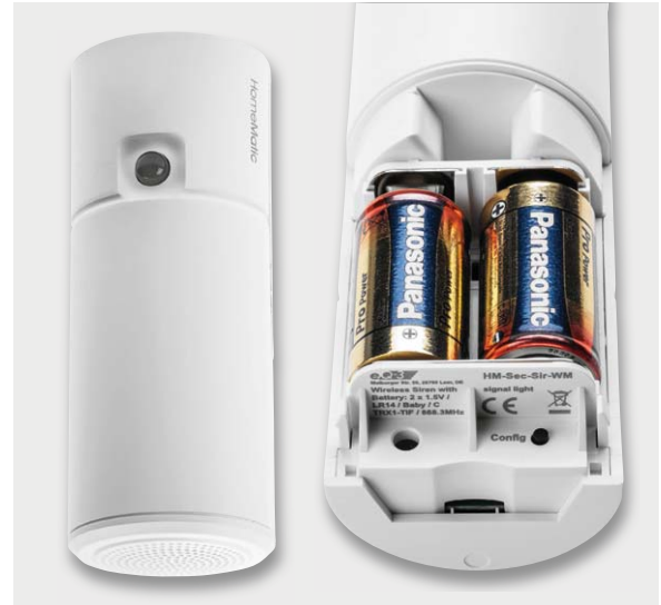
Bild 1: Die Elemente der Sirene: links die Signal-LED und der Piezo-Signalgeber, rechts das Batteriefach und der Konfigurations-Taster
