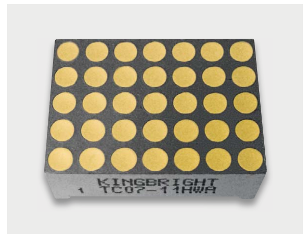
Bild 2: 5 \times 7 -LED-Matrix: Die „1“ links unten kennzeichnet meist Pin 1.
