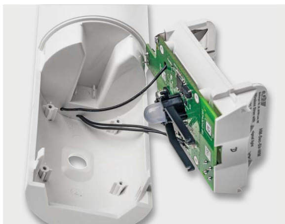
Bild 14: Die Leitungen zum Piezo-Signalgeber und die Antenne werden durch die Gehäuselöcher in die Schallkammer geführt, während das Batteriefach mit der Hauptplatine in das Gehäuse eingesetzt wird.
