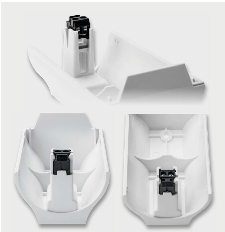
Bild 19: ... und danach die Schraubklemme wie hier gezeigt in den Batteriefachdeckel eingesetzt.
