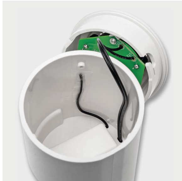
Bild 10: Alternativ kann die Antenne wie hier gezeigt verlegt werden, dies bringt eine erhöhte Funkreichweite.
