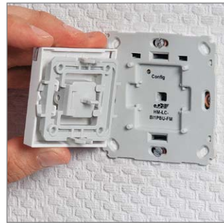
Bild 7: Abschließend wird die 1fach-Wippe samt Installations-Adapter und Rahmen in den HomeMatic Funk-Rollladenaktor eingesteckt.
