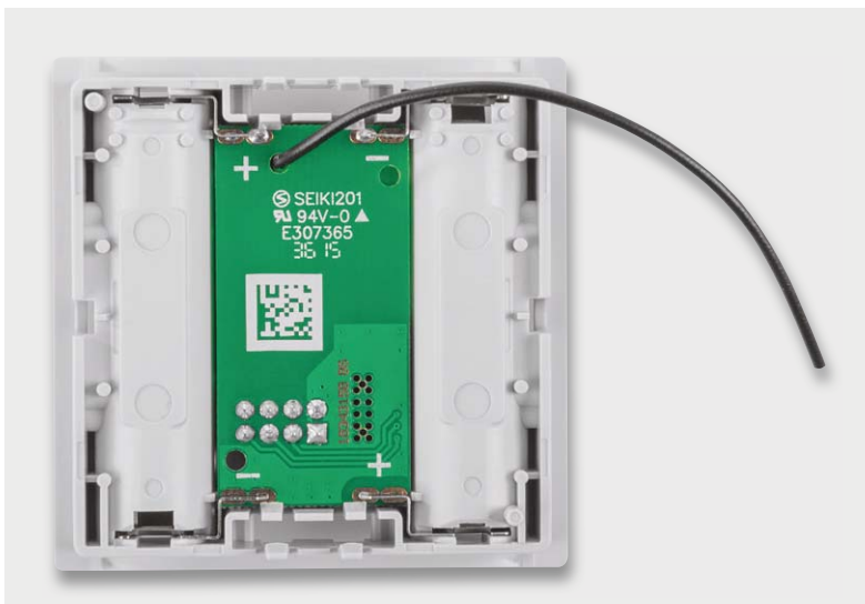
Bild 10: So wird die komplett bestöckte Funkplatine eingelegt, die markierten Platinenhalter müssen einrasten.
