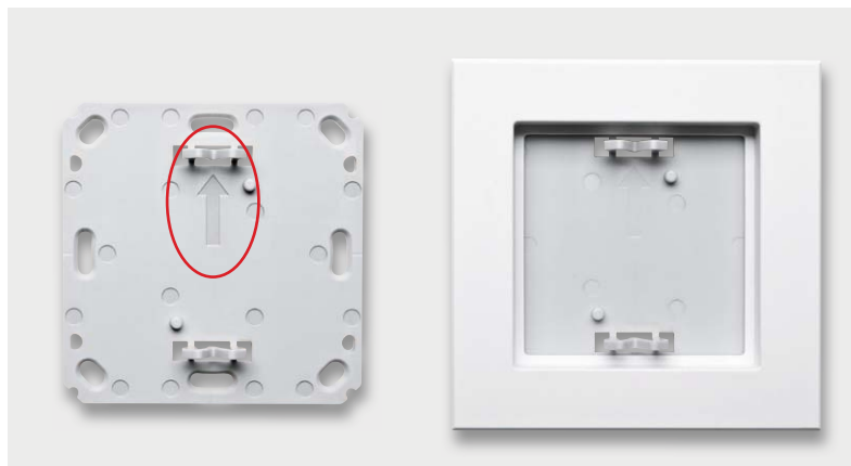
Bild 18: Links die Montageplatte, rechts ist der auf diese aufgesetzte Rahmen zu sehen. Der Pfeil auf der Montageplatte (siehe Markierung) muss nach oben zeigen.
