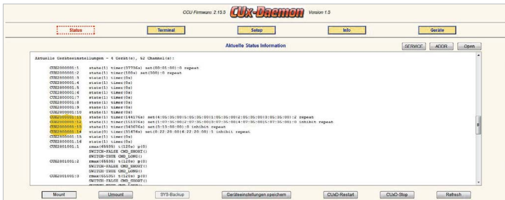
Bild 9: Auf der Cux-D-Statusseite können die Einstellungen der Timer 11 bis 14 nachvollzogen werden.
