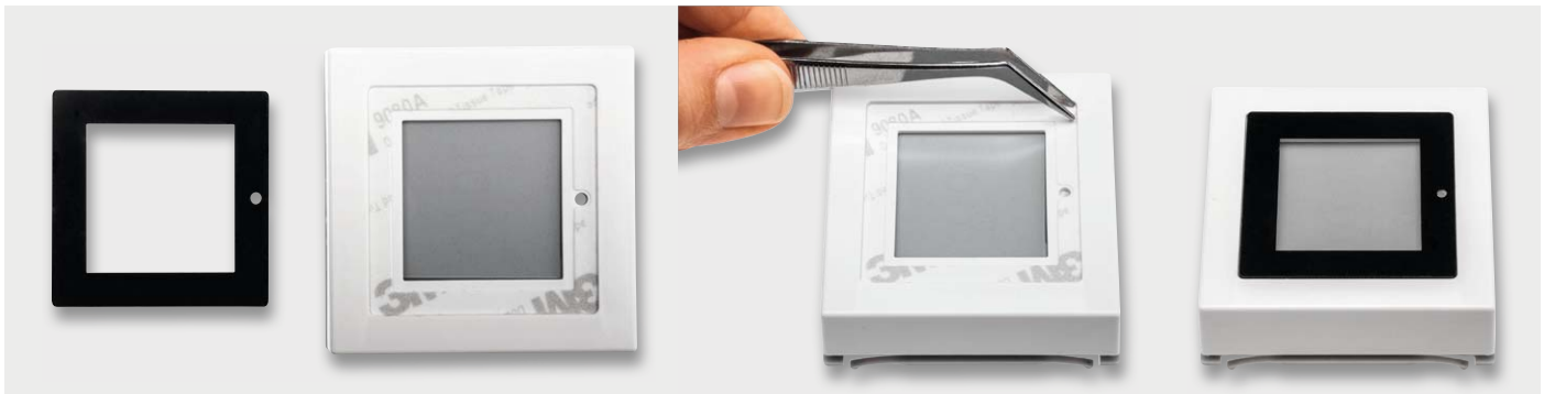
Bild 16: So erfolgt das Aufsetzen der Displayscheibe, ganz rechts ist die optische Erscheinung bei ausgeschaltetem Display zu sehen.
