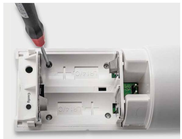
Bild 15: Das Batteriefach mit der aufgesetzten Hauptplatine wird mit vier Schrauben im Gehäuse befestigt.
