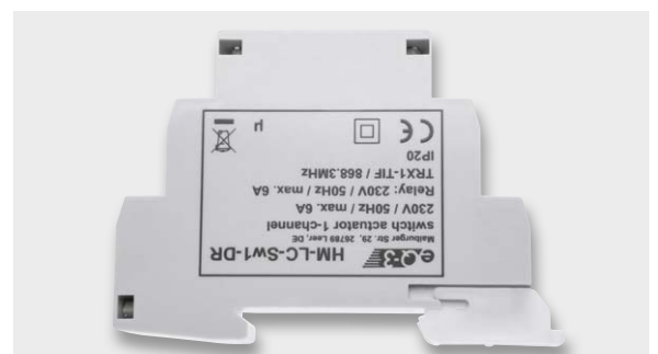
Bild 17: Letzter Montageschritt ist das Einschieben des Rastschiebers, der dem Fixieren auf der Hutschiene dient.
