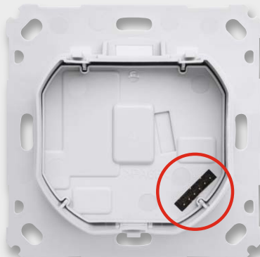
Bild 10: Die Isolierplatte zwischen Controller- und Netzteilplatine ist eingelegt. Rechts unten ist die Steckerleiste für die Verbindung beider Platinen zu sehen.
