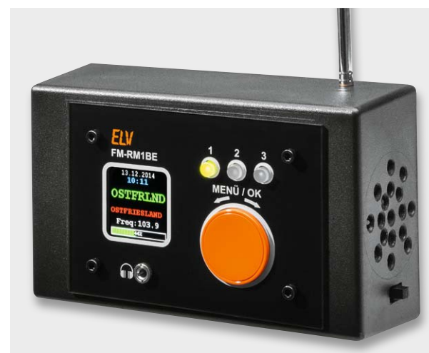
Bild 16: Einbaubeispiel in ein eigenes Gehäuse mit Stabantenne, Lautsprecher und Hauptschalter
