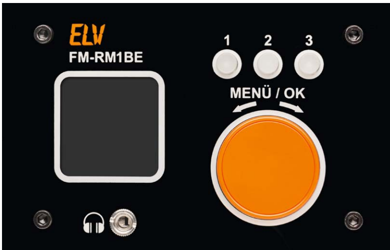
Bild 12: Das Bedien- und Anzeigemodul mit komplett montierter Frontplatte
