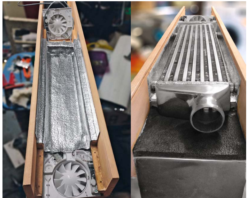
Bild 4: Die Schall- und Wärmeisolierung des Wärmetauschers
