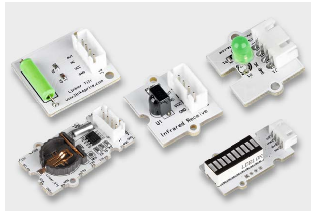
Bild 2: Einige Module des Linker-Kit-Systems – allen gemeinsam ist die einheitliche Schnittstelle.
