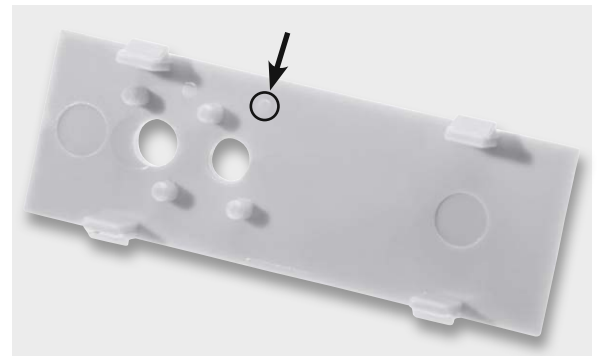
Bild 14: ... nachdem, falls noch vorhanden, der hier gekennzeichnete Pin entfernt ist.
