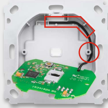
Bild 8: Die Antenne des Transceivers ist genau wie hier gezeigt einzulegen.
