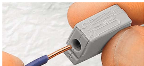
Bild 24: Leuchtenklemmen verbinden den Massivleiter der Installation mit dem Litzenleiter der Leuchte, ohne dass dieser vorher mit einer Adernendhülse versehen werden müsste. Durch Daumendruck auf die Federtaste der Klemme lässt sich der Leuchtenanschluss kraftfrei herstellen und wieder lösen.
