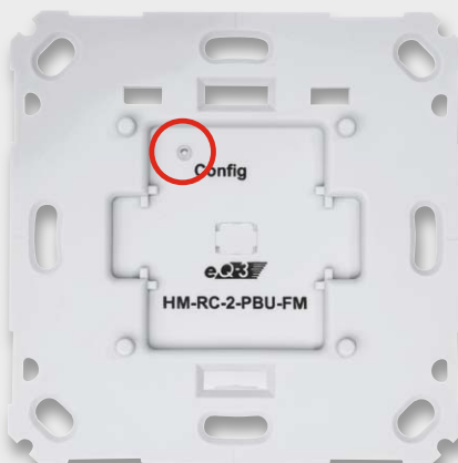
Bild 13: Der Tasterstößel ist auf Leichtgängigkeit zu prüfen.
