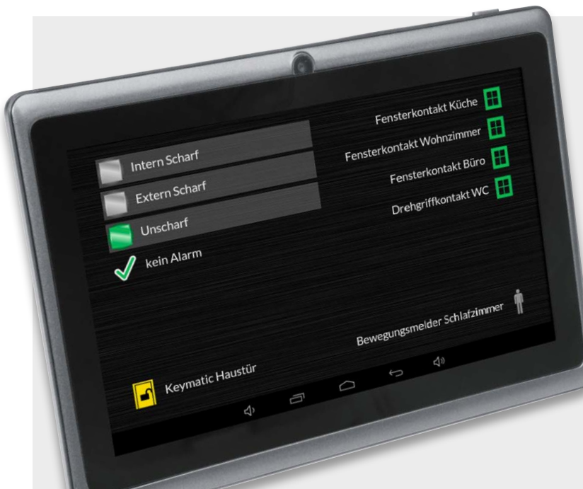
Bild 6: Das Easy SmartHome Display 7 fasst alle Alarmanzeigen, Meldungen und Zustände übersichtlich zusammen.
