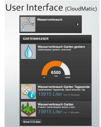
Bild 17: Der Wasserverbrauch (Trink- und Gartenwasser) wird durch die So-fähigen Wasseruhren gemessen, via CCU-Skript aufbereitet und in der CloudMatic-Bedienoberfläche visualisiert. So behält man den Verbrauch stets im Auge.
