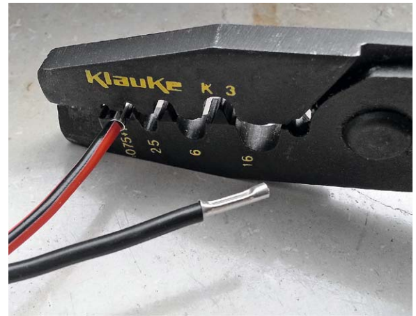
Bild 5: Für das Aufpressen von Aderendhülsen benötigt man eine passende Zange, um einen abzugfesten Sitz der gepressten Hülse zu garantieren.
