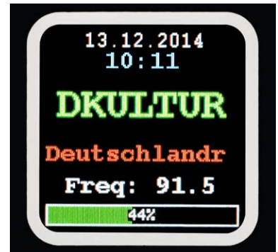
Bild 2: Die vollständige Anzeige mit Datum/Zeit, Sendername, RDS-Text, Frequenz und Lautstärkebalken
