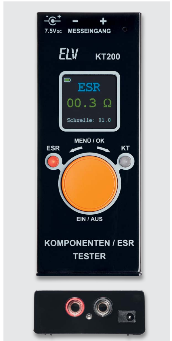
Bild 13: Frontansicht mit den aufgesetzten Bedienelementen, man sieht die in der Taste liegende LED für die ESR-Funktion leuchten. Darunter die Sicht auf die Mess- und Stromversorgungsbuchsen.
