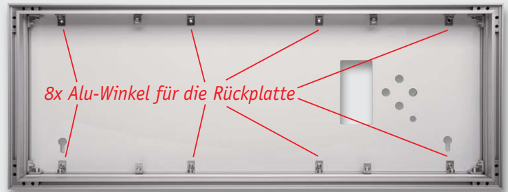
Bild 16: Der Gehäuserahmen, hier zur Übersicht bereits im montierten Zustand
