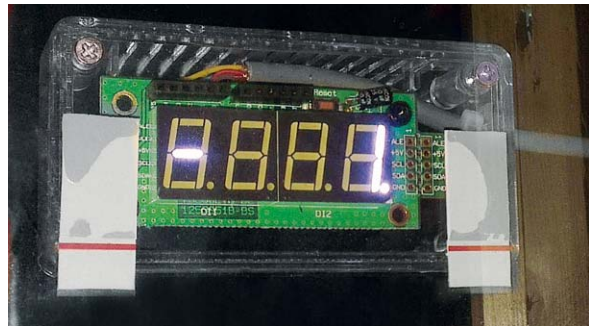
Bild 7: Die Datenanzeige durch die Glasscheibe hindurch übernimmt die LED-Anzeige des ELV I 2 C-4DLED.
