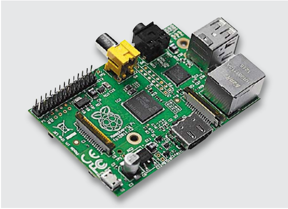
Bild 1: Mit gerade 85,6 x 53,98 mm nur so groß wie eine Scheckkarte – der Raspberry Pi, hier das Modell B
