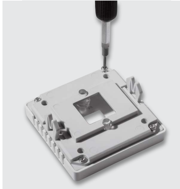
Bild 28: Verschrauben der Gehäusehälften der Frontabdeckung
