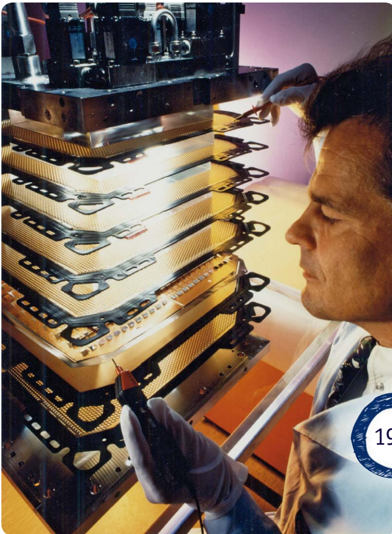
Bild 26: Weltmeister 1994 – die Hochtemperatur-Brennstoffzelle mit 1,8 kW Leistung
