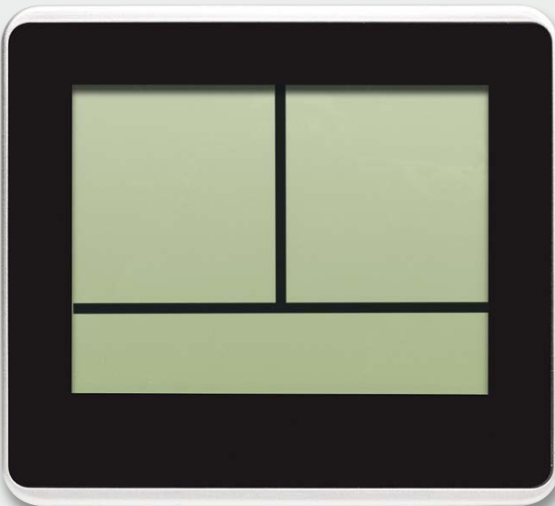
Bild 16: Das Gehäuse mit eingeklebter Frontplatte
