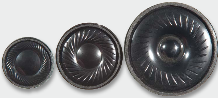
Bild 10: Verschiedene Lautsprecher mit unterschiedlichen Durchmessern
