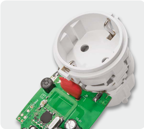
Bild 6: Der richtig herum aufgesetzte Steckdoseneinsatz
