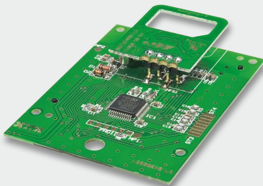
Bild 9: Das aufgelötete Funkmodul, die überstehenden Stiftleisten-Enden sind mit einem Seitenschneider zu kürzen
