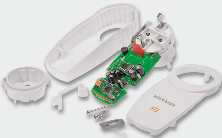
Bild 3: Die Teile des Bausatzes, hier mit bereits abgenommenem Steckdoseneinsatz
