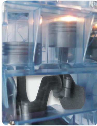
Bild 6: Funktioniert – das Zünden leitet den dritten Takt ein.
