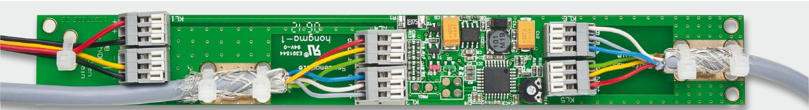
Bild 9: Anschluss der Leitungen auf der Basisplatine
