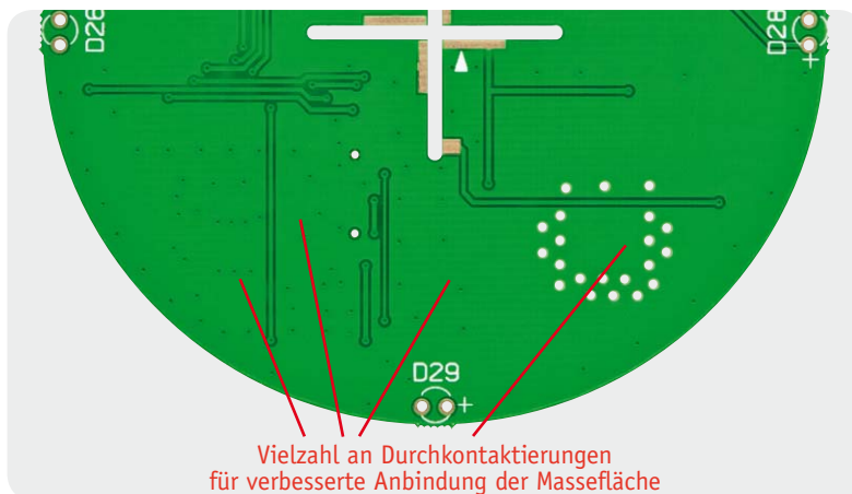
Bild 10: Bestückungsseite des neuen Leiterplattenaufbaus mit verbesserter Masseanbindung
