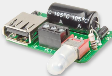
Bild 11: Spritzwasserschutz des Schalters mit Silikonhaube
