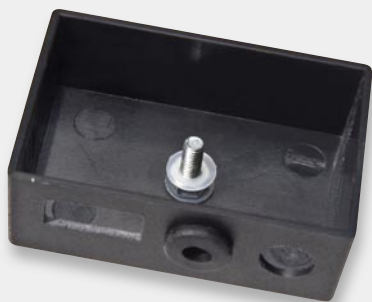
Bild 10: Verschraubung der Kabelbinderschellen an der Gehäuseinnenseite
