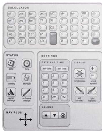
Bild 9: Ein wissenschaftlicher Rechner auf dem Papier: Hiermit werden nur die Eingaben für das Rechenprogramm im Smartpen gemacht, die Ausgabe erfolgt über sein Display.
