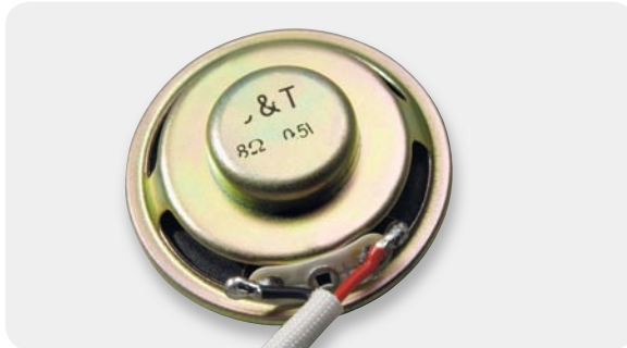
Bild 8: Montage der doppelt isolierten Lautsprecherleitungen am Lautsprecher
