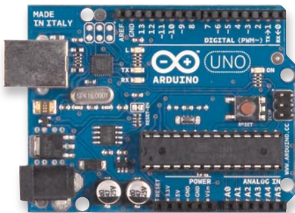
Das aktuelle ARDUINO-Board „UNO“ mit dem AVR-Controller ATmega 328
