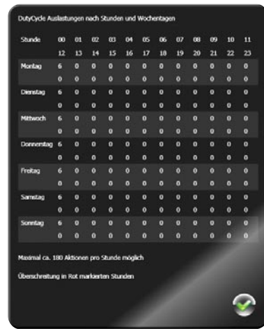
Bild 4: In der Duty-Cycle-Info findet man die Übersicht über die Duty-Cycle-Auslastung durch die FS20 MST2.
