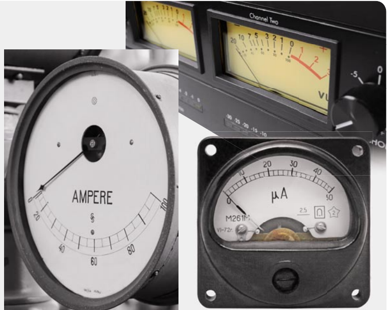
Bild 1: Ob historisch-nostalgisch oder modern-sachlich, im Prinzip sind alle Drehpulsesswerke, die keinen internen Shunt enthalten, einsetzbar.
