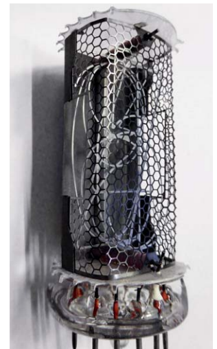
Bild 2: Hier sieht man den Aufbau mit Anodengitter und den hintereinander angeordneten Zeichenkathoden.
