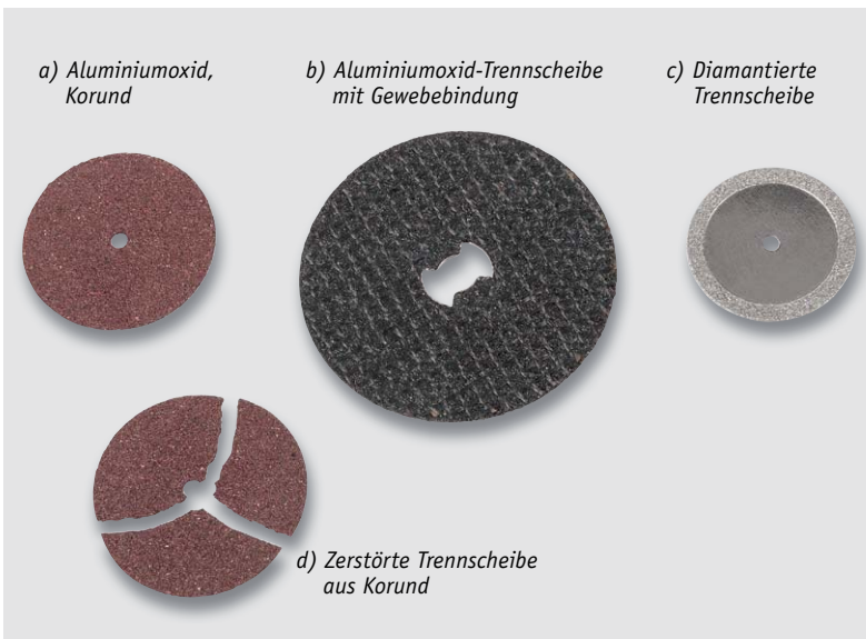
Bild 10: Geeignete (b und c) sowie nicht geeignete (a und d) Trennscheiben
