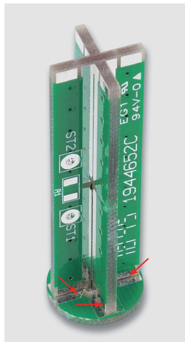
Bild 4: An den Übergängen zwischen Plus-Leiterplatte und Kern-Leiterplatten sind diese miteinander zu verlöten.
