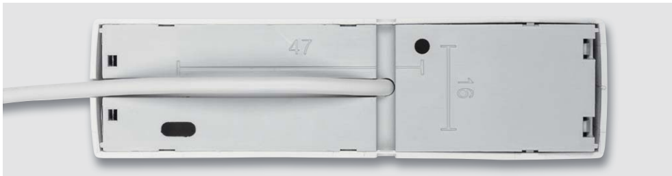
Bild 9: Das Verbindungskabel zum Kontakt wird, wie hier gezeigt, durch einen der Kabelkanäle auf der Geräteückseite und die zugehörige Bohrung in das Gehäuse geführt. Hier ist auch das entsprechend vorbereitete Gehäuseoberteil aufgesetzt.
