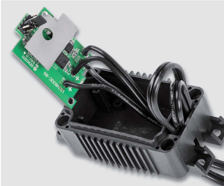
Bild 12: Die verdrehten und vorverzinnten Anschlussleitungen sind von oben durch die zugehörigen Platinenbohrungen zu führen.
