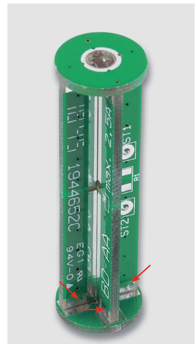
Bild 5: Auch die Übergänge zwischen Minus-Leiterplatte und Kern-Leiterplatten werden wie hier zu sehen miteinander verlötet.
