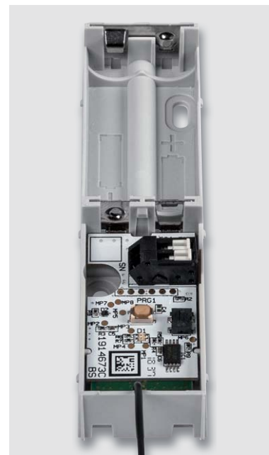
Bild 6: So werden Platine und Batteriebrückenkontakt in die Gehäuseunterschale eingelegt.
