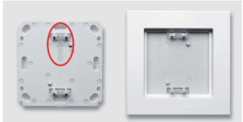
Bild 19: Links die Montageplatte, rechts ist der auf diese aufgesetzte Rahmen zu sehen. Der Pfeil auf der Montageplatte (siehe Markierung) muss nach oben zeigen.
