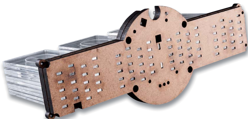
Bild 9: Eines der Geheimnisse der differenzierten Lichtleitung in die Acrylplatten sind die kleinen Ausschnitte im Holzkorpus – jeweils zwei genügen für die Ausleuchtung jedes Segments.
