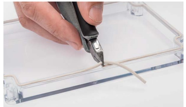
Bild 25: Zur wasserdichten Abdichtung des Gehäuses ist die Dichtung wie hier gezeigt in den Gehäusedeckel einzuarbeiten.
