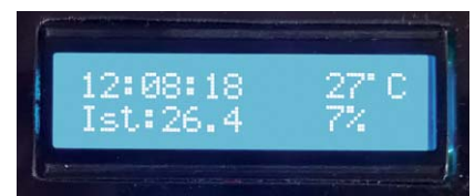
Bild 6: Die Blumenheizung im Betrieb, das Display stellt alle relevanten Parameter übersichtlich dar
