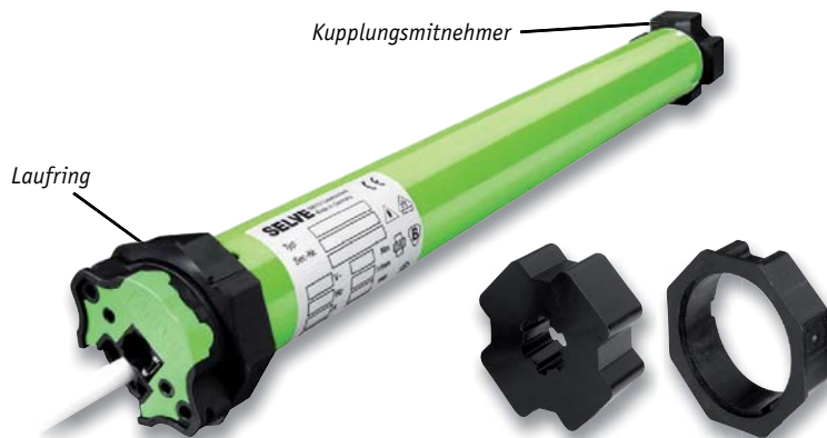
Bild 4: Mitnehmer und Laufringe sorgen für die Anpassung an die achteckige Form der Rollladenwelle, über Adapterringe kann man den Antrieb an andere Wellendurchmesser anpassen. Oben die typische Lage der Mitnehmer auf dem Motor, darunter Kupplungs- und Laufringadapter
