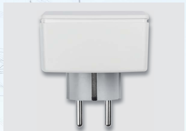
Bild 16: Bei ordnungsgemäßer Gehäusemontage muss sich ein gleichmäßig umlaufender Spalt zwischen beiden Gehäuseteilen zeigen.
