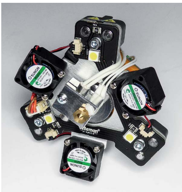
Bild 3: Der Druckkopf von unten gesehen. Hier erkennt man die drei Lüfter und die LED-Beleuchtung – alles fertig verkabelt geliefert.
