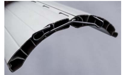
Bild 13: Bisher „rohe“ Rollladen-Lamellen kann man als Minimallösung mit Führungsklammern versehen. Die Klammern benötigen allerdings links und rechts jeweils ca. 1–2 mm Platz in der Führungsschiene.
