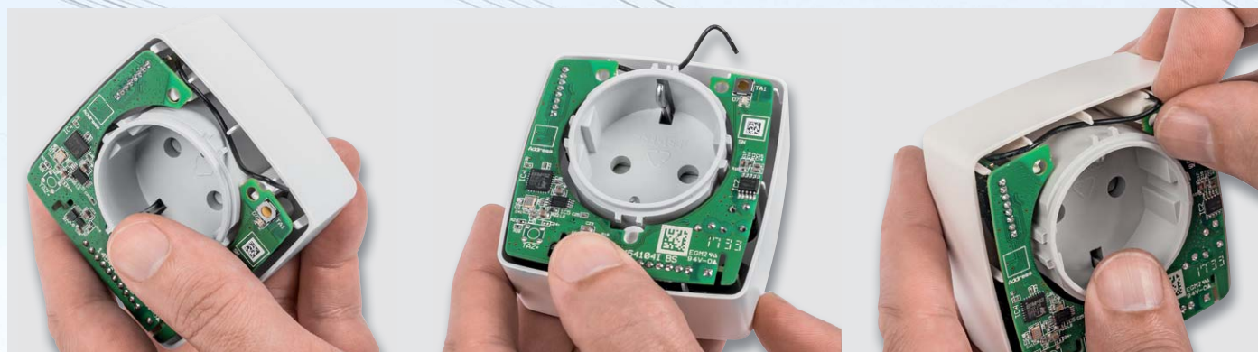
Bild 13: So wird der Antennendraht geführt, abgewinkelt und schließlich fixiert.
