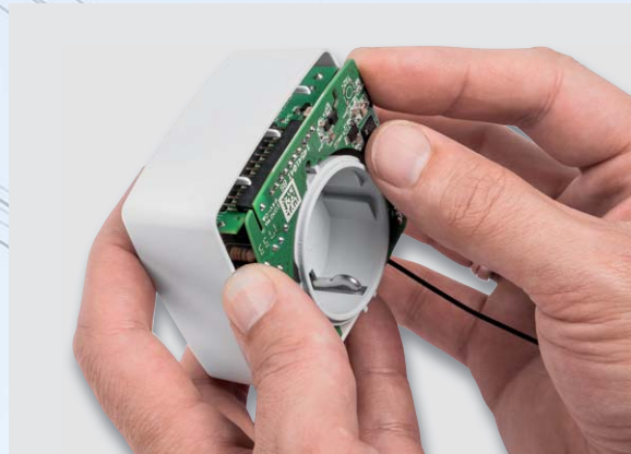
Bild 12: Die Controllerplatine wird vorsichtig auf die Buchsenleiste der Netz-/Speichercondensatorplatine gesteckt.
