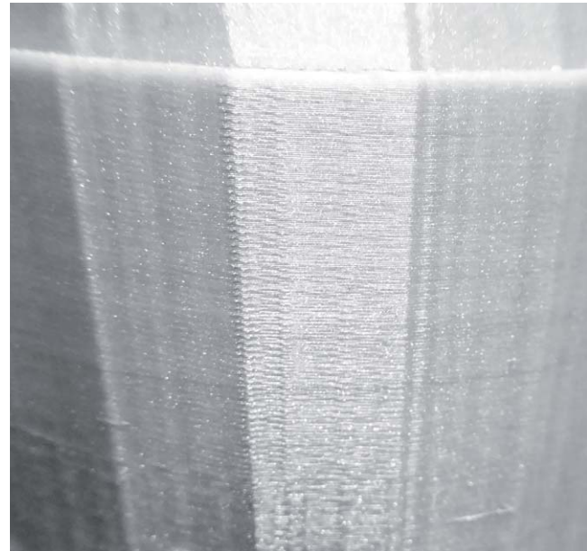
Bild 13: Nahaufnahme des ersten Druckstücks – nahezu ohne Fehler, gleichmäßig und mit feiner Oberflächenstruktur
