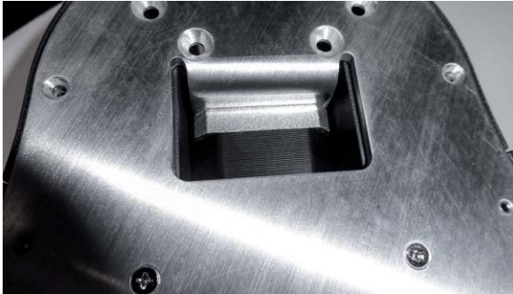
Bild 9: Die Schrittmotoren werden über die massive Grundplatte gekühlt.
