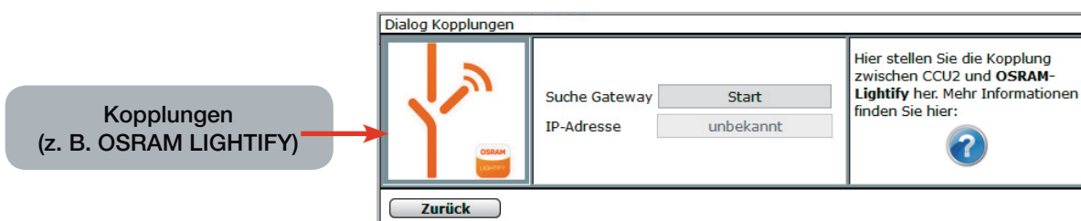
Bild 4: Über das Plug-in „Kopplungen“ kann man das LIGHTIFY Gateway sehr einfach in das Homematic System einbinden.
