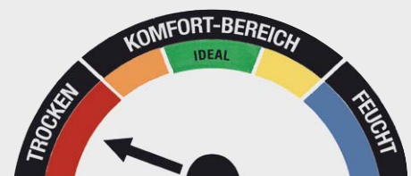
Bild 1: Aus der Beziehung zwischen Temperatur und Luftfeuchte ergeben sich die Klimazustände „trocken“, „feucht“ und „Komfort“.
