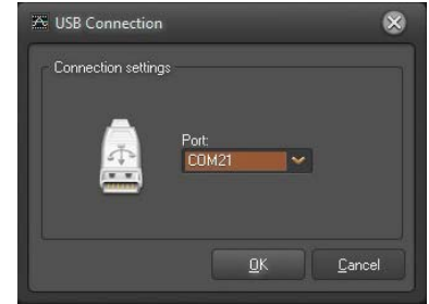
Bild 21: Bei der Nutzung der USB-Verbindung kann hier der durch den Treiber belegte virtuelle COM-Port kontrolliert bzw. gewechselt werden, falls man mehrere WFS210 betreiben will.
