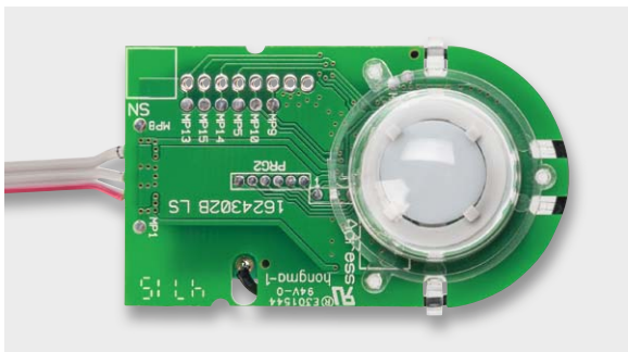
Bild 8: Die auf die Sensorplatine aufgesetzte Linse
