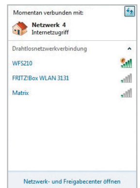
Bild 17: Das WFS210 erscheint, wie hier zu sehen, als WLAN-Netzwerkgerät.
