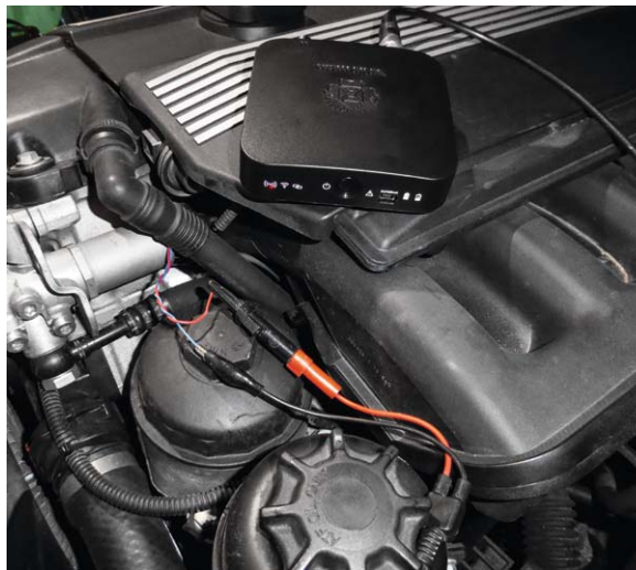
Bild 1: Sehr mobil dank WLAN-Verbindung zum Tablet-PC, hier wird das Verhalten eines Kurbelwellensensors im Betrieb erfasst.
