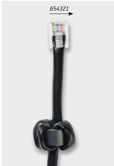
Bild 9: So wird der Ringkern für den Störschutz auf der Leitung angebracht.
