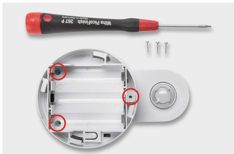
Bild 17: Nach dem Aufsetzen des Batteriefachs ist dieses mit 3 TORX-Schrauben zu befestigen.
