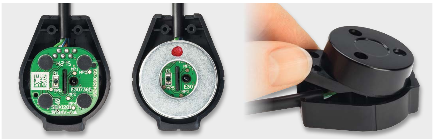
Bild 11: Die mit den vier Schaumstofffüßen versehene Platine wird in das Gehäuse eingelegt (links), dann der wie hier gezeigte ausgerichtete Magnet aufgesetzt (Mitte) und das Gehäuseoberteil aufgelegt (rechts).
