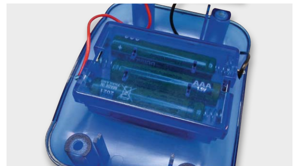
Bild 10: So erfolgt das Aufsetzen des Batteriefachdeckels auf das Batteriefach. Die Anschlüsse ragen dabei seitlich heraus.
