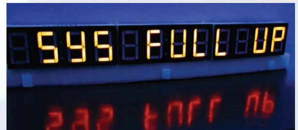
Bild 5: Darstellung von Informationstexten mit 7-Segment-Anzeigen
