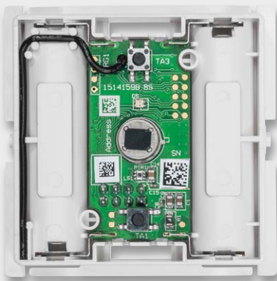
Bild 4: Die gesamte Schaltung inklusive Batterien ist in einem 55-mm-Standard-Raster untergebracht, so dass sie auch in viele Installationsprogramme direkt integrierbar ist.
