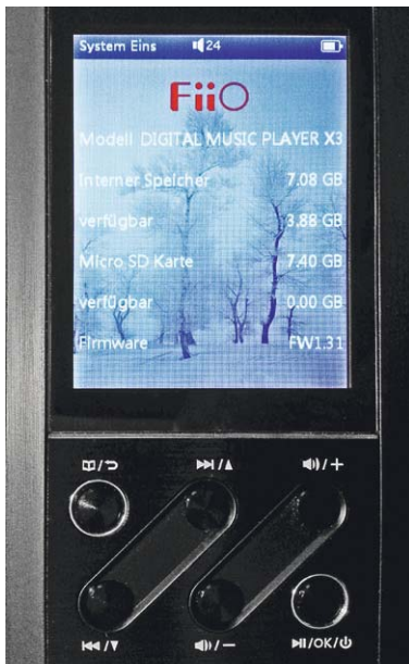
Bild 31: Erst ab Firmware-Version 2.05 ist der hochwertige Digital-Analog-Wandler des X3 auch mit extern über den USB-Anschluss zugespiltes Audiomaterial nutzbar. Die aktuelle FW-Version ist 3.3.
