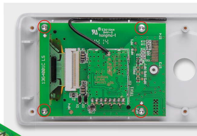
Bild 8: So erfolgt die Platzierung und das Verschrauben der Displayplatine sowie die Führung der Antenne im Gehäuse.
