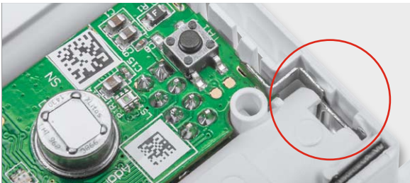
Bild 18: Auch die Batteriekontakte müssen unter den zugehörigen Gehäusenasen einrasten.
