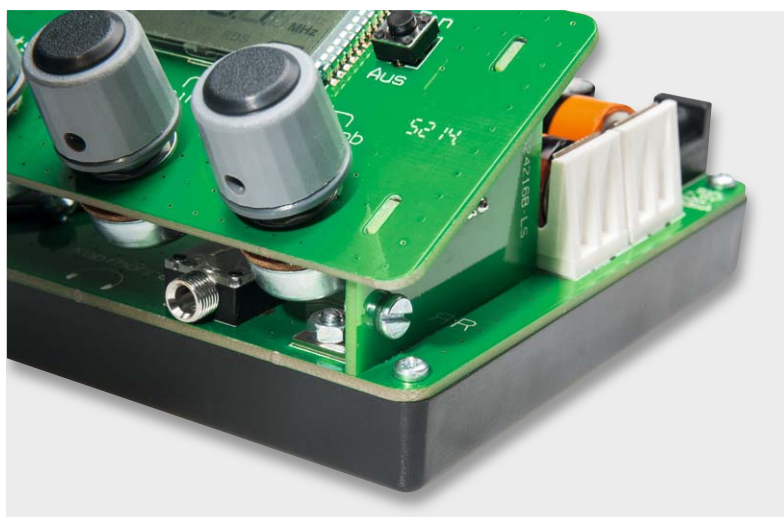
Bild 14: Hier ist der korrekt verschraubte Befestigungswinkel auf der rechten Seite zu sehen.
