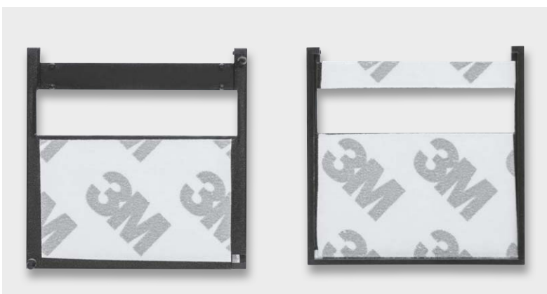
Bild 3: Das Aufkleben des doppelseitigen Klebendes auf den Displayrahmen, links die Unterseite, rechts die Oberseite
