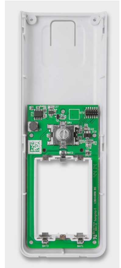
Bild 6: Die Lage der Batteriekontakte auf der Encoderplatine
