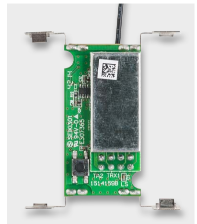
Bild 14: Platine mit bestücktem Transceiver-Modul
