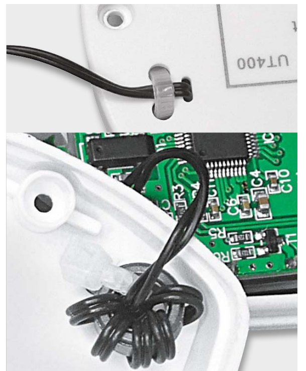
Bild 9: So wird das Sensorkabel um den Ferritring gelegt und mit einem Kabelbinder gesichert. Der Verschluss muss neben dem Ferritring eingelegt werden (siehe Bild unten), damit der Zusammenbau des Gehäuses problemlos erfolgen kann.
