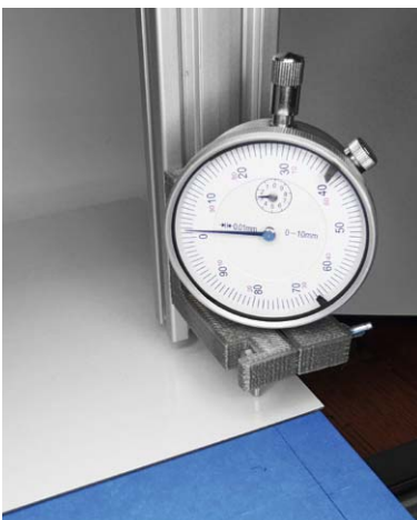
Bild 18: Ist Bestandteil des Fräs- und Gravursets – Messuhr zur hochgenauen Nivellierung des Drucktisches.
