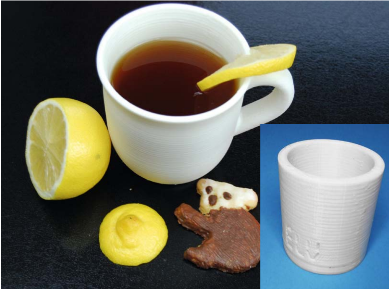
Bild 16: Mit dem lebensmittelechten PLA-HT ist sogar das bedenkenlose Drucken der eigenen Kaffeetasse möglich. Rechts ein erster (noch grober) Druckversuch auf unserem Drucker.
