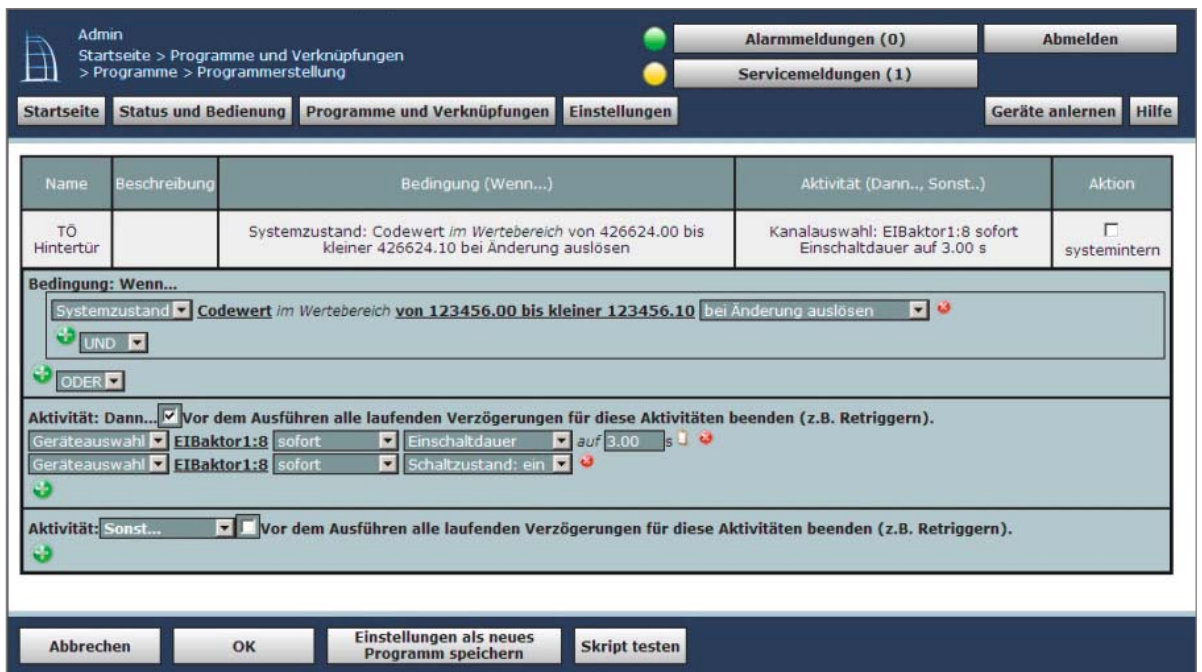
Bild 8: Das Beispielprogramm zur Codeabfrage zum Aktivieren eines Türöffners
