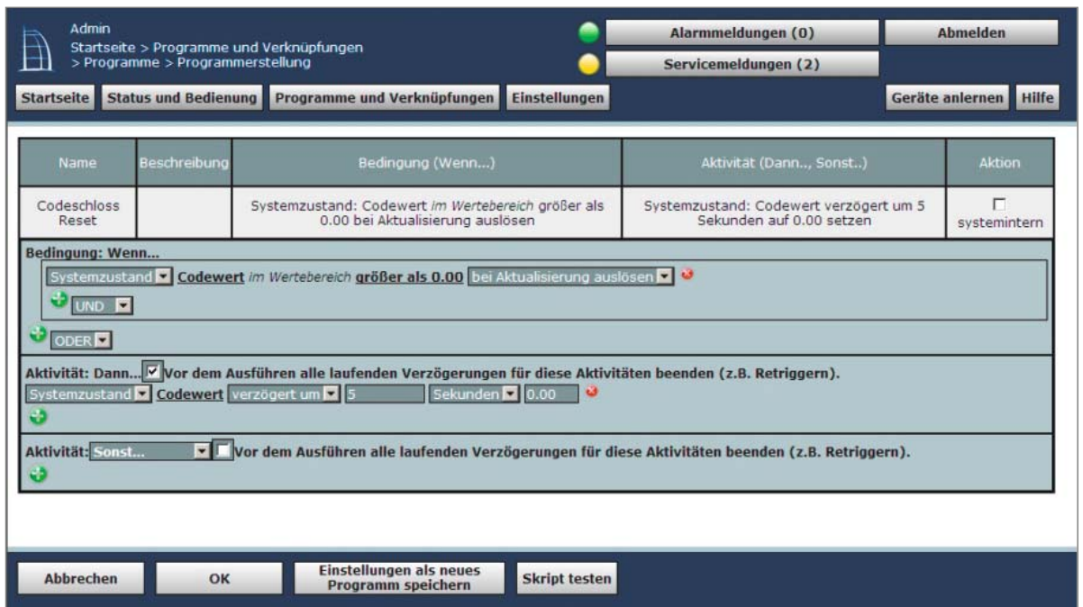
Bild 7: Ebenfalls nur ein kurzes Zentralenprogramm: die zeitliche Begrenzung der Codeeingabe mit Zurücksetzen der Systemvariablen
