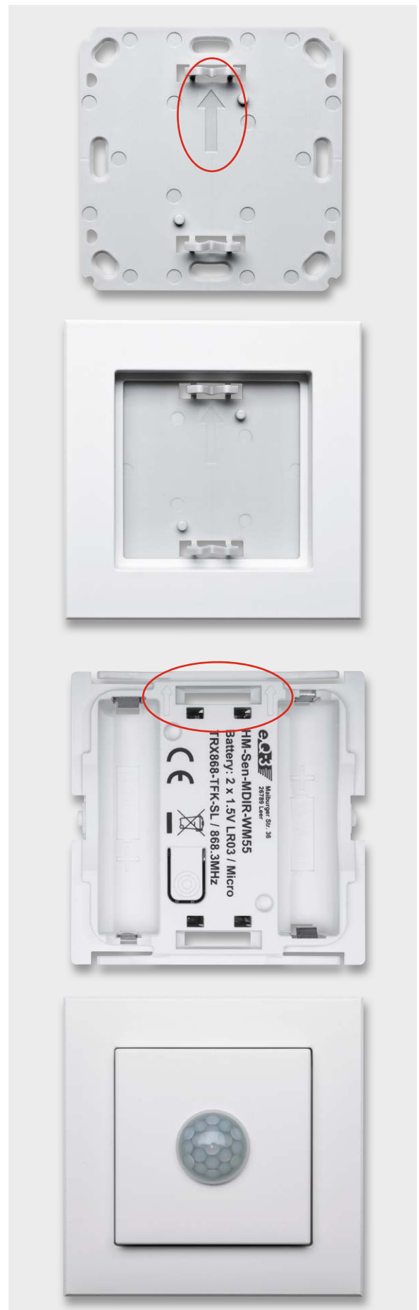
Bild 21: Die Reihenfolge der Geräte-Endmontage: oben die Montageplatte, darunter ist der auf diese aufgesetzte Rahmen zu sehen. Der Pfeil auf der Montageplatte (siehe Markierung im ersten Bild) muss nach oben zeigen. Beim Aufsetzen des Bewegungsmelders ist ebenfalls darauf zu achten, dass die eingepprägten Pfeile nach oben weisen, siehe drittes Bild. Unten das fertig montierte Gerät.
