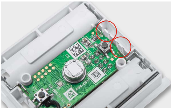
Bild 17: Die Platinenhalterungen müssen einrasten, so dass die Platine fest sitzt.
