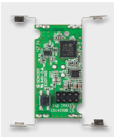
Bild 12: Die Platine mit bestückter Stiftleiste
