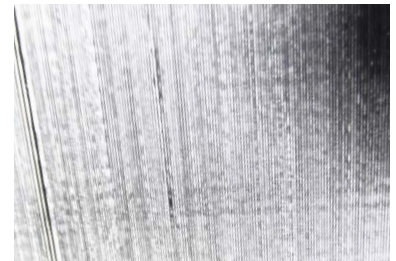
Bild 12: Die starke Vergrößerung zeigt einen bereits beim allerersten Druckstück recht homogenen Schichtenaufbau mit nur wenigen Mängeln.
