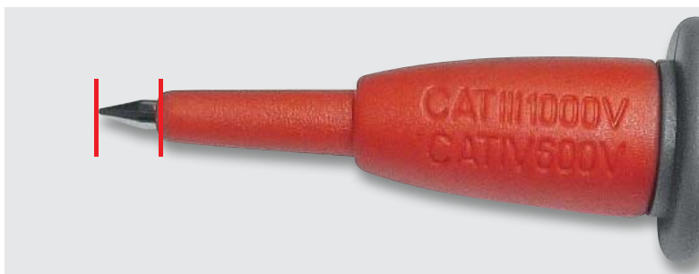
Bild 9: Ebenfalls definiert: die Länge der metallisch blanken Messspitze, zum Beispiel max. 4 mm bei CAT III/IV
