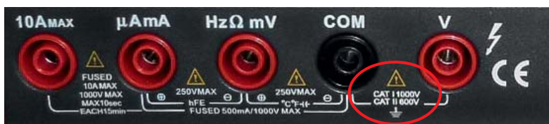
Bild 2: Sicherheitsklasse und Herstellerdeklaration sind gekennzeichnet.
