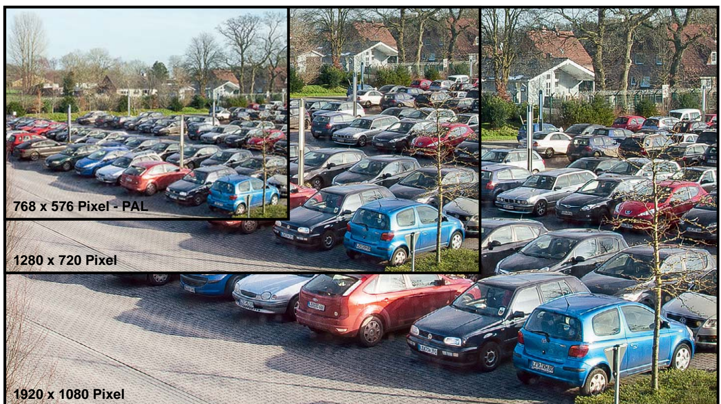
Bild 1: Full HD löst Bilder viermal höher auf als D1 – wichtig vor allem für die Erkennung von Details und die Darstellung auch auf großen Monitoren.
