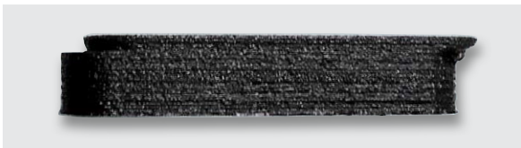
Bild 10: Das kann passieren, wenn sich das Druckstück während des Druckens löst, siehe Text.
