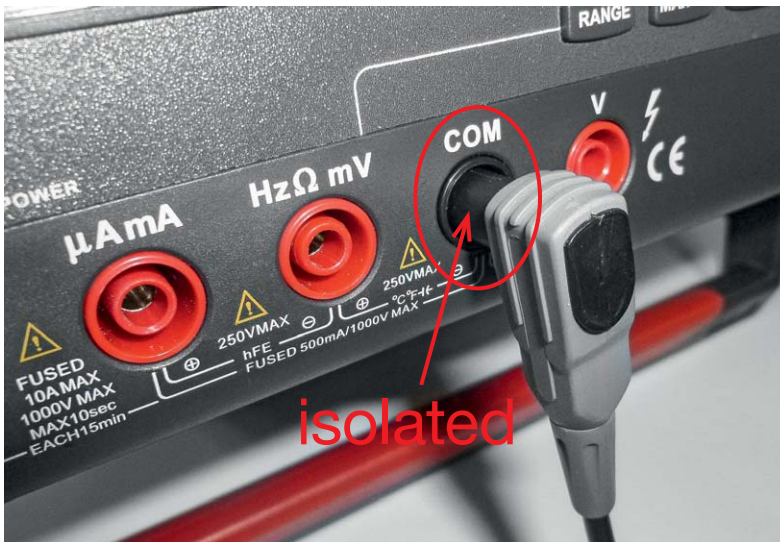
Bild 7: Zu keinem Zeitpunkt dürfen blanke Teile der Messanordnung berührbar sein.
