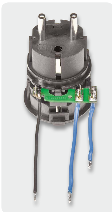
Bild 8: Die mit der lang abisolierten Seite an der Adapterplatine angelöteten Leitungen
