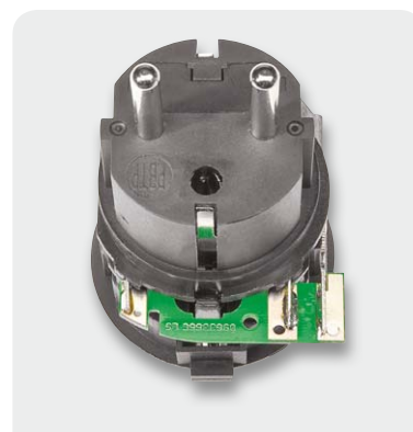
Bild 7: Die auf die Anschlussbleche gesetzte und angelötete Adapterplatine (drei Lötunkte)
