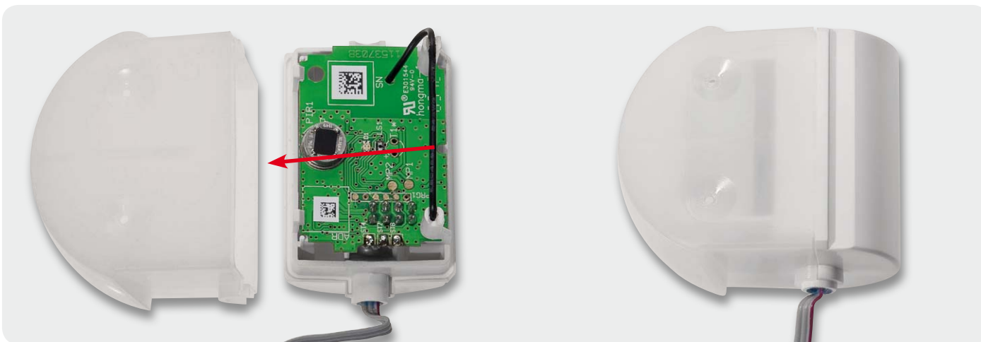
Bild 15: Das Zusammensetzen von hinterer Abdeckkappe und PIR-Linse
