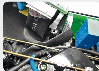
Bild 9: Nur einfach isolierte Leitungen bei der alten Version, rechts sind in der neuen Version alle Leitungen doppelt isoliert.
