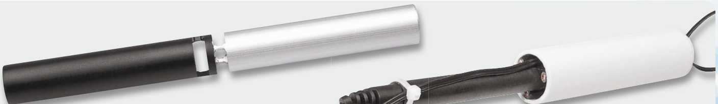
Bild 10: Grundlage für den Sonnensensor ist ein Aluminiumrohr, dessen eine Hälfte geschwärzt und das in der Mitte für geringe Wärmeübertragung mit Schlitzern versehen wurde.
