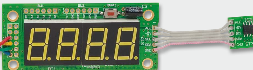
Bild 11: Die Verbindung mit einem PC erfolgt wie hier gezeigt über den USB-I 2 C-Adapter.
