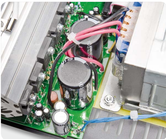
Bild 31: Die Sekundärleitungen des Trafos mit Kabelbindern
