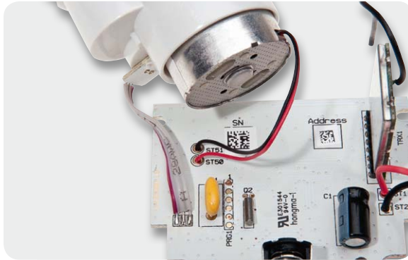
Bild 25: Anlöten der Motoranschlussleitung und der vom Optoreflexkoppler kommenden Leitungen an die Basisplatte
