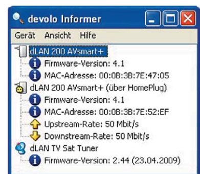
Bild 5: Mit zwei dLAN-200-AVsmart-Adaptoren von Devolo sind stabile 50 Mbit/s über das Stromnetz kein Problem.
