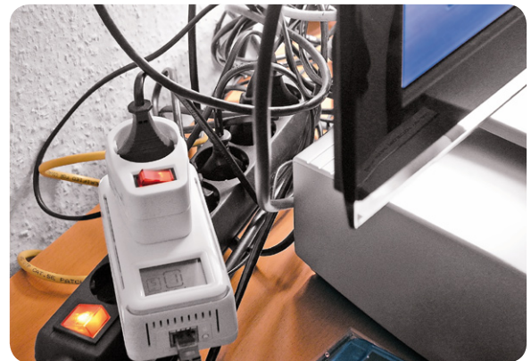
Bild 4: Wenn in der Nähe der Antennensteckdose kein Netzwerkanschluss verfügbar ist (und dies ist der Regelfall), kann PowerLAN-Technik weiterhelfen und das TV-Gerät in das häusliche LAN integrieren.
