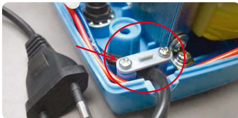
Bild 2: Hier klemmt nichts – das Netzkabel liegt lose unter der vermeintlichen Zugentlastung, die zudem auch gebrochen ist.
