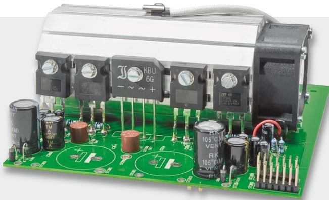
Bild 16: Transistoren und Gleichrichter am Kühlkörper links
