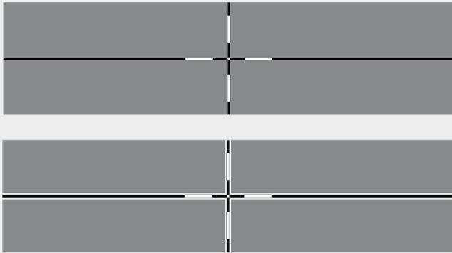
Bild 7: Einfache Bildschärfereinstellung mit einem Messkreuz, oben exakt, unten zu scharf eingestellt
