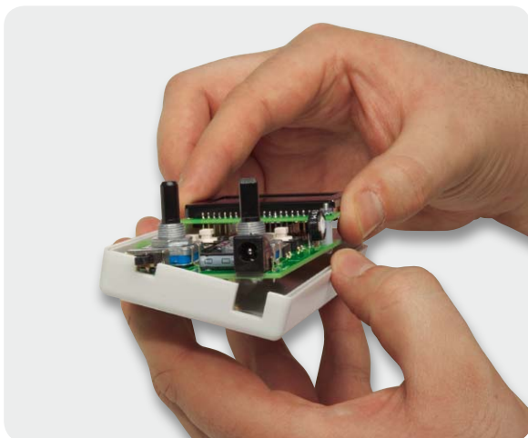
Bild 7: So erfolgt das Einlegen der Platine in die LA6-Gehäuseunter-schale.
