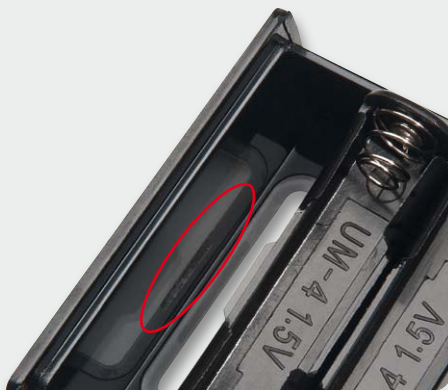
Bild 10: Bevor Basis- und Displayplatine über ST1 verbunden werden, ist die Displayeinheit so weit ins Gehäuseoberteil zu schieben, dass die Nase der Platine, wie hier gezeigt, in die Gehäusenut passt.
