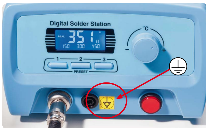
Bild 1: Die falsche Kennzeichnung des Potentialausgleichs
