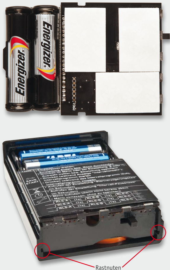
Bild 13: Die drei aufgeklebten Schaumstoffpads (oben) zur anschließenden Befestigung der Platinenabdeckung (Kurzanleitung) und die fertig ins Gehäuseoberteil eingesetzte Elektronik (unten)
