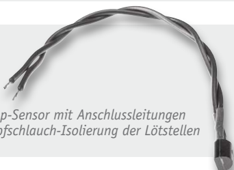
Bild 18: Konfektionierung der im DPS 5315 erforderlichen Leitungsabschnitte
