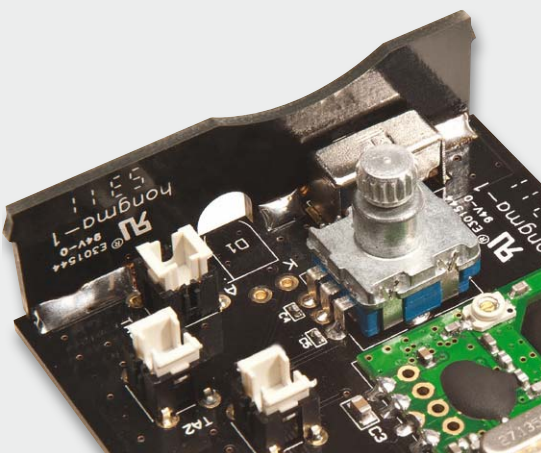
Bild 11: Das schmale abgetrennte Platinenstück wird im rechten Winkel auf das Ende der Basisplatine aufgesteckt und von innen angelötet.
