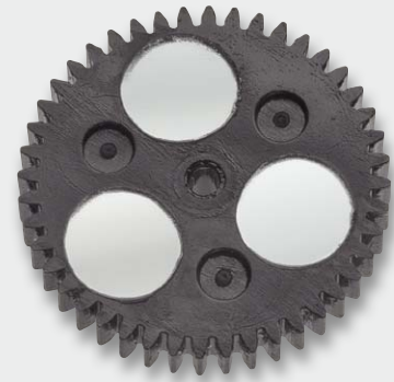
Bild 3: Getrieberad mit Markierungen für die Impulsabfrage
