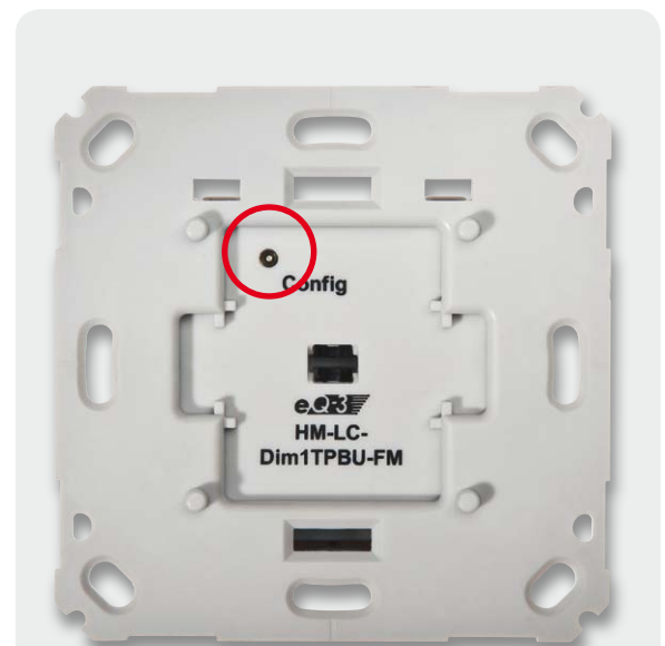
Bild 20: Die Lage des Tastenstößels. Dieser ist auf Leichtgängigkeit zu testen.
