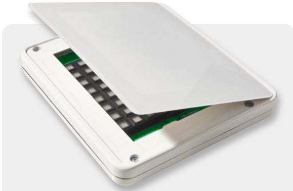
Bild 14: Erst nach dem Gerätetest: Einsetzen und Aufkleben der Frontscheibe. Ganz zuletzt wird die Schutzfolie von der Frontscheibe entfernt.
