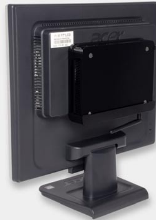
Bild 3: Der Mini-PC kommt mit VESA-Montagerahmen und kann so unsichtbar auf der Rückseite eines Monitors montiert werden. Kartenslots und Schnittstellen bleiben zugänglich.
