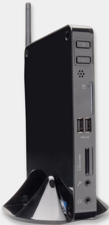
Bild 2: Schick und für den Boxee-Einsatz unter Windows 7 und Linux ausreichend ausgestattet – 1-Liter-PC mit Intel-Atom-510-Prozessor (ELV-Best.-Nr. JG-08 98 36)
