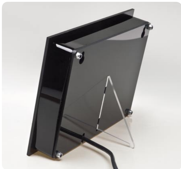
Bild 7: Die fertig montierte Uhr mit Staubschutz und Aufstellbügel
