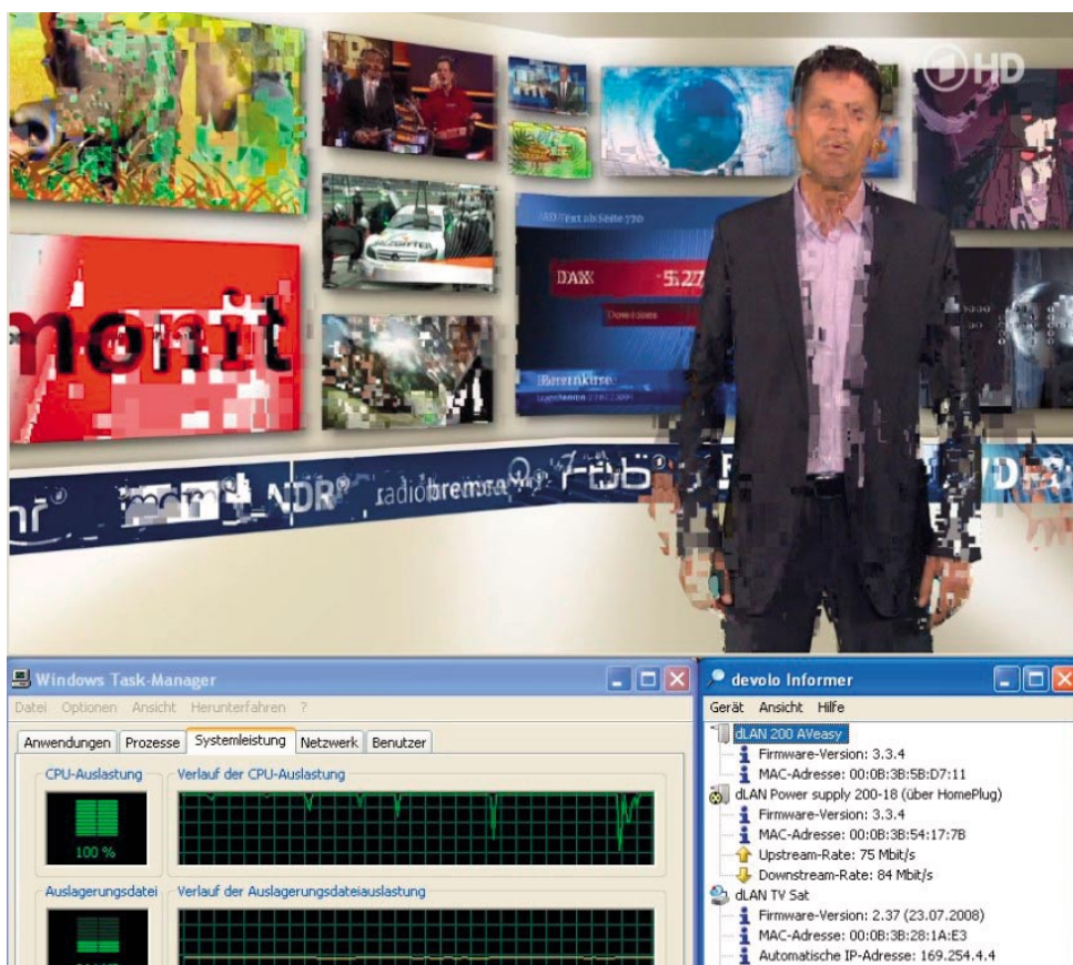
Bild 5: Hier liegt das Problem nicht in einer unzureichenden Übertragungsrates, sondern in der Leistungsfähigkeit des Laptop-Prozessors.
