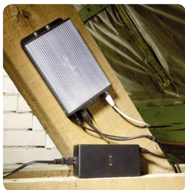
Bild 3: Typischerweise findet der Network Attached Tuner (ins IP-Netz eingebundener Sat-Tuner) seinen Platz in der Nähe des Multischalters. Quelle: devolo
