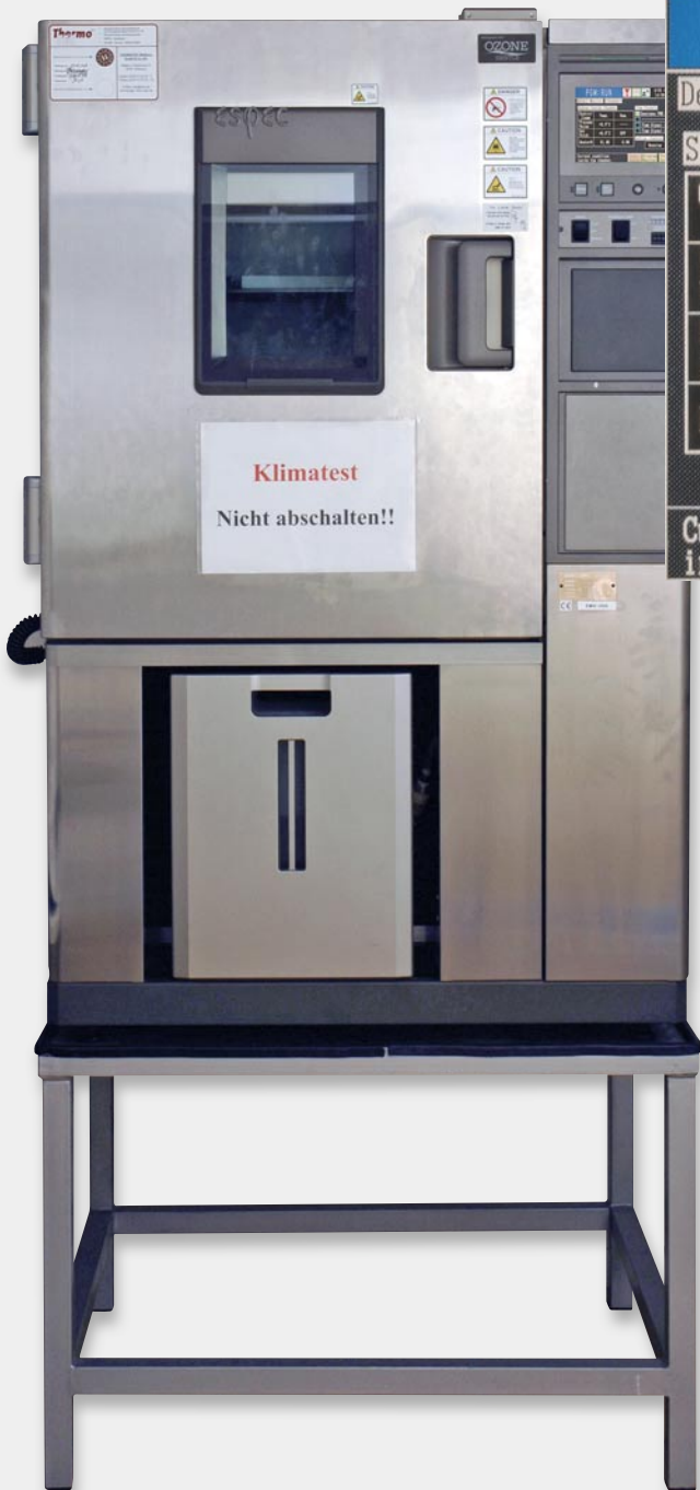
Bild 5: Klimaschrank für Temperaturmessungen ESPEC Typ PL-1KPH
