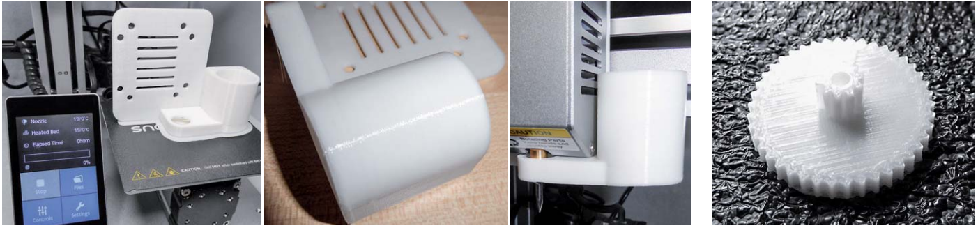
Bild 15: Härteprüfung für den 3D-Druck – die Staubabsaugung hat 11 Stunden Druckzeit benötigt, die erreichte Druckqualität ist sehr gut.
