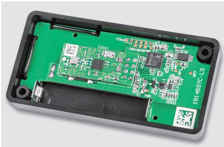
Bild 14: Die in das Gehäuse in der richtigen Lage eingelegte Platine ...
