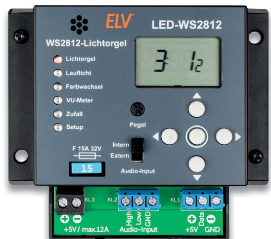
Bild 5: Die Bedien- und Anschlusselemente des LED-WS2812
