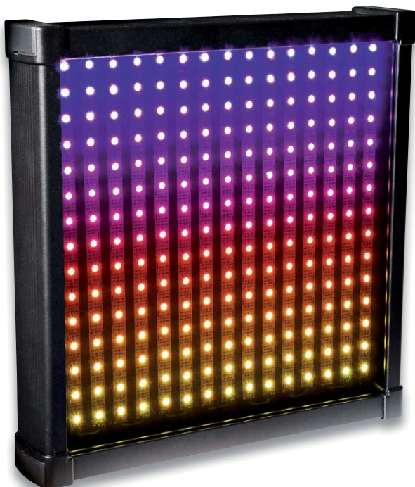
Bild 13: Hier sind LEDs in einer 15x15-Matrix angeordnet.
