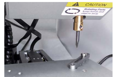
Bild 22: Recht einfach – Fräswerkzeughalterung mit Inbusschraube
