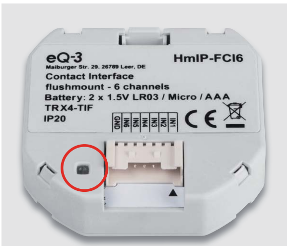
Bild 11: Das komplett montierte Gerät, bereit zum Einsatz. Die Markierung kennzeichnet die Lage des Systemtasters und der Duo-LED.
