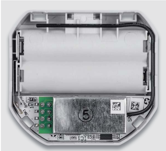
Bild 8: So erfolgen das Einlegen der Platine, das Positionieren der Batteriekontakte und das Führen und Fixieren der Funk-Antenne.
