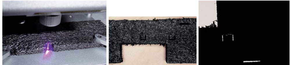
Bild 20: Der Schnittversuch im Moosgummi – wo die Einstelltiefe stimmt, ergeben sich glatte und präzise Schnitte.
