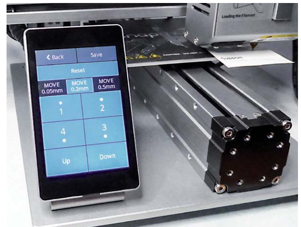
Bild 10: Der Clou bei der Kalibrierung für den 3D-Drucker ist die extrem einfache elektronische Einstellung der Druckdüse auf dem Druckbett.
