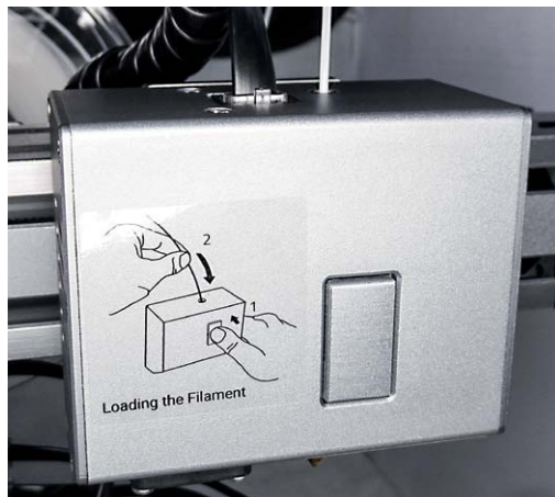
Bild 9: Das Einlegen des Filaments geschieht ganz einfach: vorheizen, Taste drücken und Filament einschieben.
