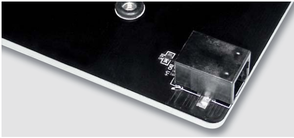
Bild 5: Alle Komponenten, hier die Druckbettheizung, werden mit RJ25/RJ45-Steckern angeschlossen.
