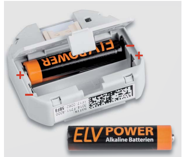
Bild 13: So erfolgt das polrichtige Einlegen der Batterien.
