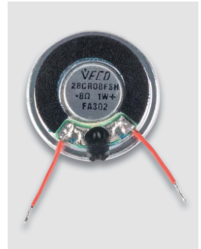
Bild 8: An den Lautsprecher werden die Verbindungsleitungen (3 cm) angelötet.
