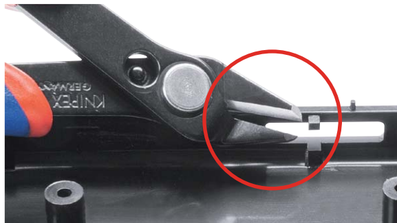
Bild 13: Im Gehäuseunterteil ist vor dem Zusammensetzen der Gehäuseteile ein hervorstehender Gehäusenippel mit dem Seitenschneider zu entfernen.
