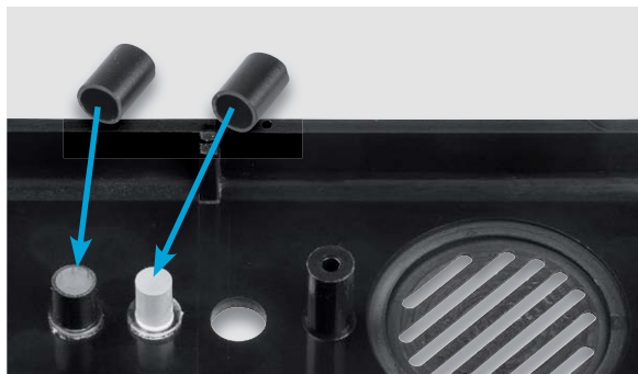
Bild 12: Die zwei zugeschnittenen Stücke PVC-Schlauch werden auf die Lichtleiter geschoben.
