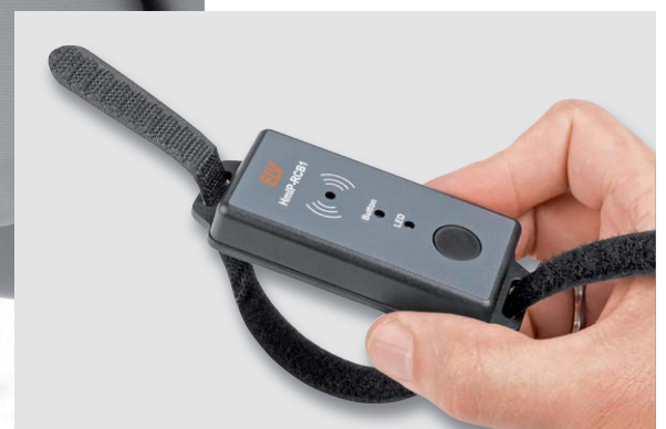
Bild 18: Zur Anbringung im Fahrzeug fädelt man das Klettband – wie hier zu sehen – in die Gehäuselaschen ein.
