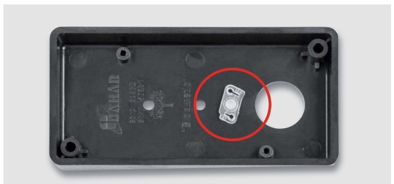
Bild 12: Hier ist der in die Gehäuseoberschale eingelegte Lichtleiter in seiner exakten Position zu sehen. Er ist nach probeweisem Einlegen der Platine mit einem Tropfen Sekundenkleber zu verkleben.
