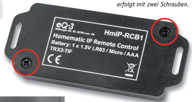
Bild 17: Das Fixieren der Gehäuseunterschale erfolgt mit zwei Schrauben.
