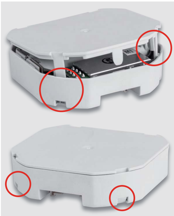
Bild 9: Der Gehäusedeckel ist so einzusetzen, dass die vier Rastnasen sicher in das Gehäuseoberteil einrasten.
