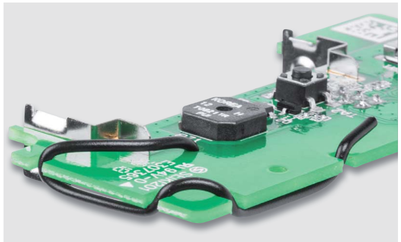
Bild 11: So ist die Antenne in die Auskerbungen der Platine einzulegen und zu fixieren.
