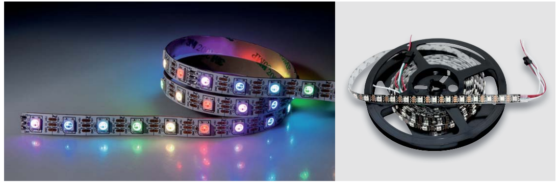
Bild 4: LED-Stripes mit WS2812B, hier als Einzelstreifen und auf der 4-m-Rolle
