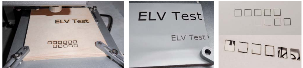
Bild 19: Mit Kalibrierung läuft es – links die sehr saubere und tiefe Gravur in Holz, in der Mitte die Gravur auf beschichtetem Pertinax, unten mit Kalibrierung nach Augenmaß, oben nach elektronischer Kalibrierung. Rechts oben die zutage tretenden Unterschiede bei der Kalibrierung, darunter ausgeschnittenes Balsa.
