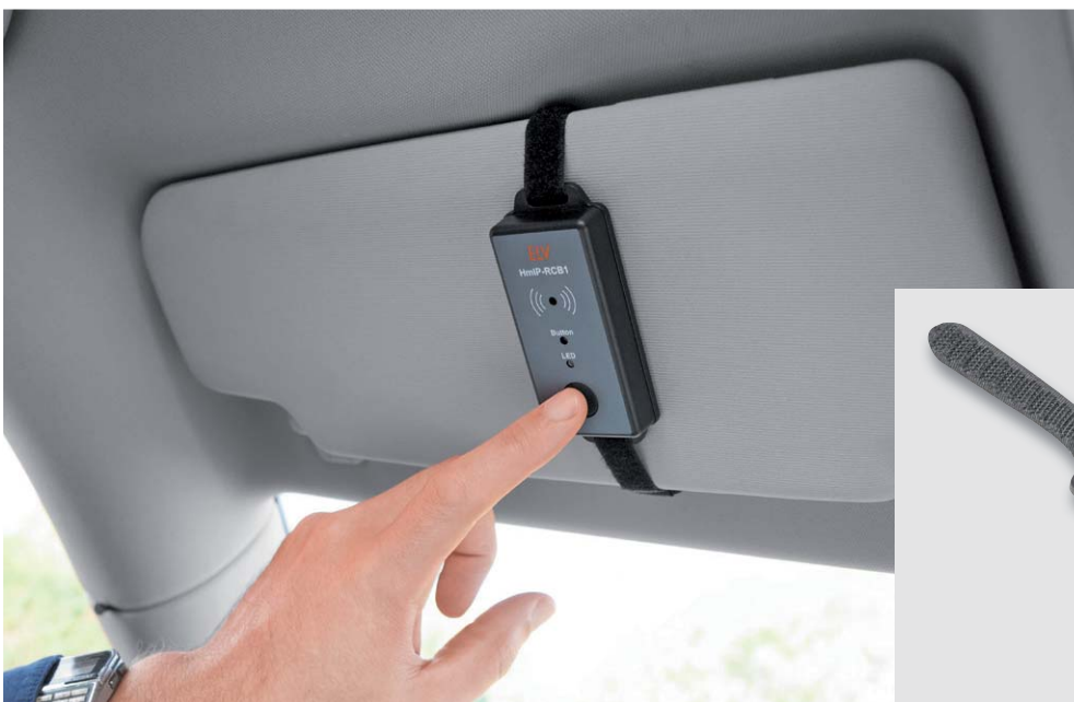
Bild 18: Zur Anbringung im Fahrzeug fädelt man das Klettband – wie hier zu sehen – in die Gehäuselaschen ein.
