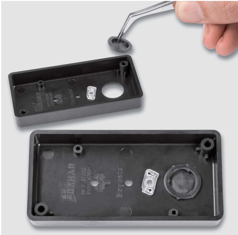
Bild 13: Die Tasterkappe wird eingelegt. Unten ist sie bereits eingesetzt zu sehen.
