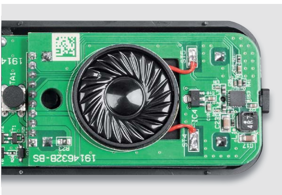
Bild 9: So wird der Lautsprecher angeschlossen und in die Batterieplatine eingesetzt.
