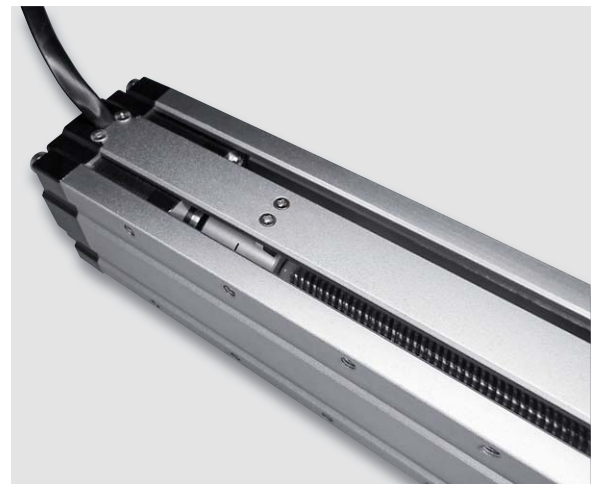
Bild 3: Sehr clevere Konstruktion: Schrittmotor, Spindel und Endschalter sind in den robusten Aluminiumträgern untergebracht.
