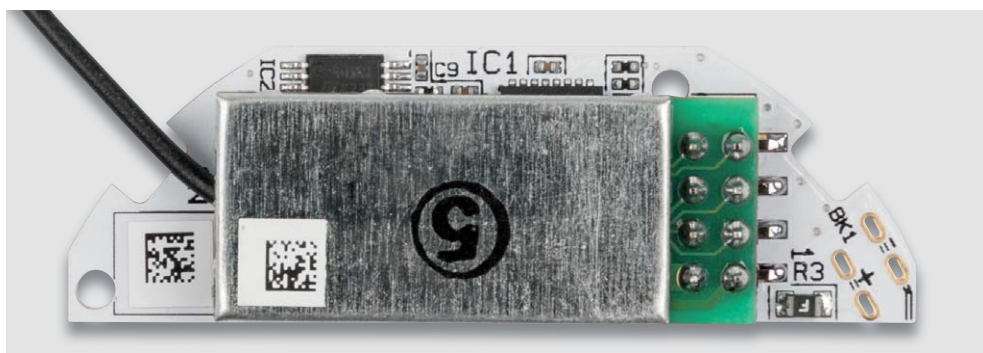
Bild 4: Das bestückte und verlötete Funkmodul von oben gesehen
