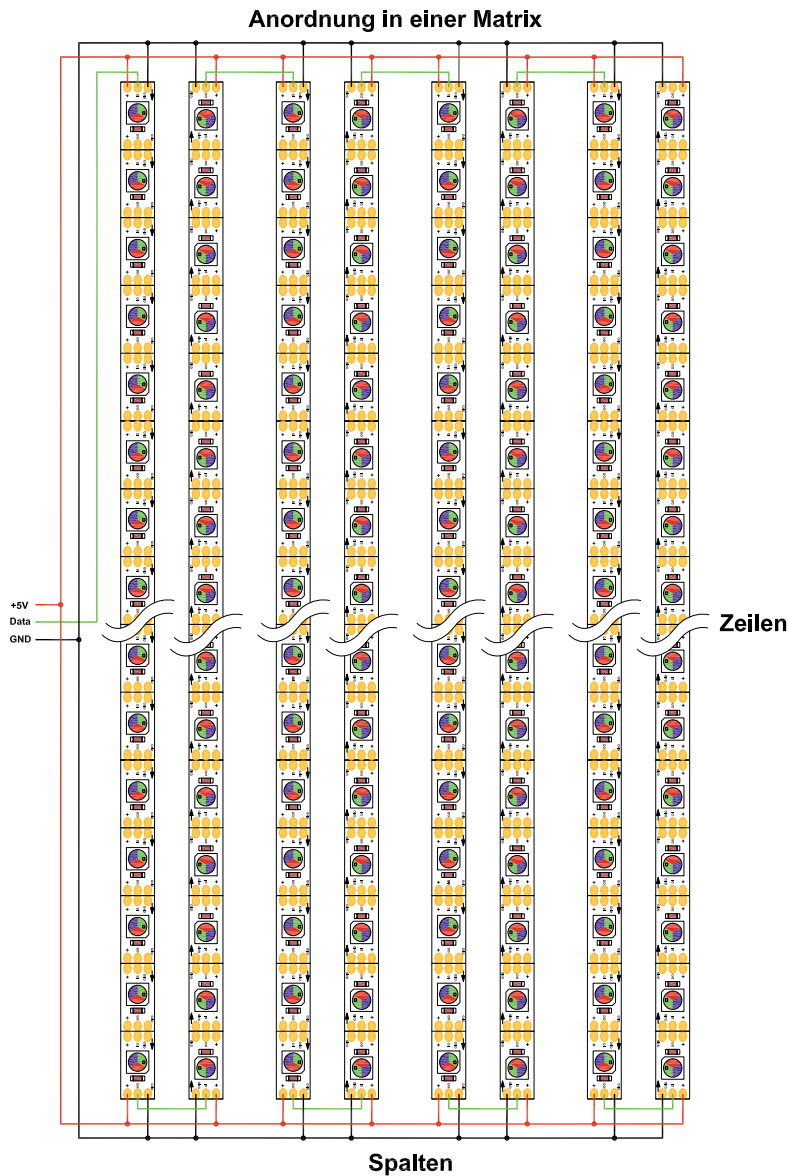
Bild 12: So erfolgt die Anordnung der LED-Stripes in einer Matrix.
