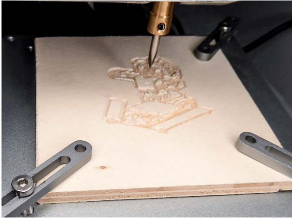
Bild 25: Bei weichem Holz reißen die Kanten auf, hier wäre mehr Drehzahl wünschenswert.
