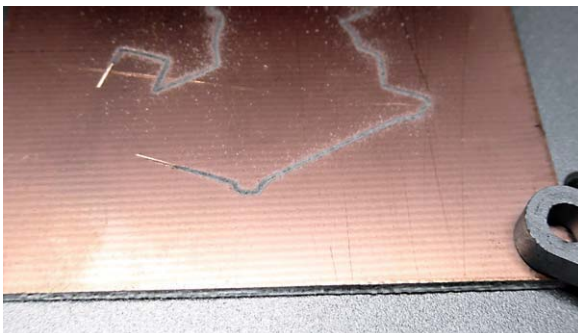
Bild 27: Platinenfräsen – hier haben wir in einem Arbeitsgang mit verschiedenen Tiefen gefräst, bei richtiger Einstellung ist das Herstellen nicht zu filigraner Platinenlayouts möglich.
