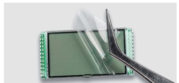
Bild 11: So erfolgt das Abziehen der Display-Schutzfolie.
