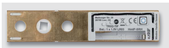
Bild 10: So wird die Antenne exakt in das Gehäuse eingelegt.
