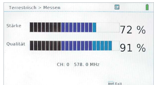
Bild 23: In der Zoom-Einstellung werden die Balken für Stärke und Qualität des eingestellten Kanals zur leichteren Ablesbarkeit auf Bildschirmgröße vergrößert.
