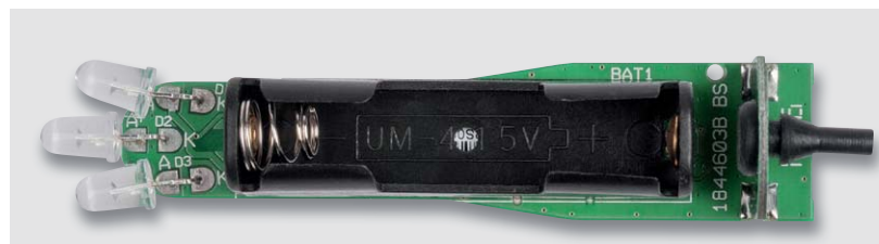
Bild 4: So erfolgt das Einlöten des Batteriehalters.
