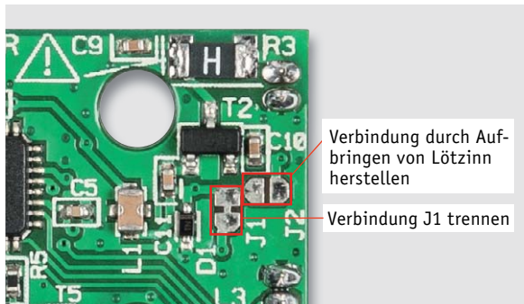
Bild 8: Die Maßnahmen bei Verwendung einer Betriebsspannung von 2,7 bis 3,3 V, dazu unbedingt die Ausführungen im Text beachten!
