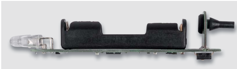
Bild 6: Hier ist der eingesetzte Gummi-Gehäusefuß auf der senkrecht eingelöteten zweiten Platine zu sehen.
