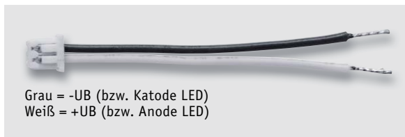
Bild 7: Die Polung für die Spannungsversorgung ist farblich gekennzeichnet.
