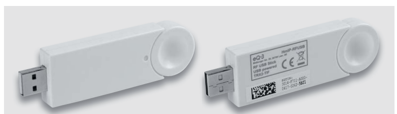
Bild 7: Nach dem Zusammensetzen beider Gehäuseteile und Verrasten der Gehäuseersten (siehe Bild 5) ist das Gerät betriebsfertig.
