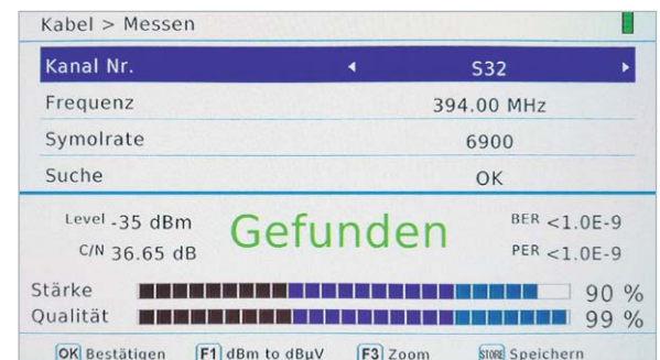
Bild 33: Der gewählte Kanal ist mit einem Bouquetsignal belegt, wie der grüne Schriftzug „Gefunden“ aussagt.
