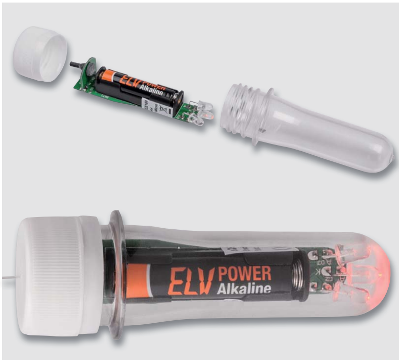
Bild 7: Nach dem Einlegen der Batterie erfolgt der Selbsttest des Gerätes.
