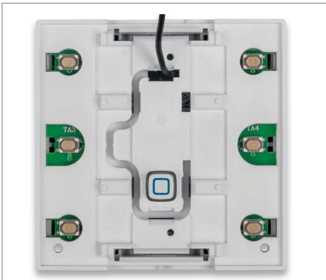
Bild 6: Das aufgesteckte Gehäuseoberteil mit dem durchgeführten Antennendraht und dem bereits ab Werk vormontierten Tasterstößel der Systemtaste
