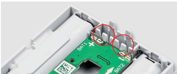
Bild 15: Die Platinenhalterungen müssen einrasten, sodass die Platine fest sitzt.
