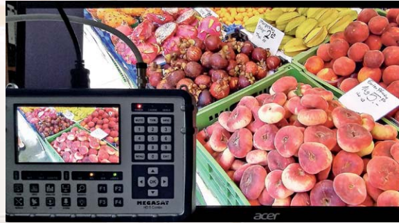
Bild 39: Über die HDMI-Buchse „DV OUT“ liefert ein externer Full-HD-Bildschirm mit Lautsprechern ein brillantes Bild und eine den Lautsprechern entsprechende Tonqualität.
