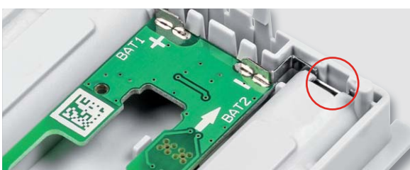
Bild 16: Auch die Batteriekontakte müssen unter den zugehörigen Gehäusenasen einrasten.
