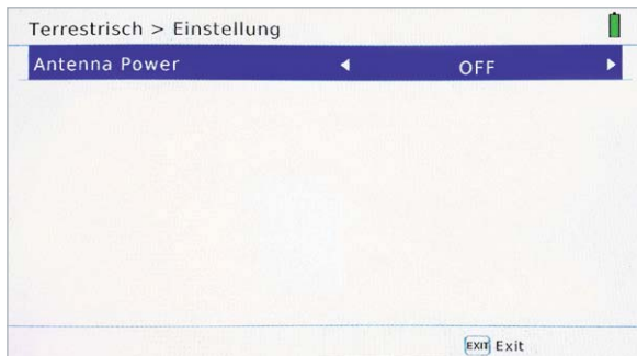
Bild 27: Ist in der terrestrischen Antennenzuleitung ein phantomgespeister Antennenverstärker eingeschleift, lässt sich hier seine Versorgungsspannung von 5 oder 12 VDC einstellen.
