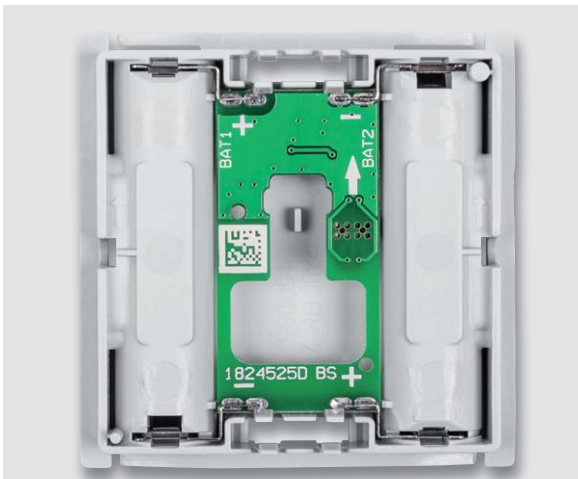
Bild 14: Die in das Gehäuse eingesetzte Batterieplatte
