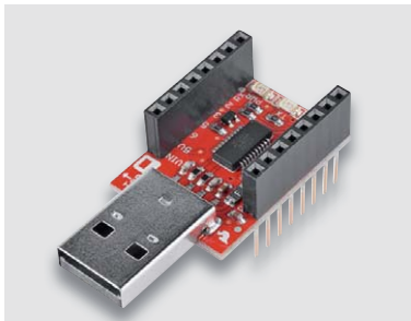
Bild 11: Über den speziellen Programmieradapter ist der MicroView bequem per Arduino-IDE zu programmieren.
