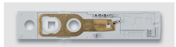
Bild 5: Die exakt eingelegte Metallgabel für die Tasterbetätigung
