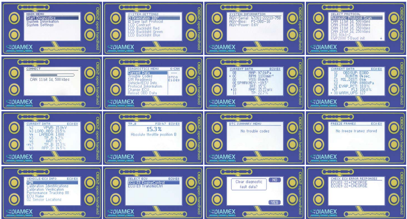
Bild 19: Der Prüfumfang des Diamex-PI-OBd-HAT ist sehr umfangreich, auch das Fehlerlöschen fehlt nicht
