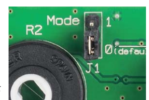
Bild 2: Der Betriebsmode wird mit dem Jumper (Mode) festgelegt.
