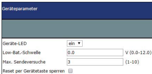
Bild 8: Bei Bedarf kann die Geräte-LED zur Signalisierung zugeschaltet werden. Hier ist auch das Aktivieren der Low-Bat-Meldung nach Eingabe eines Schwellwerts möglich.
