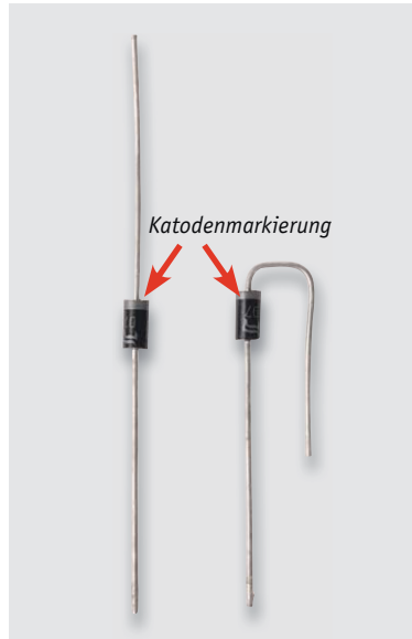
Bild 6: Die Freilaufdiode ist polrichtig zu bestücken.
