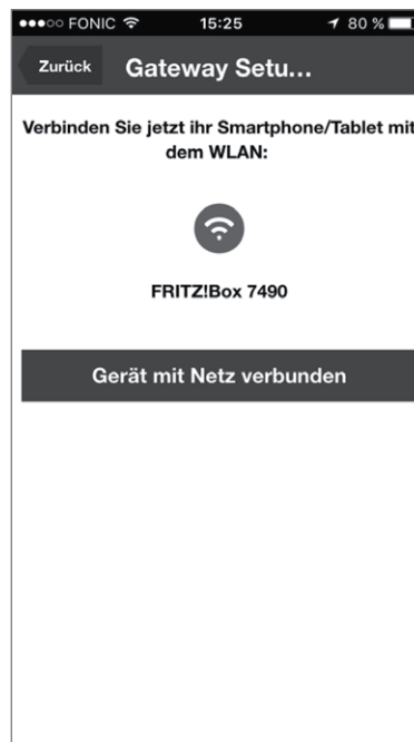
Bild 11: Im Normalfall verbindet sich das Smartphone nun wieder automatisch mit dem WLAN des Routers. Geprüft werden kann dieses bei Bedarf in den Smartphone-WLAN-Einstellungen.
