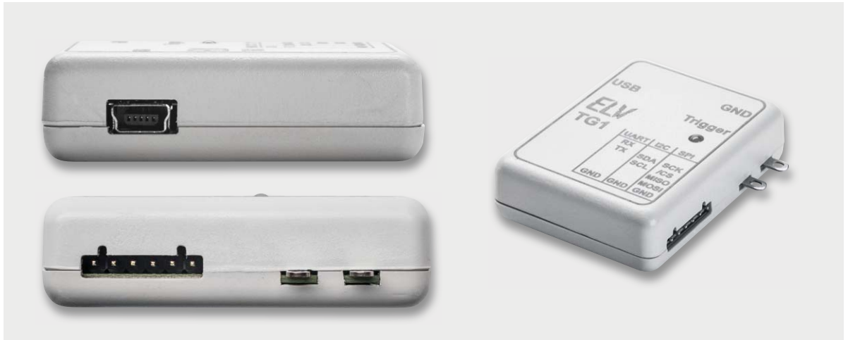
Bild 11: Das fertig montierte und betriebsbereite Gerät. Alle Anschlüsse und Buchsen müssen so im Gehäuse sitzen wie hier gezeigt.
