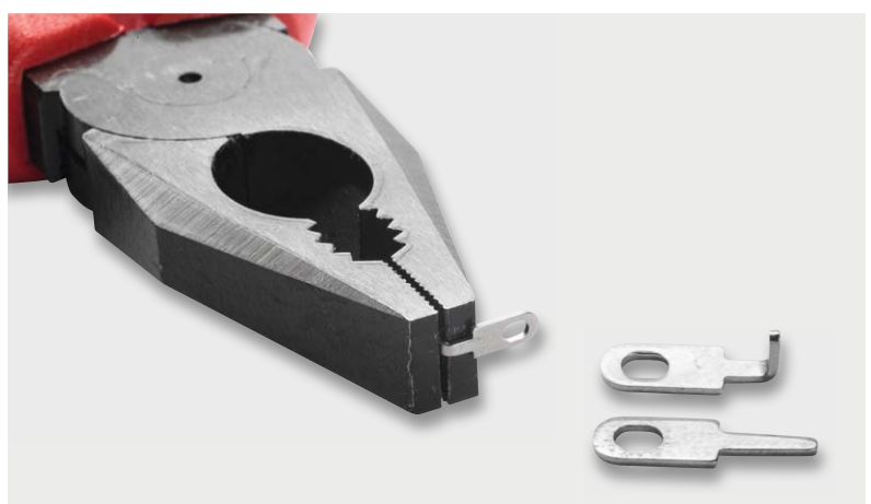
Bild 7: So erfolgt das Biegen der Lötösen.
