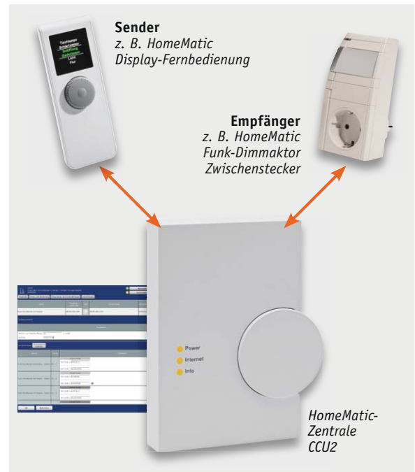
Bild 2: Schematische Darstellung der Funkkommunikation bei einem „Zentralenprogramm“
