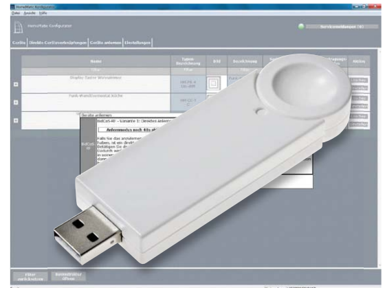
Bild 11: Zur Konfiguration der HomeMatic-Module wurde der USB-Konfigurationsstick des HomeMatic-Systems eingesetzt.
