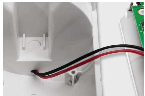
Bild 13: Danach führt man das andere Kabelende durch das Gehäuseloch des Gerätegehäuses.
