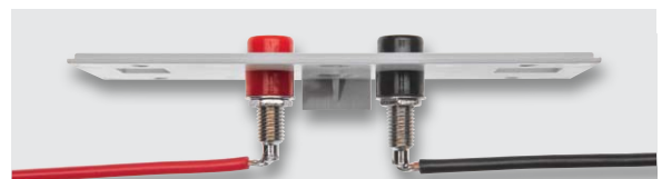
Bild 13: Vorbereitung der Stirnplatte
