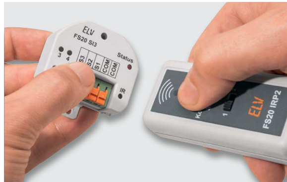
Bild 10: So erfolgt das Programmieren des Gerätes über den Infrarot-Programmer FS20 IRP2.
