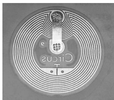
Bild 3: Typischer passiver NFC-Tag in Form eines Stickers (Hama-NFC-Sticker for Smartphone, 00015684) mit einer Kantenlänge von 35 mm
