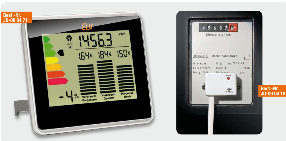
Bild 5: Zeigt Differenzen, z. B. zum Vorjahr, an – Energiemonitor mit übersichtlicher grafischer Auswertung.
