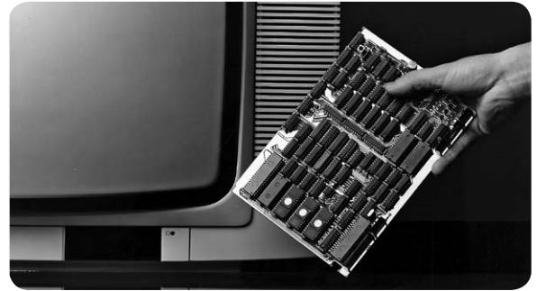
Bild 18: Lötete das BTX-Zeitalter mit ein – der erste integrierte BTX-Decoder für den Einbau in ein Fernsehgerät erschien 1983.
