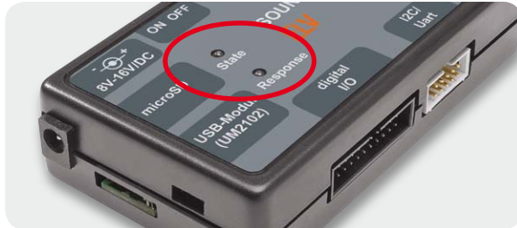
Bild 9: Beim Aufsetzen des Gehäuseoberteils ist zu beachten, dass die LEDs in den zugehörigen Löchern stehen.
