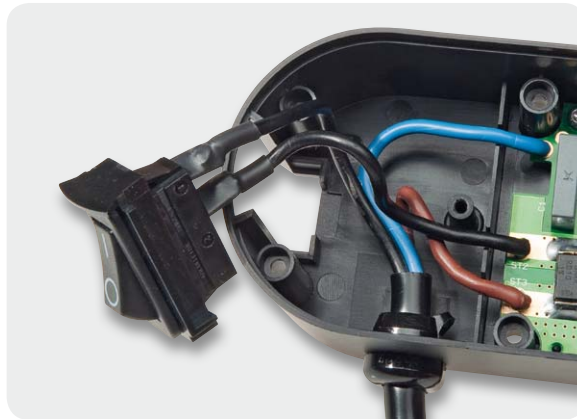
Bild 27: Zugentlastung des Netzkabels mit einer Einpress-Zugentlastung
