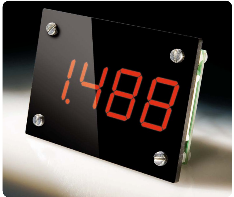
Bild 3: Fertig aufgebautes Panelmeter PM35 mit optionaler Frontscheibe und Farbfilterfolie
