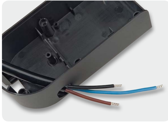
Bild 25: Durchfädeln des Netzkabels von innen durch die zugehörige Gehäuseöffnung
