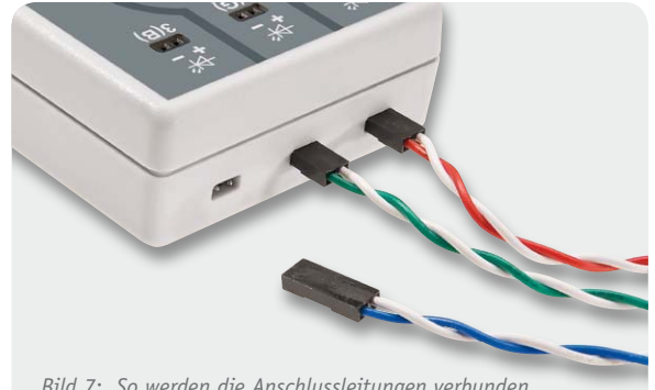
Bild 7: So werden die Anschlussleitungen verbunden.
