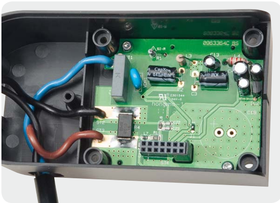
Bild 26: Einsetzen und Verschrauben der Netzteilplatine
