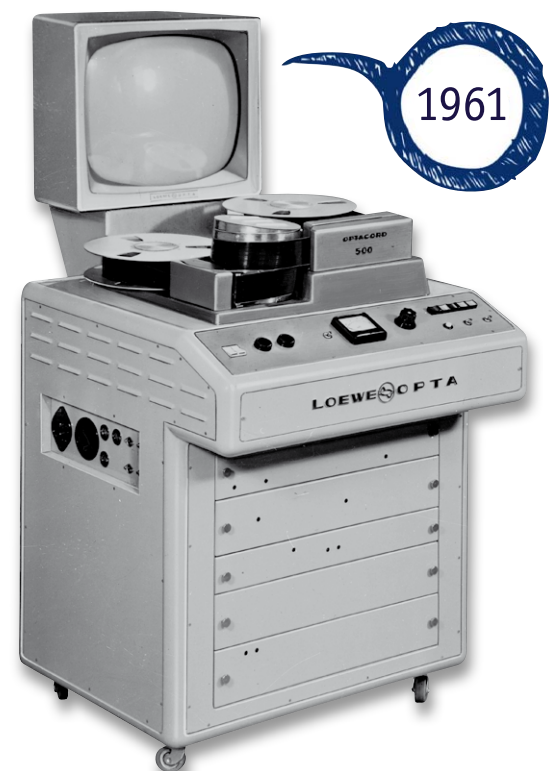
Bild 13: Wieder bahnbrechende Technik – der erste Heimvideorecorder mit Schrägspuraufzeichnung, der „Optacord 500“ von 1961
