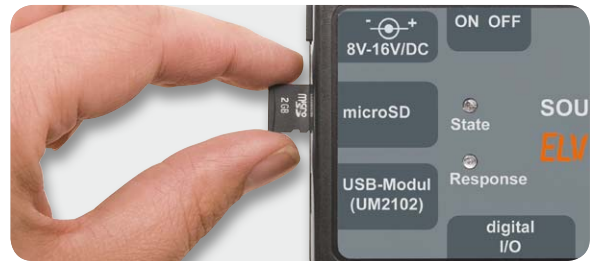
Bild 10: Das Einsetzen der microSD-Karte in den Kartenschacht
