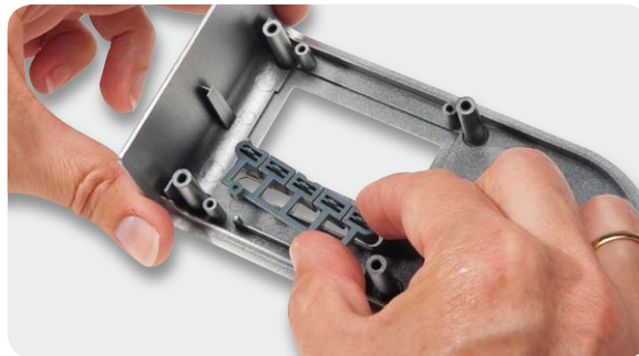
Bild 16: Einsetzen der Tasteneinheit im Gehäuseoberteil
