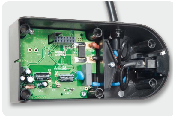
Bild 29: Einsetzen des Netzschalters in die Gehäuseführung
