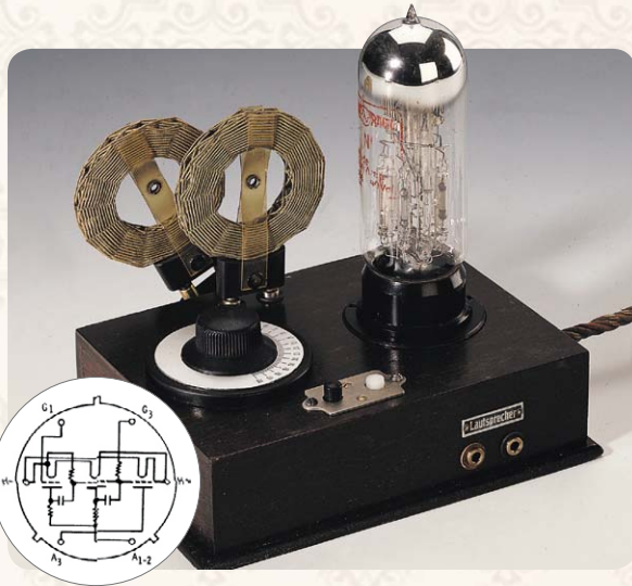
Bild 4: Verkaufsschlag mit über 1 Mio. Exemplaren, der „0E333“ mit der legendären Dreifachröhre 3NF kostete 39,50 RM.
