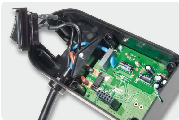
Bild 28: Fixieren der Netz-Leitungen an der Platine mit einem Kunststoffhalter
