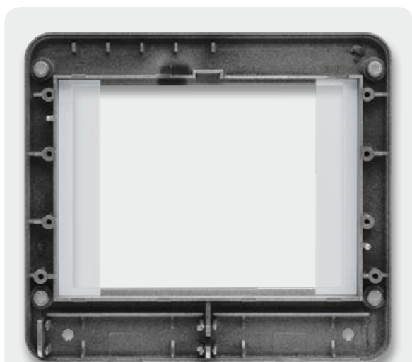
Bild 8: So erfolgt das Einlegen der beiden Diffusorfolien links und rechts.
