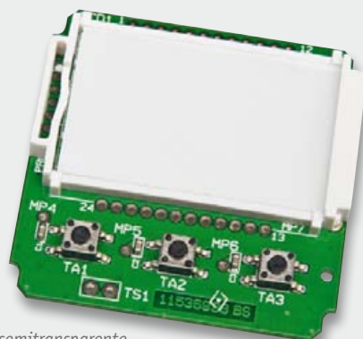
Bild 20: Die semitransparente Diffusorfolie wird auf die Lichtverteilerplatte gelegt.
