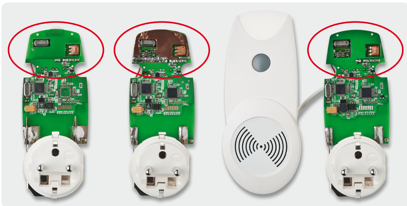
Bild 9: Hier sind die Entwicklungsstadien des Prototyps deutlich zu sehen: links der ursprüngliche Prototyp, in der Mitte die im Text erläuterte Kupferfolien-Auflage, rechts dann das endgültige Layout.
