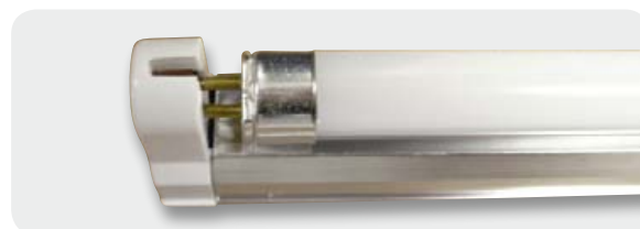
Bild 7: Unzureichende Luft- und Kriechstrecken im Bereich der Lampenfassungen
