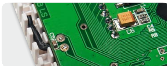
Bild 30: Beim Zusammenbau der Displayeinheit ist auf die korrekte Positionierung des Temperatursensors zu achten.
