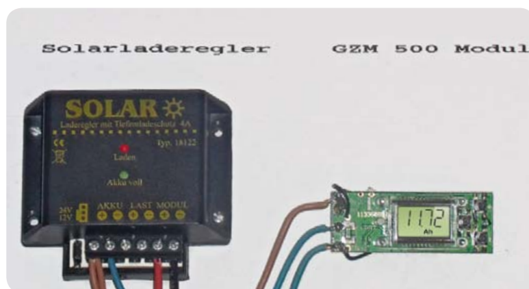
Bild 2: Der Musteraufbau mit dem verwendeten Solarregler und dem GZM 500
