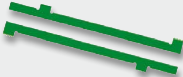
Bild 5: Die beiden herausgebrochenen Stege sind ggf. nachzubearbeiten (Bruchkante glätten/entgraten).
