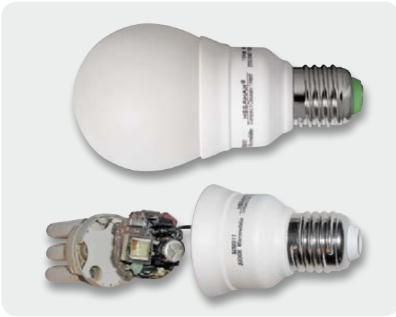
Bild 10: Die Kompakt-Energiesparlampe ist eine Leuchtstofflampe mit integriertem Vorschaltgerät.
