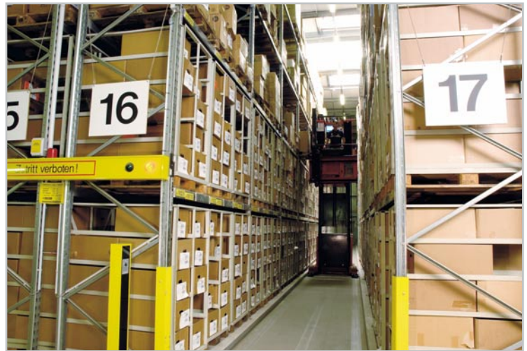
Bild 3: Hier weiß nur der Computer, wo was liegt – das Hochregallager, aus dem die Ware automatisch zur Kommissionierung abgerufen wird.
