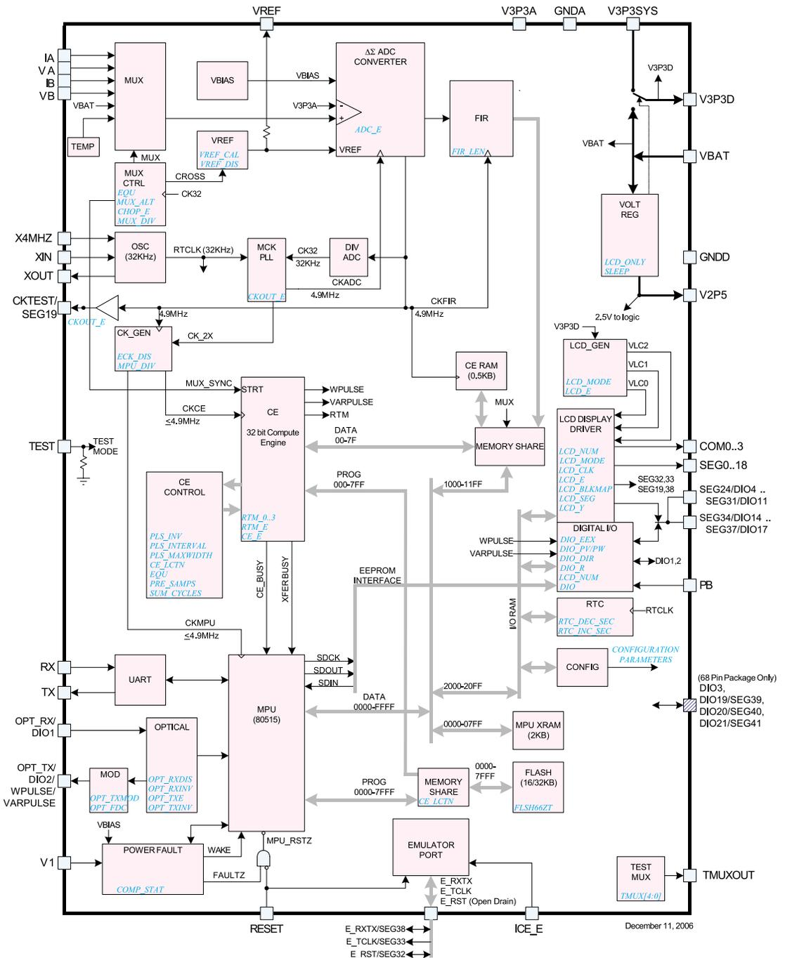
Bild 2: Interne Struktur des Energie-Messchips
