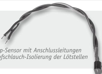
Bild 19: Temp-Sensor mit Anschlussleitungen und Schrumpfschlauch-Isolierung der Lötstellen
