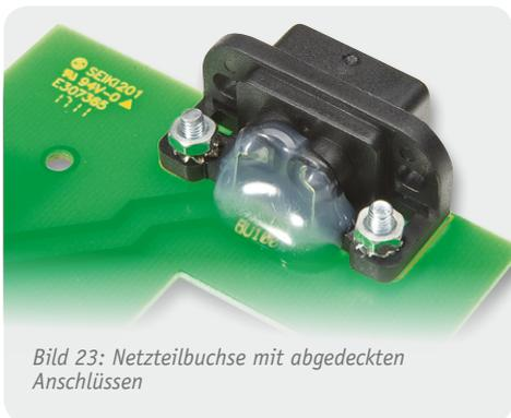
Bild 23: Netzteilbuchse mit abgedeckten Anschlüssen
