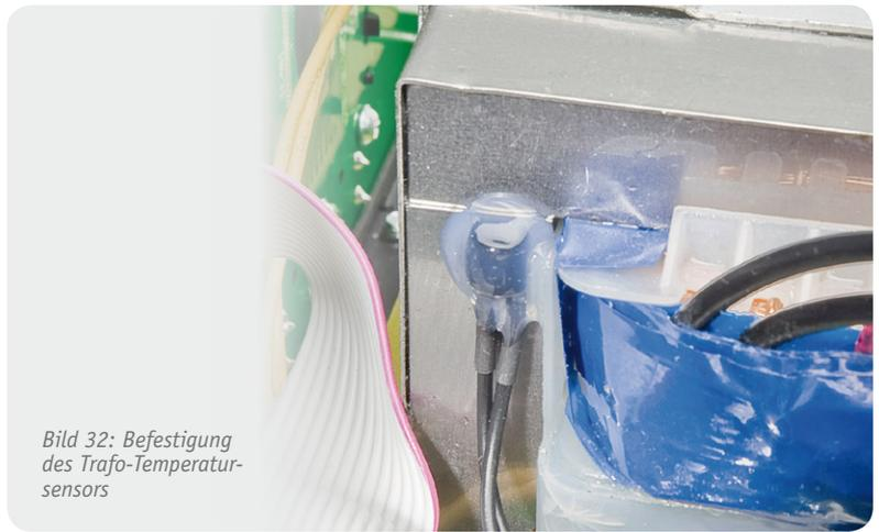
Bild 32: Befestigung des Trafo-Temperatur-sensors
