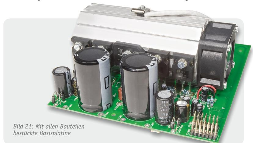
Bild 21: Mit allen Bauteilen bestückte Basisplatine
