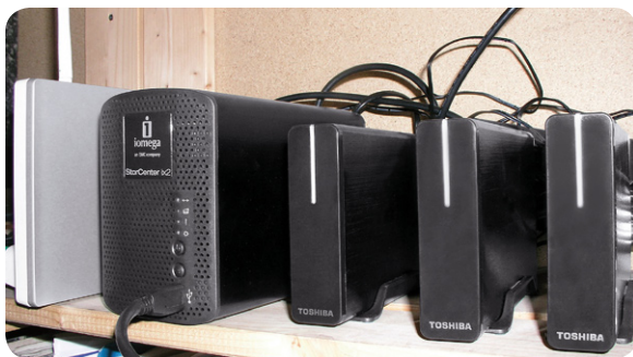
Bild 9: Das Iomega StorCenter ix2 stellt mit seinen beiden internen Festplatten 1 TByte gespiegelte und über seine drei USB-Ports, an denen je eine 2-TByte-Festplatte angeschlossen ist, 6 TByte ungespiegelte Kapazität zur Verfügung. Das sollte für Daten-Backups und die Multimedia-Bibliothek fürs Erste ausreichen. Links ist das DSL-Modem/Router mit WLAN-Access-Point und 100-Mbit/s-4-Port-IP-Switch (Speedport W700V) zu sehen.
