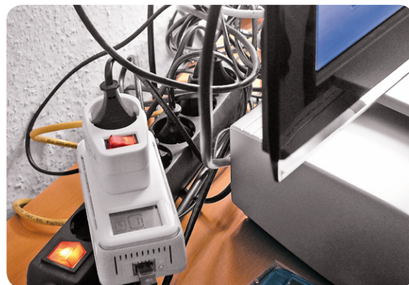
Bild 4: Wenn in der Nähe der Antennensteckdose kein Netzwerkanschluss verfügbar ist (und dies ist der Regelfall), kann PowerLAN-Technik weiterhelfen und das TV-Gerät in das häusliche LAN integrieren.
