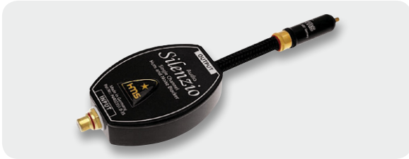
Bild 15: Das Silenzio Sat von HMS unterbricht Erdschleifen über den Kabelmantel, dämpft hochfrequente Ausgleichsströme und ist dennoch DiSEqC-tauglich.
