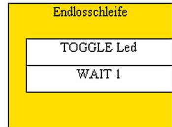
Bild 6: DO – LOOP (Endlosschleife)
