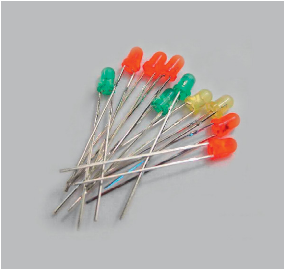
Bild 9: Geeignete LEDs für Mikrocontroller-Schaltungen
